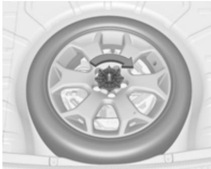
Poškodovano kolo polnih dimenzijs morate spraviti z navzgor obrnjeno zunanjo stranjo v vdolbino za rezervno kolo in ga pritrditi s krilno matico.
