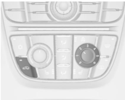
Za vklop kroženja zraka pritisnite ☂. LED dioda v gumbu sveti in s tem označuje vključeno stanje.
