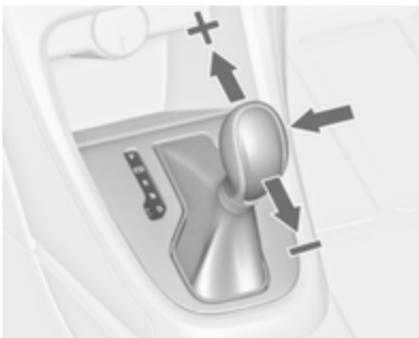
Izbirno ročico premaknite iz položaja D proti levi, da izberete ročni način M.
