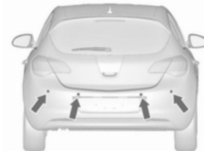
Sistem vsebuje štiri senzorje, vgrajene v zadnjem odbijaču.
