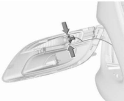
3. Držalo žarnice sprostite z ohišja žarometa s pritiskom na obe pritrdilni zaponki.
