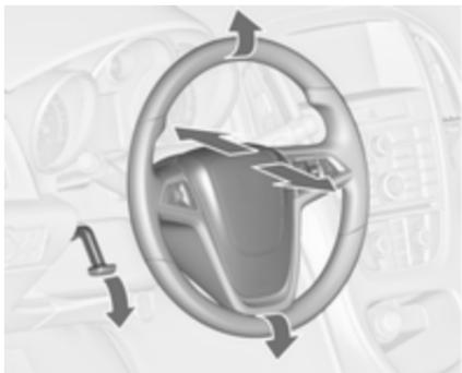
Sprostite ročico, nastavite volan, zataknite ročico v zavarovan položaj. Volana ne nastavljajte pri premikajočem vozilu in/ali blokiranem volanu.
