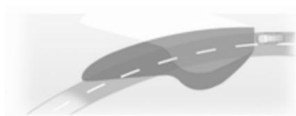
Zglobi žarometov se obračajo v odvisnosti od zavoja volana in hitrosti vozila za boljšo osvetlitev zavojev. Kontrolna lučka  $\Rightarrow$  91.
