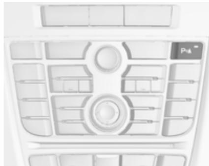
Sistem se samodejno izključi, ko pretaknete iz vzvratne prestave. Za ponovno vključitev sistema prestavite v vzvratno prestavo. Za ročni izklop funkcije pritisnite **Pak**. Ko se sistem izključi, lučka LED v stikalu ugasne.
