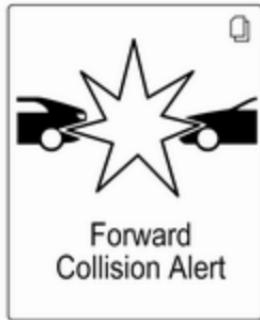
Če sistem zazna vozilo v smeri vožnje pred vami, se na instrumentni plošči prižge zelena kontrolna lučka za spredaj vožeče vozilo . Če se razdalja od spredaj vožečega vozila preveč zmanjša ali če se prehitro približujete drugemu vozilu in grozi neposredna nevarnost trka, se na voznikovem informacijskem zaslonu pojavi simbol za opozorilo pred trkom. Hkrati se oglesi tudi zvočni signal. Pritisnite zavorno stopalko, če to od vas zahteva situacija.
