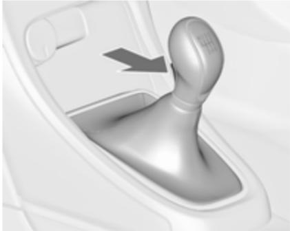
Za vklop vzvratne prestave, ko vozilo miruje, pritisnite pedal sklopke, pritisnite gumb na prestavni ročici in prestavite.
