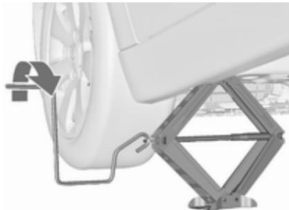
Namestite ročico dvigalke, dvigalko pravilno poravnajte in z vrtenjem ročice dvignite vozilo s tal.
