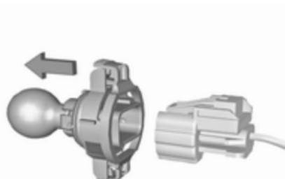
4. Ločite priključni vtič od držala žarnice s pritiskom na vpenjalni ježiček.
