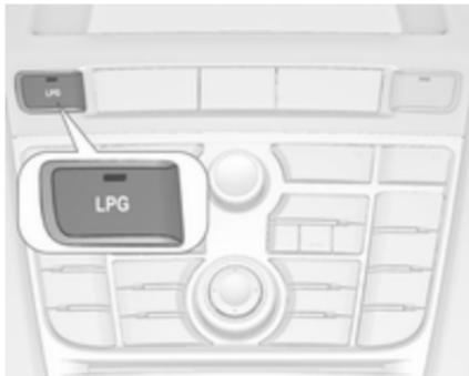
Po pritisku LPG se preklop med bencinskim in plinskim pogonom izvrši, takoj ko so izpolnjeni zahtevani pogoji (temperatura hladilne tekočine, temperatura plina in minimalno število vrtljajev motorja). Ti pogoji so običajno izpolnjeni po približno 60 sekundah (odvisno od zunane temperature) in prvem odločnejšem pritisku na pedal za plin. Stanje LED lučk opozarja na trenutni način delovanja.
