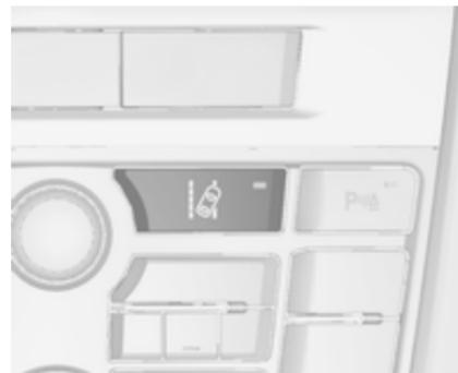
Sistem za opozorilo o nemerni menjavi vozneg pasu se aktivira s pritiskom . LED v stikalu označuje, da je sistem vključen. Kadar kontrolna lučka na instrumentni plošči sveti zeleno, je sistem pripravljen na delovanje.
