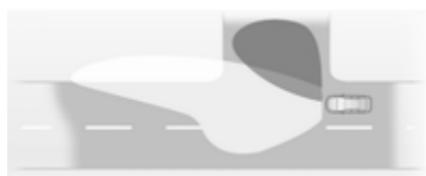
V ostrih zavojih ali pri zavijanju s ceste - odvisno od kota volana in/ali vklopa smernikov - se vklop dodaten žaromet, ki osvetli cesto v pravem kotu v želeni smeri vožnje. Funkcija deluje le pod hitrostjo 40 km/h.
