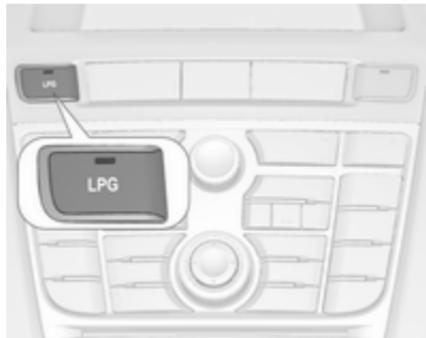
Pritisnite LPG za preklapljanje med pogonom na bencin in pogonom na utekočinjen naftni plin. Stanje LED-lučk — opozarja na trenutni način delovanja.
