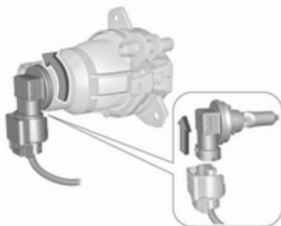
4. Držalo žarnice obrnite v levo in ga izvlecite iz ohišja žarometa.
