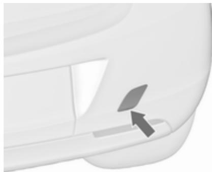
Vstavite izvijač v spodnjo režo pokrova. Odppnite pokrov s previdnim pomikom izvijača navzdol.
