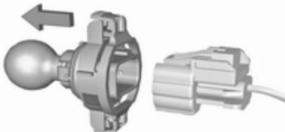
4. Ločite priključni vtič od držala žarnice s pritiskom na vpenjalni jeziček.
