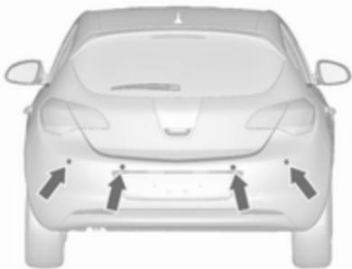
Sistem vsebuje štiri senzorje, vgrajene v zadnjem odbijaču.
