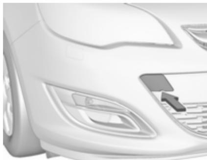
Vставite izvijač v spodnji del pokrova. Odpnite pokrov s previdnim pomikom izvijača navzdol.
