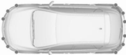
Napredni parkirni pomočnik vodi voznika na parkirno mesto z navodili na voznikovem informacijskem zaslonu in z zvočnim signaliziranjem. Voznik mora sam upravljati s plinom, zavorami in menjalnikom.
