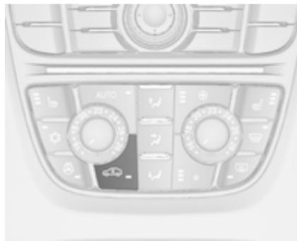
Za vklop kroženja zraka pritisnite
