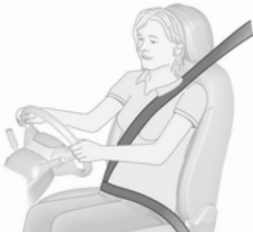
Izvlecite varnostni pas in ga zataknite v zaklep. Bočni del pasu ne sme biti zvit na nobenem delu in se mora tesno prilegati k telesu. Naslonjalo naj ne bo nagnjeno preveč nazaj (priporočen kot nagiba: največ 25°). Pas odpnete s pritiskom na rdečo tipko na zaklepu.
