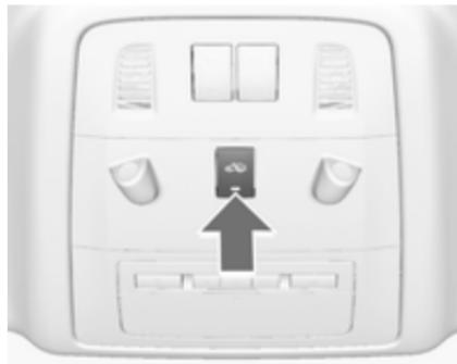
Nadziranje potniškega prostora in nagiba vozila izključite, če pustite v vozilu kakšno žival, ker se utegne sprožiti alarm zaradi gibanja v vozilu, ultrazvočnih valov in nagibanja vozila pri prevozu. Nadziranje potniškega prostora in nagiba vozila prav tako izključite pri prevozu na ladji ali vlaku.
