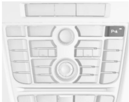
Parkirni pomočnik spredaj-zadaj je opremljen z **P<sub>W</sub>A**. Če je vozilo dodatno opremljeno z naprednim parkirnim pomočnikom (glejte ločen opis v nadaljevanju), je sistem mogoče upravljati z **B<sub>W</sub>A**. Oba sistema upravlja s pritiskom **B<sub>W</sub>A**.
