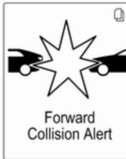
Če sistem zazna vozilo v smeri vožnje pred vami, se na instrumentni plošči prižge zelena kontrolna lučka za spredaj vozeče vozilo . Če se razdalja od spredaj vozečega vozila preveč zmanjša ali če se prehitro približujete drugemu vozilu in grozi neposredna nevarnost trka, se na voznikovem informacijskem zaslolu pojavi simbol za opozorilo pred trkom. Hkrati se oglasi tudi zvočni signal. Pritisnite zavorno stopalko, če to od vas zahteva situacija.
