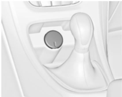
12-voltna električna vtičnica se nahaja v sprednji konzoli.
