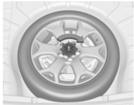
Poškodovano kolo polnih dimenij morate spraviti z navzgor obrnjeno zunanjim stranom v vdolbino za rezervno kolo in ga pritrdirti s krilnico.
