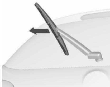
Dvignite brisalec. Iztaknite metlico brisalca, kot je prikazano na zgornji sliki, in jo odstranite.
