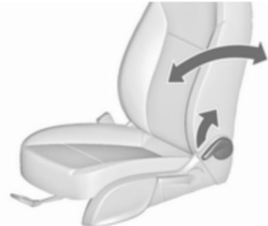
Potegnite vzvod, nastavite naklon in sprostite vzvod. Sedež naj se primerno zaskoči.
