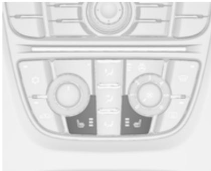
Nastavite želeno stopnjo ogrevanja s pritiskom na enkrat ali večkrat. Indikator v stiku označuje nastavitev.
