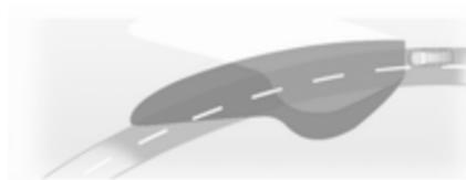
Zglobi žarometov se obračajo v odvisnosti od zavoja volana in hitrosti vozila za boljšo osvetlitev zavojev.
