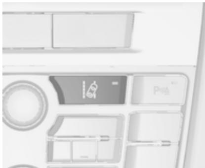
Sistem za opozorilo o nenamernej menjavi voznega pasu se aktivira s pritiskom . LED v stikalju označuje, da je sistem vključen. Kadar kontrolna lučka na instrumentni plošči sveti zeleno, je sistem pripravljen na delovanje.
