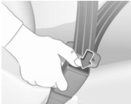
Pas odpnete s pritiskom na rdeč gumb na zaklepnu.
