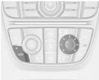
Za vklop kroženja zraka pritisnite
