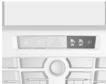
Če kontrolna lučka **ON** po vključitvi kontakta vziga sveti pribl. 60 sekund, je sistem varnostnih blazin na sovoznikovi strani aktivен in se bo v primeru trka sprožil.
