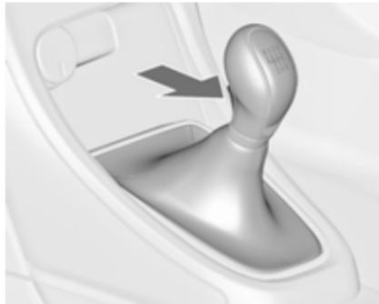
Za vklop vzvratne prestave, ko vozilo miruje, pritisnite pedal sklopke, pritisnite gumb na prestavnih ročicah in prestavite.
