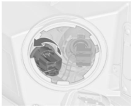
2. Obrnite držalo žarnice na levo, da se sprosti, in ga odstranite iz ohišja žarometa.
