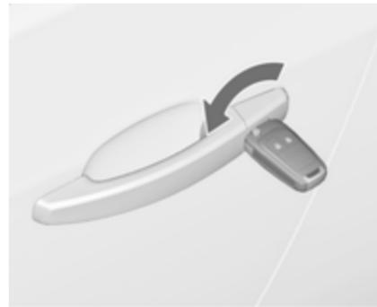
Odklenite voznikova vrata z obratom ključa v ključavnici. Vključite kontakt in pritisnite stikalo
