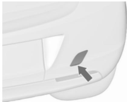
Okoli konice ploskega izvijača ovijte krpo, da preprečite poškodbo laka.
