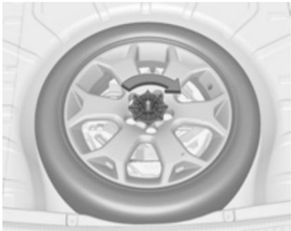
Poškodovano kolo polnih dimenzijs morate spraviti z navzgor obrnjeno zunanjemu stranju v vdolbino za rezervno kolo in ga pritrditi s krilno matico.
