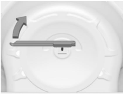
2. Samo 4-vratna limuzina z zasilnim rezervnim kolesom: s šestrobnim nastavkom ključa za kolesa zamenjajte dolgi vijak s kratkim vijakom.
