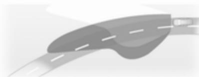
Zgubi žarometov se obračajo v odvisnosti od zavoja volana in hitrosti vozila za boljšo osvetlitev zavojev.
