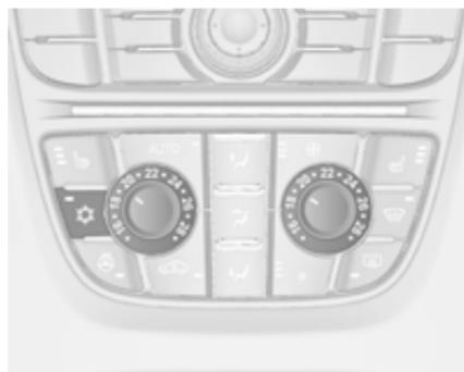
Za vklop hlajenja pritisnite ☀. LED dioda v gumu sveti in s tem označuje vključeno stanje. Hlajenje deluje samo, kadar teče motor in je vključen ventilator sistema za ogrevanje, prezračevanje, hlajenje.
