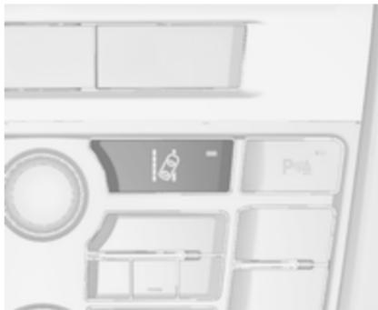
Sistem za opozorilo o nenamernej menjavi voznega pasu se aktivira s pritiskom . LED v stikalcu označuje, da je sistem vključen. Kadar kontrolna lučka na instrumentni plošči sveti zeleno, je sistem pripravljen na delovanje.
