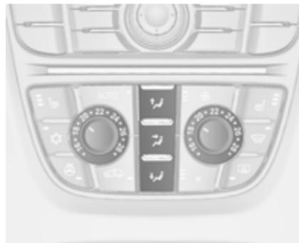
Pritisnite ustrezni gumb za želeno nastavitev. LED dioda v gumu sveti in s tem označuje vključeno stanje.
