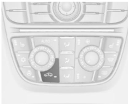
Za vklop kroženja zraka pritisnite
