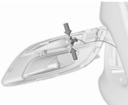
3. Držalo žarnice sprostite z ohišja žarometa s pritiskom na obe pritrdirilni zaponki.
