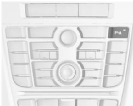
Parkirni pomočnik spredaj-zadaj je opremljen z P/A. Če je vozilo dodatno opremljeno z naprednim parkirnim pomočnikom (glejte ločen opis v nadaljevanju), je sistem mogoče upravljati z P/A. Oba sistema upravljate s pritiskom P/A.
