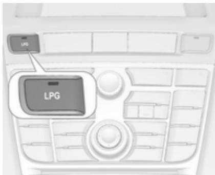
Po pritisku **LPG** se preklop med bencinskim in plinskim pogonom izvrši, takoj ko so izpolnjeni zahtevani pogoji (temperatura hladilne tekočine, temperatura plina in minimalno število vrtljajev motorja). Ti pogoji so običajno izpolnjeni po približno 60 sekundah (odvisno od zunanje temperature) in prvem odločnejšem pritisku na pedal za plin. LED dioda prikazuje trenutni način delovanje z motorjem v teku.
