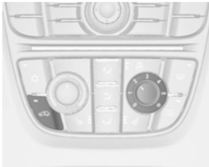
Za vklop kroženja zraka pritisnite
