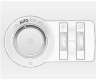
Pri vključeni funkciji samodejnega vklopa luči med obratovanjem motorja sistem preklopi med dnevni lučmi in samodejno delajočimi lučmi v odvisnosti od svetlobnih razmer.
