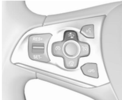
S prvim pritiskom gumba na voznikovem informacijskem zaslonu prikažete trenutno nastavitve. Nastavitve spremenite z naknadnim pritiskanjem istega gumba. Izbrana nastavitev se ohrani, dokler je ne spremenite. Čas vklopa opozoril je odvisen od hitrosti vozila. Večja ko je hitrost vožnje, večja bo razdalja, pri kateri se bo pojavilo opozorilo. Pri
