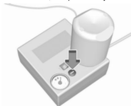
Če predpisan tlak ni dosežen v roku desetih minut, odstranite komplet za popravilo pnevmatik. Premaknite vozilo za en obrat kolesa. Ponovno priklopite komplet za popravilo pnevmatik in nadaljujte s postopkom polnjenja pnevmatike še dodatnih deset
