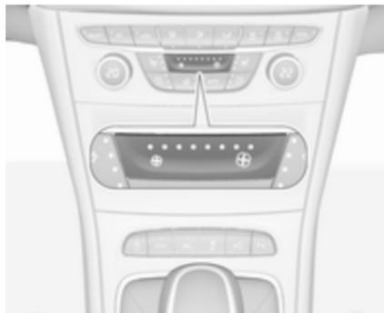
Pritisnite levo tipko za zmanjšanje ali desno tipko za povečanje hitrosti ventilatorja. Hitrost ventilatorja je prikazana s številom vklopljenih lučk LED v gumbu.
