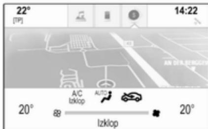
Vsaka sprememba nastavitve je prikazana na informacijskem prikazovalniku za nekaj sekund. Primerno delovanje elektronske klimatske naprave je zagotovljeno le pri obratujočem motorju.
