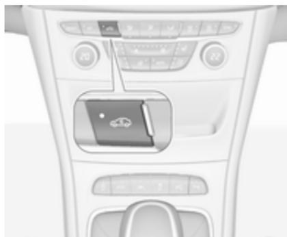
Za vklop kroženja zraka pritisnite
