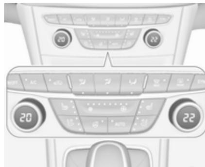
Nastavite temperature na želeno vrednost. Z vrtljivim gumbom na sovoznikovi strani spremenite temperaturo na sovoznikovi strani. Z vrtljivim gumbom na voznikovi strani spremenite temperaturo na voznikovi strani ali na obeh straneh, če je vklopljena sinhronizacija **SYNC**.
