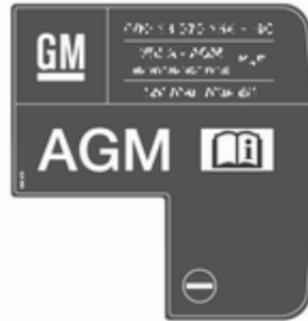
Akumulator AGM lahko prepoznate po identifikacijski nalepki. Priporočamo uporabo originalnega akumulatorja vozila Opel.
