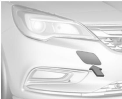
Vstavite izvijač v spodnji del pokrova. Odpnite pokrov s previdnim pomikom izvijača navzdol.
