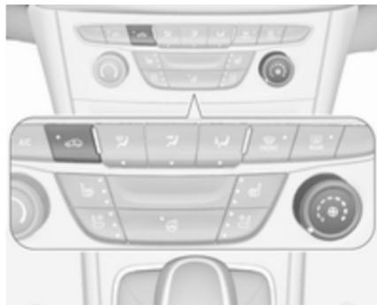
Za vklop kroženja zraka pritisnite
