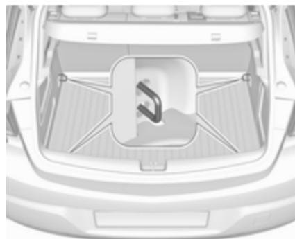
Pri vozilih, ki so opremljena z rezervnim kolesom, so pritrdilna ušesca na stranskih stenah.
