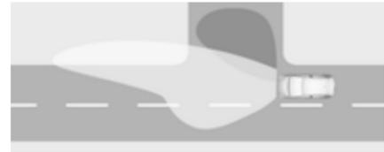
Pri zavijanju na odcepih se na podlagi kota volana in vklopljenega smernika vklopijo določene lučke LED, ki osvetlijo smer vožnje. Funkcija deluje le pod hitrostjo 40 km/h.
