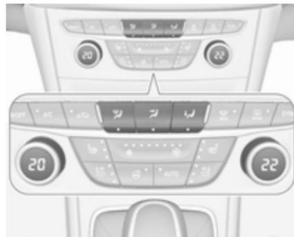
Pritisnite ustrezen gumb za zeleno nastavitev. LED dioda v gumbu sveti in s tem označuje vključeno stanje.
