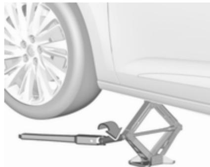
Namestite ključ za kolesa in ga vrtite pri pravilno izravnani dvigalki, dokler se kolo ne dvigne od tal. Dvigalko ne dvigajte višje od te točke.
