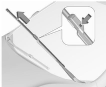
Dvignite roko brisalca, dokler ne ostane dvignjena, pritisnite gumb za sprostitvev metlice in jo odstranite.
