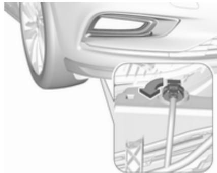
1. Držalo žarnice obrnite v levo in ga izvlecite iz ohišja žaromet.
