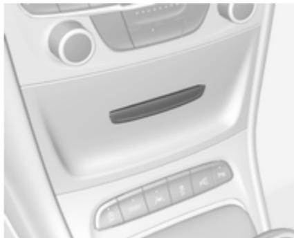
Napajalni priključek (PowerFlex Bar) je na pokrovu škatle z varovalkami na armaturni plošči. Razpršilnik za dišavo (AirWellness) ali držalo telefon sta lahko tudi pritrjena na napajalni priključek.
