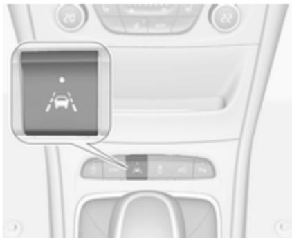
Pomočnik za ohranjanje voznega pasu vklopite s pritiskom
