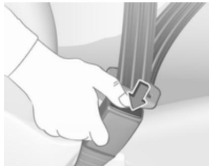
Pas odpnete s pritiskom na rdeč gumb na zaklepu.
