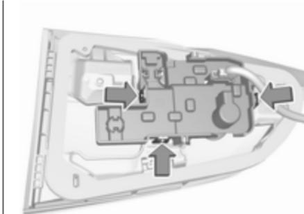
4. Pritisnite tri pritrdilne zaponke in odstranite nosilec žarnic iz sklopa luči.
