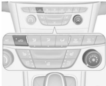
Za vklop kroženja zraka pritisnite
