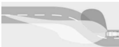
Na podlagi kota volana in hitrosti se vklopijo dodatne lučke LED, ki izboljšajo osvetlitev zavoja. Ta funkcija se vklopi pri hitrosti med 40 in 70 km/h ter se prilagaja kotu volana.
