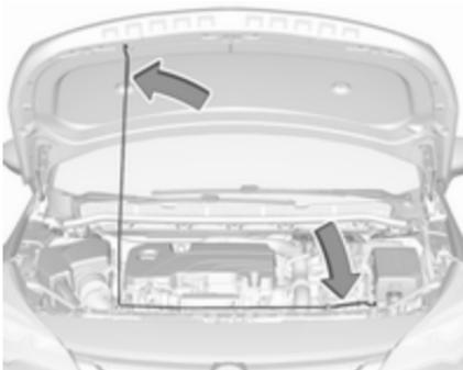
Zataknite podporno prečko.
