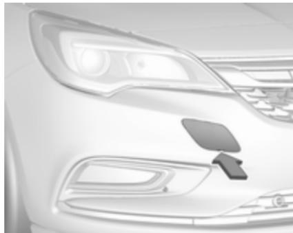
Okoli konice ploskega izvijača ovijte krpo, da preprečite poškodbo laka. Vstavite izvijač v spodnji del pokrova. Odpnite pokrov s previdnim pomikom izvijača navzdol.
