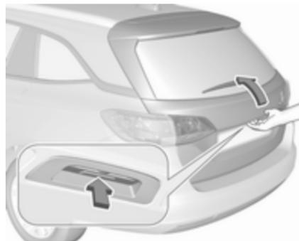
Za odpiranje vrat prtljažnika se dotaknite stikala pod prijemkom na vratih prtljažnika po odklepanju.
