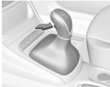
Za vklop vzvratne prestave pritisnite pedal sklopke, pritisnite sprostilveni gumb na izbirni ročici in prestavite. Če ni možno prestaviti v vzvratno prestavo, ponovno pomaknite ročico v prosti tek, sprostite in še enkrat pritisnite pedal sklopke ter nato ponovno prestavite v vzvratno prestavo.
