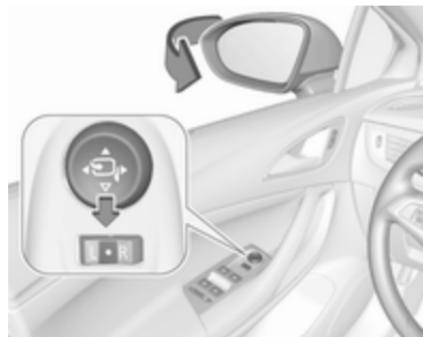
Element za upravljanje preklopite na ● in potisnite stikalo ▼ navzdol. Obe zunanjji ogledali se preklopita.
