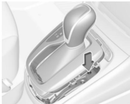
3. V odprtino ob izbirni ročici vstavite majhno paličasto orodje (npr. svinčnik ali izvijač). Paličasto orodje potisnite naravnost navzdol in izbirno ročico povlecite iz položaja P. Če jo boste znova premaknili v ta položaj, se bo znova zataknila. Vzrok prekinite napajanja dajte nemudoma odpraviti strokovnjakom v servisni delavnici.
