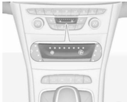
Pritisnite levo tipko za zmanjšanje ali desno tipko za povečanje hitrosti ventilatorja. Hitrost ventilatorja je prikazana s številom vklapljenih lučk LED v gumbu.
