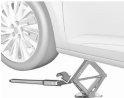
Namestite ključ za kolesa in ga vrtite pri pravilno izravnani dvigalki, dokler se kolo ne dvigne od tal. Dvigalki ne dvigajte višje od te točke.
