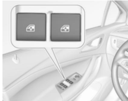
Za odpiranje želenega okna pritisnite ustrezno stikalo in za zapiranje okna stikalo potegnite.
