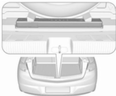
Opozorilni trikotnik shranite v vdrti del na sprednjem delu vrat prtljažnika.
