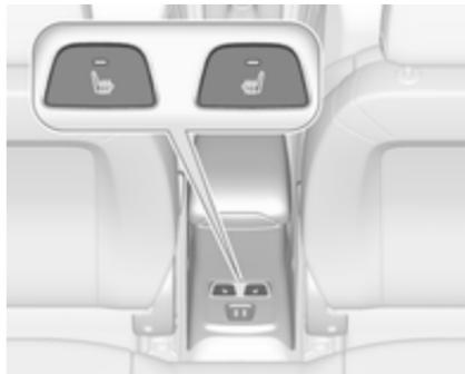
Vključite ogrevanje sedeža s pritiskom na za želen zunanj zunanji zadnji sedež. Vklip signalizira LED indikator v stikalnu.
