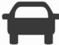
Prizge se zelena lučka "spredaj vozeče vozilo" , če sistem zazna vozilo v smeri vožnje pred vami. Domet senzorjev je med 25 in 150 metrov, odvisno od hitrosti vozila. Opozorilo za trk spredaj  $\Rightarrow$  201.
