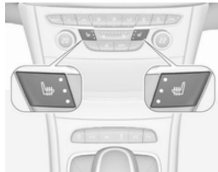
Nastavite želeno stopnjo ogrevanja s pritiskom na  $\mathbb{H}$  enkrat ali večkrat. Indikator v stiku označuje nastavitev.
