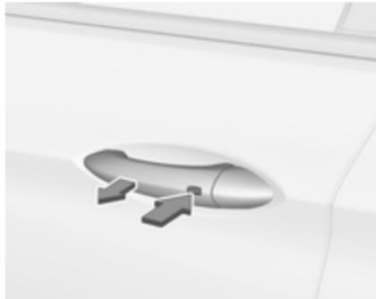
Pritisnite gumb na ustreznih zunanjih vrat in potegnite ročico.
