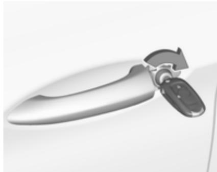
Zatiče za zaklepanje na vseh vratih razen voznikovih potisnite navznoter ali pa na plošči na voznikovih vratih pritisnite ⓘ. Voznikova vrata zaklenete tako, da ključ z zunanje strani vrat vstavite v ključavnico in ga obrnete. Prtljažnik in loputa posode za gorivo se morda ne bosta zaklenila.
