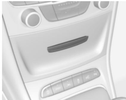
Napajalni priključek (PowerFlex Bar) je na pokrovu škatle z varovalkami na armaturni plošči. Razpršilnik za dišavo (AirWellness) ali držalo telefon sta lahko tudi pritrjena na napajalni priključek.
