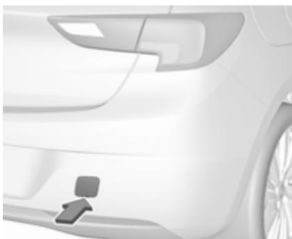
Okoli konice ploskega izvijača ovijte krpo, da preprečite poškodbo laka. Vstavite izvijač v spodnjo režo pokrova. Odpnite pokrov s previdnim pomikom izvijača navzdol.
