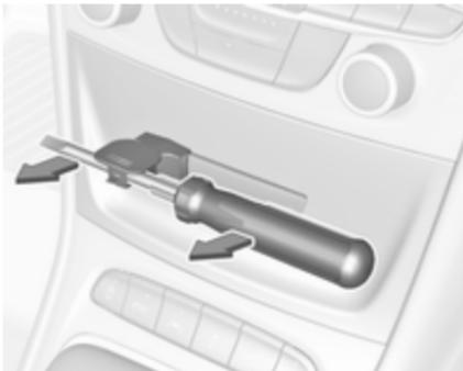
Izvijač potisnite skozi režo v vmesniku. Pokrov odstranite tako, da povlečete izvijač.
