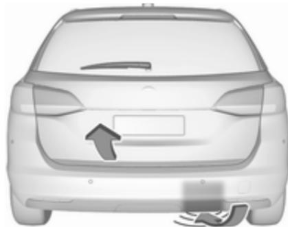
Če želite odpreti ali zapreti vrata prtljažnika, s stopalom pomigajte naprej in nazaj pod zadnjim prtljažnikom na predelu, ki je prikazan na sliki. Če je vozilo opremljeno s parkirnim pomočnikom, je zaznava mogoča na predelu pod prikazanim senzorjem. Stopala ne držite na mestu in ga ne premikajte prepočasi. Pri tem mora biti elektronski oddajnik v dometu zunanjega sprejema antene, približno en meter od vrat prtljažnika.
