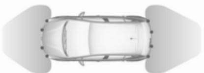
Sistem vsebuje štiri senzorje, vgrajene v zadnjem in sprednjem odbijaču.
