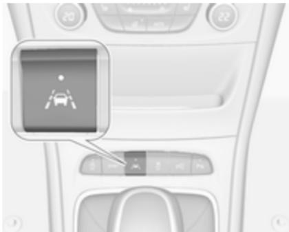
Pomočnik za ohranjanje voznega pasu vklopite s pritiskom . LED v stikuju zasveti, da prikaže, da je sistem vključen.
