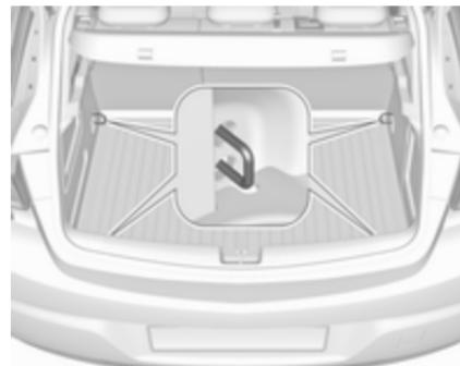
Pri vozilih, ki so opremljena z rezervnim kolesom, so pritrdilna ušesca na stranskih stenah.
