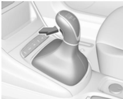
Vzvratna prestava: ko vozilo miruje, pritisnite pedal sklopke, nato pritisnite gumb na prestavni ročici in prestavite. Ročni menjalnik ⇨ 180.
