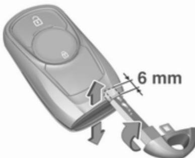
2. Znova vstavite ključ približno 6 mm globoko in ga obrnite, da odprete ohišje. Če ključ potisnete globlje, lahko poškodujete ohišje.
