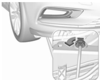
1. Držalo žarnice obrnite v levo in ga izvlecite iz ohišja žarometa.
