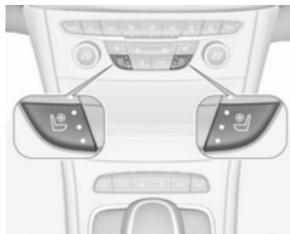
Nastavite želeno stopnjo prezračevanja s pritiskom na za želeni sedež enkrat ali večkrat. Indikator v stiku označuje nastavitev.
