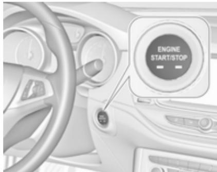
Ročni menjalnik: pritisnite sklopko in zavorni pedal.
