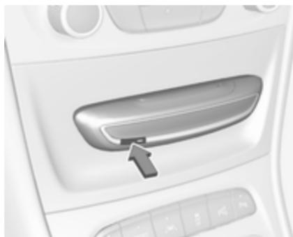
2. Če želite vklopiti ali izklopiti razpršilnik za dišavo, pritisnite sprednji gumb. Ob vklopu zasveti lučka LED.
