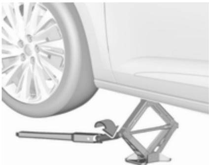
Namestite ključ za kolesa in ga vrtite pri pravilno izravnani dvigalki, dokler se kolo ne dvigne od tal. Dvigalke ne dvigajte višje od te točke.
