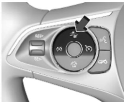
Pritisnite . Trenutna nastavitev se prikaže na informacijskem centru voznika. Znova pritisnite , da spremenite razdaljo sledenja. Nastavitev se prikaže tudi na voznikovem informacijski zaslonu.
