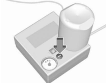
Če predpisani tlak ni dosežen v roku 10 min, odstranite komplet za popravilo pnevmatik. Premaknite vozilo za en obrat kolesa. Znova namestite komplet za popravilo pnevmatik in postopek polnjenja izvajajte 10 min. Če kljub temu ne
