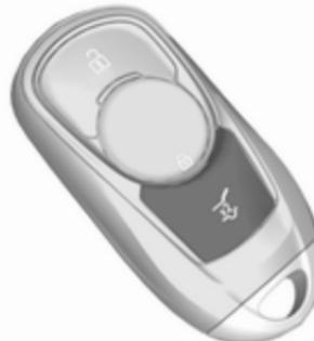
Za zapiranje ali odpiranje vrat prtljažnika dvakrat pritisnite ⏪. Če želite preprečiti neželeno odpiranje vrat prtljažnika, morate ⏪ med odklepanjem ali zaklepanjem pritisniti za dalj časa.
