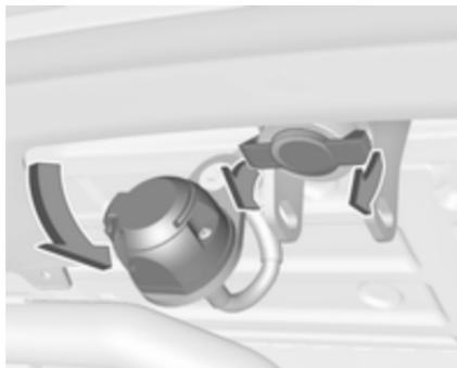
Iztaknite povezovalni priključek in ga poklopite navzdol. Iz odprtine za vlečno kljuko izvlecite tesnilni čep in ga pospravite v prtljažnik.
