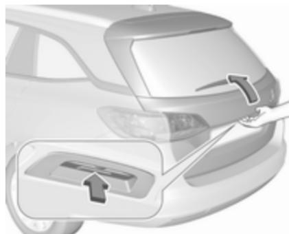
Za odpiranje vrat prtljažnika pritisnite tipko pod prijemkom vrat, dokler se vrata ne pričnejo odpirati. Če je vozilo zaklenjeno, mora biti elektronski oddajnik v dometu zunanjega sprejema antene, približno en meter od vrat prtljažnika.
