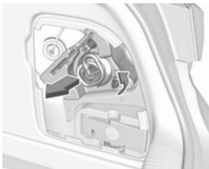
2. Komplet za popravilo pnevmatik: Če želite zamenjati žarnice na desni strani, najprej odvijte plastični vijak in izvlecite vložek s tesnilno posodo.
