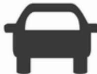
Prične se zelena lučka "spredaj vočevo vozilo" , če sistem zazna vozilo v smeri vožnje pred vami. Domet senzorjev je med 25 in 150 metrov, odvisno od hitrosti vozila. Opozorilo za trk spredaj  $\diamond 201$ .
