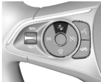
S prvim pritiskom gumba na voznikovem informacijskem zaslonu prikažete trenutno nastavitev. Nastavitev spremenite z naknadnim pritiskanjem istega gumba. Izbrana nastavitev se ohrani, dokler je ne spremeni. Čas vklopa opozoril je odvisen od hitrosti vozila. Večja ko je hitrost vožnje, večja bo razdalja, pri kateri se bo pojavilo opozorilo. Pri izbiranju nastavitev časa prikaz opozorila upoštevajte prometne in vremenske razmere.
