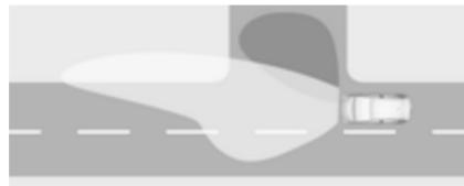
Pri zavijanju na odcepah se na podlagi kota volana in vklopljenega smernika vklopijo določene lučke LED, ki osvetljijo smer vožnje. Funkcija deluje le pod hitrostjo 40 km/h.
