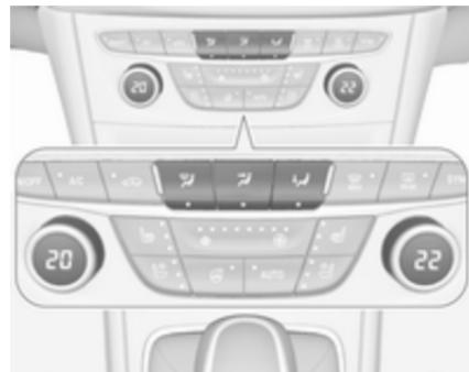
Pritisnite ustrezni gumb za želeno nastavitev. LED dioda v gumbu sveti in s tem označuje vključeno stanje.
