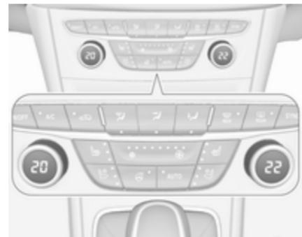
Nastavite temperature na želeno vrednost. Z vrtljivim gumbom na sovoznikovi strani spremenite temperaturo na sovoznikovi strani. Z vrtljivim gumbom na voznikovi strani spremenite temperaturo na voznikovi strani ali na obeh straneh, če je vklopljena sinhronizacija **SYNC**.
