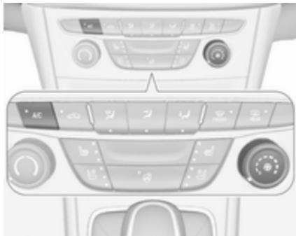
Za vklop hlajenja pritisnite **A/C**. LED dioda v gumbu sveti in s tem označuje vključeno stanje. Hlajenje deluje samo, kadar teče motor in je vključen ventilator sistema za ogrevanje, prezračevanje, hlajenje.
