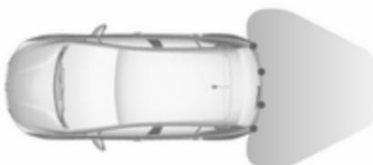
Sistem vsebuje štiri senzorje, vgrajene v zadnjem odbijaču.
