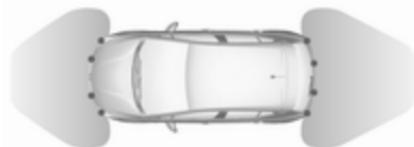
Sistem vsebuje štiri senzorje, vgrajene v zadnjem in sprednjem odbijaču.
