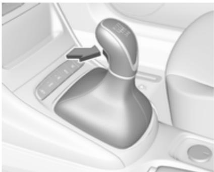
Vzvratna prestava: ko vozilo miruje, pritisnite pedal sklopke, nato pritisnite gumb na prestavni ročici in prestavite. Ročni menjalnik  $\diamond$  180.
