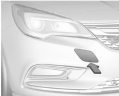
Okoli konice ploskega izvijača ovijte krpo, da preprečite poškodbo laka. Vstavite izvijač v spodnji del pokrova. Odpnite pokrov s previdnim pomikom izvijača navzdol.
