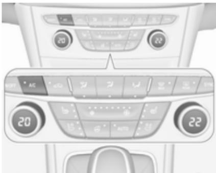
Za vklop hlajenja pritisnite **A/C**. LED dioda v gumbu sveti in s tem označuje vključeno stanje. Hlajenje deluje samo, kadar teče motor in je vključen ventilator sistema za ogrevanje, prezračevanje, hlajenje.
