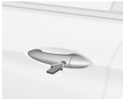
Sistem elektronskega oddajnika: Odklepanje vozila s pritiskom gumba na katerih koli zunanjih vratih izključi alarmno napravo.
