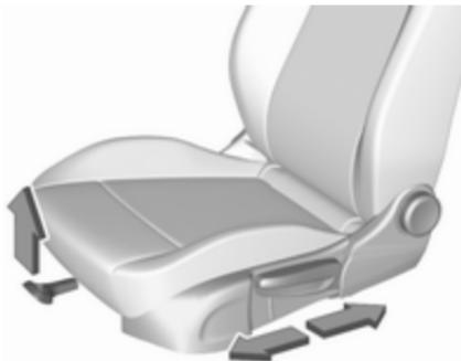
Potegnite ročico, pomaknite sedež, sprostite ročico. Sedež poskušajte pomakniti naprej in nazaj, da preverite, ali je pritrjen v ustrezнем položaju.
