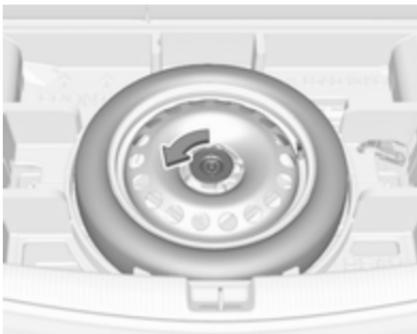
2. Rezervno kolo je zavarovano s krilno matico. Odvijte matico in odstranite rezervno kolo.
