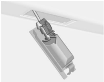
3. Obrnite držalo žarnice na levo in ga odstranite iz ohišja luči.
