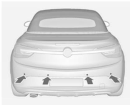
Sistem vsebuje štiri senzorje, vgrajene v zadnjem odbijaču.
