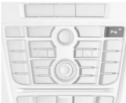
Parkirni pomočnik spredaj-zadaj je opremljen s tipko **P $\blacktriangle$** . Če je vozilo dodatno opremljeno z naprednim parkirnim pomočnikom (glejte ločen opis v nadaljevanju), je sistem mogoče upravljati s tipko **P $\blacktriangle$** . V tem primeru upravljate oba sistema s tipko **P $\blacktriangle$** .
