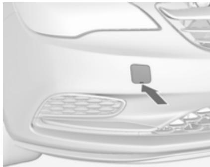
Vstavite izvijač v spodnji del pokrova. Odpnite pokrov s previdnim pomikom izvijača navzdol.
