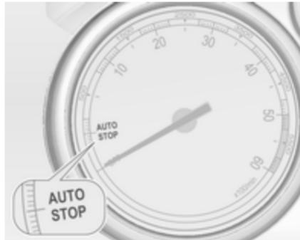
Funkcijo Autostop označuje kazalec v legi **AUTOSTOP** na števcu vrtljajev motorja.
