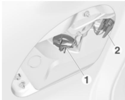
Odstranite držalo žarnice z vrtenjem na levo.
