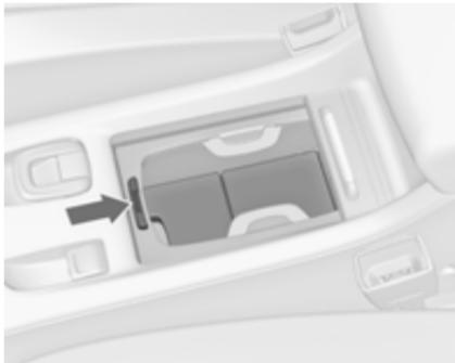
Za odstranitev okvira držala za pijačo pritisnite gumb. Okvir lahko pospravite v voznikov predal.
