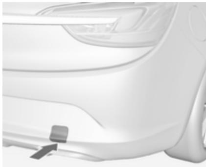
Vstavite izvijač v spodnjo režo pokrova. Odpnite pokrov s previdnim pomikom izvijača navzdol.
