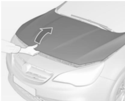
Premaknite varnostni zapah proti levi strani vozila in odprite pokrov motorja.
