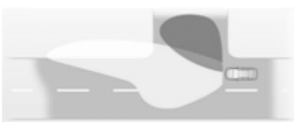
V ostrih zavojih ali pri zavijanju s ceste - odvisno od kota volana in/ali vklopja smernikov - se vklopi dodaten žaromet, ki osvetli cesto v pravem kotu v želeni smeri vožnje. Funkcija deluje le pod hitrostjo 40 km/h.
