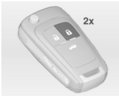
Dvakrat na kratko pritisnite tipko na daljinskem upravljalniku, preden poteče 15 sekund. Daljši pritisk sproži zapiranje platnene zložljive strehe.
