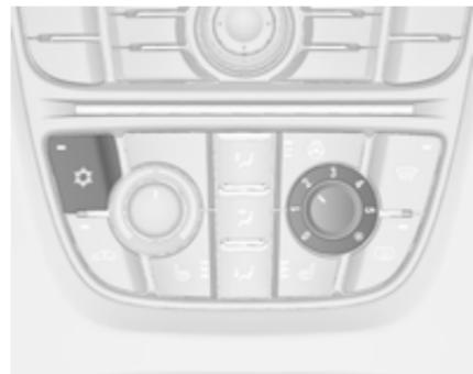
Za vklop hlajenja pritisnite tipko . Vklop signalizira LED lučka v stikaluh. Hlajenje deluje samo, kadar teče motor in je vključen ventilator sistema za ogrevanje, prezračevanje, hlajenje.
