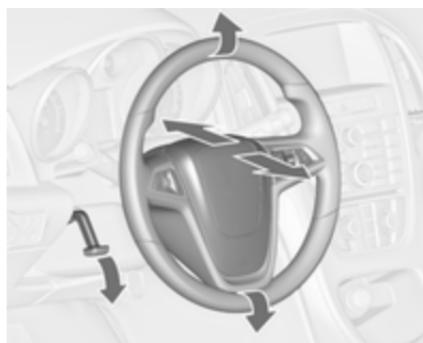
Sprostite ročico, nastavite volan, zataknite ročico v zavarovan položaj.
