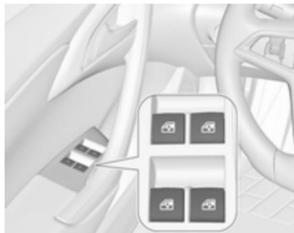
Za odpiranje želenega okna pritisnite ustrezeno stikalo in za zapiranje okna stikalo potegnite.
