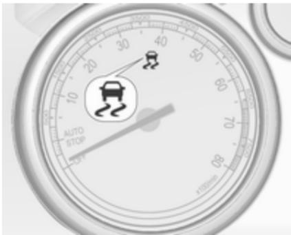
ESC je pripravljen za delovanje po zagonu motorja, potem ko ugasne kontrolna lučka .
