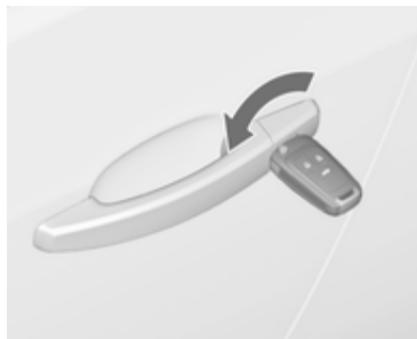
Odklenite voznikova vrata z obratom ključa v ključavnici. Vključite kontakt in pritisnite stikalo za odklepanje sovoznikovih vrat, prtljažnika in loputo rezervoarja goriva. Ob vklopu kontakta za vžig se izklopi varovalni zaklep proti kraji.
