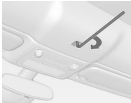
15. Vstavite inbus ključ širine 6 mm v zaključek in zapahnite zaskočko z vrtenjem inbus ključa na desno do njegovega končnega položaja.
