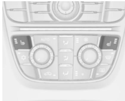
Nastavite želeno stopnjo ogrevanja s pritiskom ustreznega stikala enkrat ali večkrat. Lučka v tipki označuje izbrano nastavitev.
