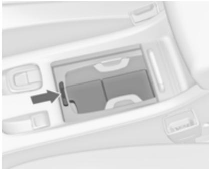
Za odstranitev okvira držala za pijačo pritisnite gumb. Okvir lahko pospravite v sovoznikov predal.
