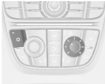
Za vklop hlajenja pritisnite . LED dioda v gumbu sveti in s tem označuje vključeno stanje. Hlajenje deluje samo, kadar teče motor in je vključen ventilator sistema za ogrevanje, prezračevanje, hlajenje.
