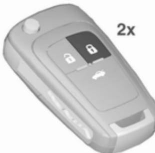
Dvakrat na kratko pritisnite tipko na daljinskem upravljalniku, preden poteče 15 sekund. Daljši pritisk sproži zapiranje platnene zložljive strehe.
