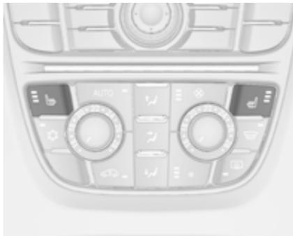
Nastavite želeno stopnjo ogrevanja s pritiskom na enkrat ali večkrat. Lučka v tipki označuje izbrano nastavitev.
