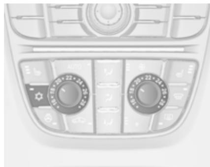
Za vklap hlajenja pritisnite
