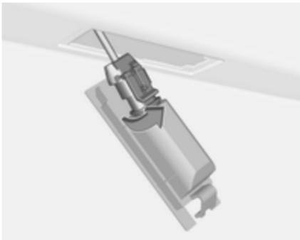
3. Obrnite držalo žarnice na levo in ga odstranite iz ohišja luči.
