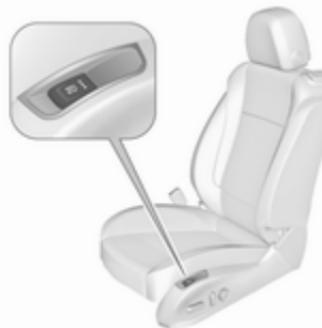
Nastavite želeno stopnjo zračenja s pritiskom na enkrat ali večkrat. Lučka v tipki označuje izbrano nastavitev.
