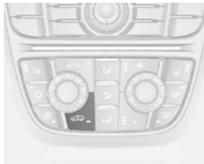
Za vklap kroženja zraka pritisnite
