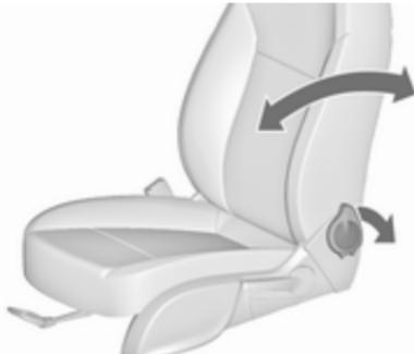
Obrnite ročico nazaj, nastavite nagib in spustite ročico. Sedež naj se primerno zaskoči.
