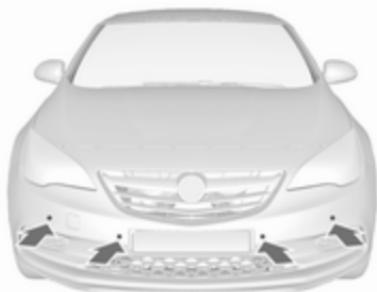
Sistem vsebuje štiri senzorje, vgrajene v zadnjem in sprednjem odbijaču.
