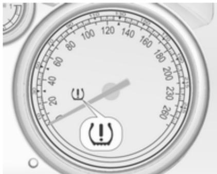
Če sistem zazna prenizek tlak v pnevmatikah, zasveti kontrolna lučka  $\text{!}$   $\diamond$  95.
