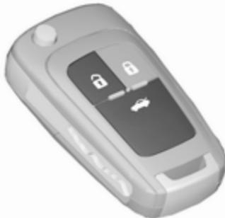
Za odklepanje vrat in pokrova prtljažnika pritisnite . Odprite vrata s potegom kljuge na vratih.
