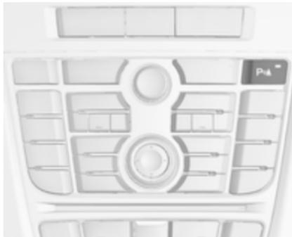
Parkirni pomočnik spredaj-zadaj je opremljen z  $\text{P} \swarrow \text{▲}$ . Če je vozilo dodatno opremljeno z naprednim parkirnim pomočnikom (glejte ločen opis v nadaljevanju), je sistem mogoče upravljati z  $\text{P} \swarrow \text{▲}$ . Oba sistema upravljate s pritiskom  $\text{P} \swarrow \text{▲}$ .
