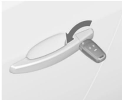
Odklenite voznikova vrata z obratom ključa v ključavnici. Vključite kontakt in pritisnite stikalo
