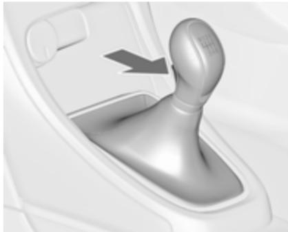
Za vklop vzvratne prestave, ko vozilo miruje, pritisnite pedal sklopke, pritisnite gumb na prestavni ročici in prestavite.
