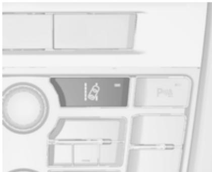
Sistem za opozorilo o nenamerni menjavi voznega pasu se aktivira s pritiskom . LED v stikalu označuje, da je sistem vklojen. Kadar kontrolna lučka na instrumentni tabli sveti zeleno, je sistem pripravljen na delovanje.
