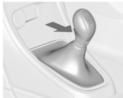
Vzvratna prestava: ko vozilo miruje, pritisnite pedal sklopke, pritisnite gumb na prestavnih ročicah in prestavite.
