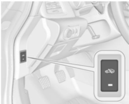
Nadziranje potniškega prostora in nagiba vozila izključite, npr. če pustite v vozilu kakšno žival, ker se utegne sprožiti alarm zaradi gibanja v vozilu, ultrazvočnih valov in nagibanja vozila pri prevozu. Nadziranje potniškega prostora in nagiba vozila prav tako izključite pri prevozu na ladji ali vlaku.
