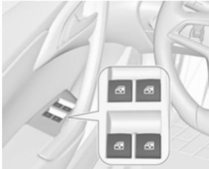
Za odpiranje želenega okna pritisnite ustrezno stikalo in za zapiranje okna stikalo potegnite.
