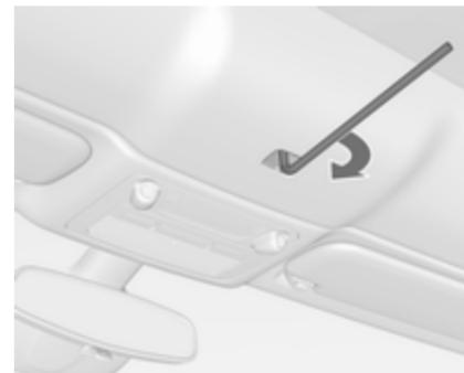
15. Vstavite inbus ključ širine 6 mm v zaključek in zapahnite zaskočko z vrtenjem inbus ključa na desno do njegovega končnega položaja.
