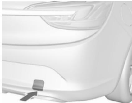
Vstavite izvijač v spodnjo režo pokrova. Odpnite pokrov s previdnim pomikom izvijača navzdol.
