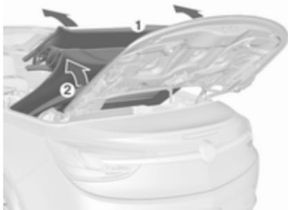
12. Izvlecite mehko streho, tako da dvignete sprednji lok (1) in hkrati napenjalni lok (2) na obeh straneh.
