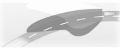
Zgubi žarometov se obračajo v odvisnosti od zavoja volana in hitrosti vozila za boljšo osvetlitev zavojev. Kontrolna lučka ⌂ ⇧ 96.
