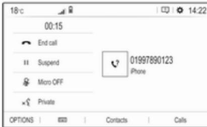
Če želite izklopiti mikrofon sistema Infotainment, pritisnite **Micro OFF (Mikrofon IZKL.)**.
