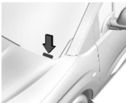
Pri drugačnih konstrukcijskih izvedbah najdete številko šasije tudi na armaturni plošči pod vetrobranskim stekлом.
