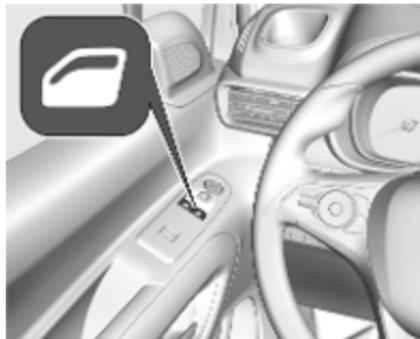
Za odpiranje želenega okna pritisnite ustrezeno stikalo in za zapiranje okna stikalo potegnite.
