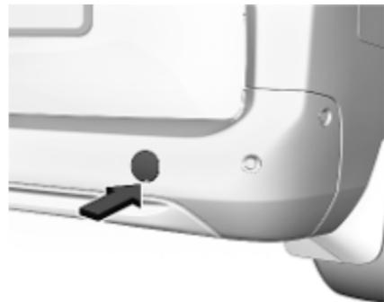
Okoli konice ploskega izvijača ovijte krpo, na primer, da preprečite poškodbo laka. Vstavite izvijač v spodnji del pokrova. Previdno sprostite pokrovček.
