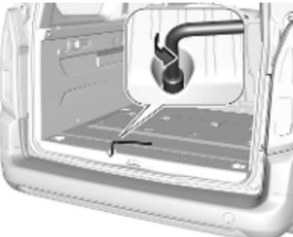
2. Kolesni ključ namestite na en vijak s šestrobno glavo. Zasukajte ga v levo, dokler ni nosilec rezervnega kolesa dovolj nizko, da je mogoče odpeti varovalo.
