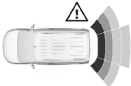
Prav tako je razdalja do ovir za avtomobilom prikazana s spremenjanjem črt razdalje na voznikovem informacijskem zaslonu  $\diamond 115$ . Ko se povsem približate oviru, se prikaže znak za nevarnost  $\Delta$
