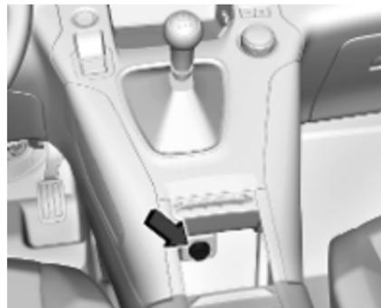
12-voltna električna vtičnica se nahaja za pokrovom prostora za spravljanje. Za odpiranje pokrov potisnite navzgor.
