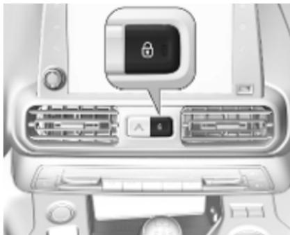
To funkcijo je mogoče kadar koli aktivirati ali deaktivirati. Pri vključenem kontaktu pritisnite gumb in ga držite, dokler se ne sproži zvočni signal in prikaže ustrezn sporočilo.
