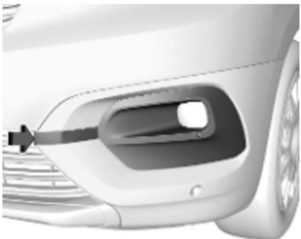
1. Okoli konice ploskega izvijača ovijte kropo, da preprečite poškodbo laka. Potisnite izvijač v režo na robu pokrova. Previdno odstranite pokrov, izvijač pa uporabite kot vzvod.
