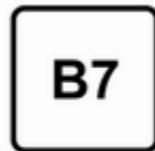
dizelsko gorivo, ki ustreza standardu EN590, mešano z biodizelskim gorivom, ki ustreza standardu EN14214 (in vsebuje največ 7 % metilnega estra maščobnih kislin);
