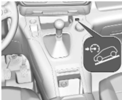
Pri hitrostih pod približno 50 km/h pritisnite . Sistem je mogoče izklopiti tudi takrat, ko vozilo miruje z motorjem v teku. Kontrolna lučka na instrumentni plošči zasveti zeleno in tako označi, da je sistem vklopljen.
