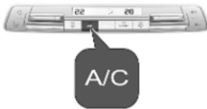
Za vklop hlajenja pritisnite **A/C**. Hlajenje deluje samo, kadar teče motor in je vključen ventilator sistema za ogrevanje, prezračevanje, hlajenje.
