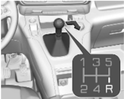
Če želite pri 5-stopenjskem menjalniku prestaviti v vzvratno prestavo, pritisnite stopalko sklopke in premaknite izbirno ročico v desno in nazaj.
