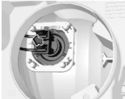
2. Izvlecite držalo žarnice iz ohišja žarometa.
