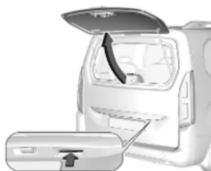
Po zaklepanju pritisnite desni gumb vrat prtljažnika in odprite zadnje steklo.
