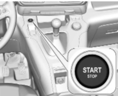
Elektronski oddajnik mora biti v vozilu.
