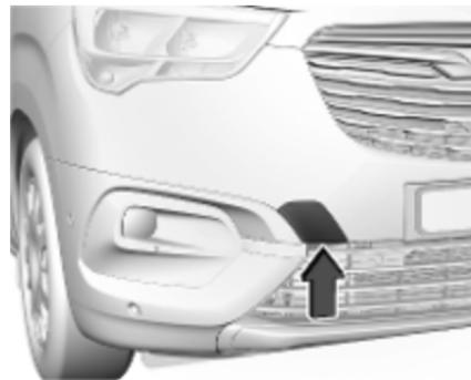
Okoli konice ploskega izvijača ovijte krpo, na primer, da preprečite poškodbo laka. Vstavite izvijač v spodnji del pokrova. Previdno sprostite pokrovček.
