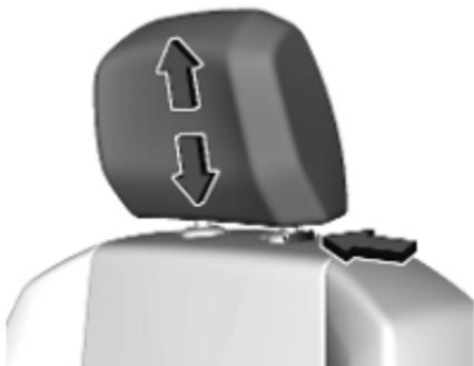
S pritiskom gumba sprostite vzglavnik, nastavite višino in pustite, da se zaskoči v zavarovani položaj.
