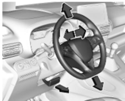
Sprostite ročico, nastavite volan, zataknite ročico v zavarovan položaj. Volana ne nastavljamte pri premikajočem vozilu in/ali blokiranim volanu.
