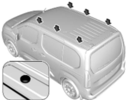
Za namestitve strešnega prtljažnika odvijte pokrove v stranskih vodilih na strehi. V držalo vstavite namestitvene elemente, v skladu z navodili.
