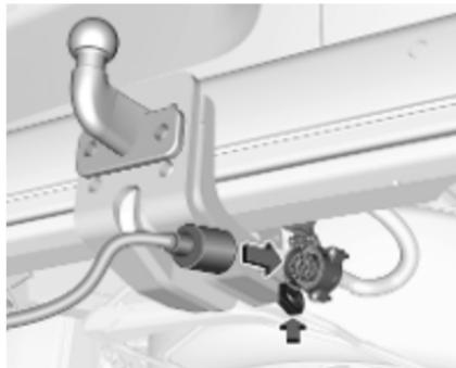
1. Vtič za prikolice priklopite na vtičnico in zaviralni kabel pritrđite na ušesce na nosilcu.
