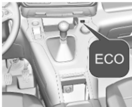
Ta način prilagodi nastavitev sistemov za bolj varčno porabo goriva, npr. z optimizacijo prestavnih točk avtomatskega menjalnika in nastavitev občutljivosti pedala za plin.
