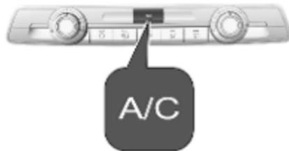
Za vklop hlajenja pritisnite A/C. LED dioda in gumbu sveti in s tem označuje vključeno stanje. Hlajenje deluje samo, kadar teče motor in je vključen ventilator.
