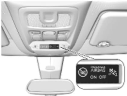
Če kontrolna lučka ⚡ po vključitvi kontakta vžiga sveti pribl. 60 sekund, je sistem varnostnih blazin na sovoznikovi strani aktiven in se bo v primeru trka sprožil.
