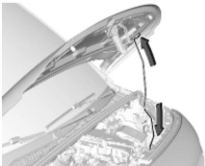
Zataknite podporno prečko.
