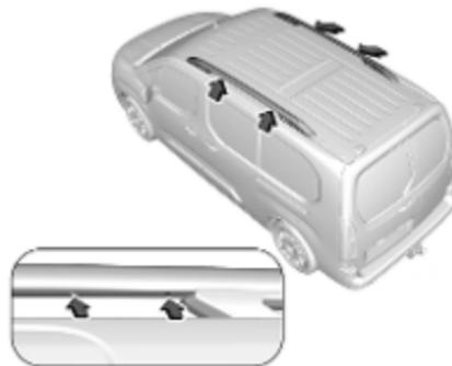
Montažne točke so na spodnji strani strešnega nosilca.
