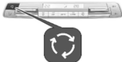
Pritisnite **○** za vklop način kroženja zraka. Na prikazovalniku se prikaže **○**, kar označuje vklop.
