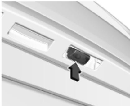
1. Vstavite izvijač, na primer, v vdolbino pokrova in pokrov odstranite.
