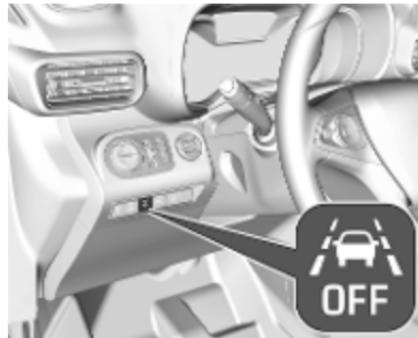
Če je sistem vklopljen, lučka LED v gumbu ne sveti. Če želite vklopiti sistem, ki je izklopljen, pritisnite .
