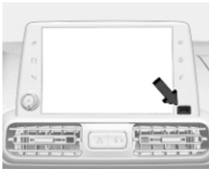
USB vhod je na instrumentni plošči zraven informacijskega prikazovalnika.
