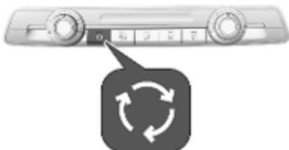
Za vklop kroženja zraka pritisnite Ⓛ. LED dioda v gumbu sveti in s tem označuje vključeno stanje.
