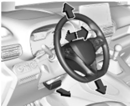
Sprostite ročico, nastavite volan, zataknite ročico v zavarovan položaj. Volana ne nastavljajte pri premikajočem vozilu in/ali blokiranim volanu.
