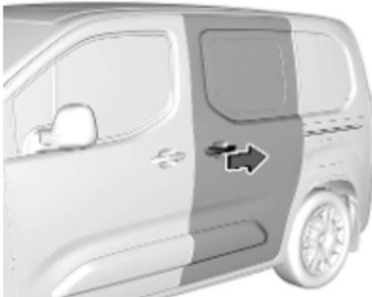
Ko ste odklenili vrata, povlecite zunanjo kljuko vrat in vrata potisnite proti zadnjemu delu onkraj točke upora.
