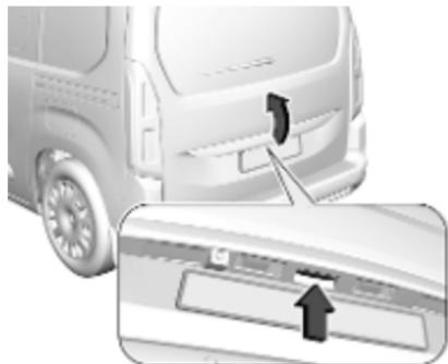
Po zaklepanju pritisnite gumb vrat prtljažnika in odprite vrata prtljažnika.
