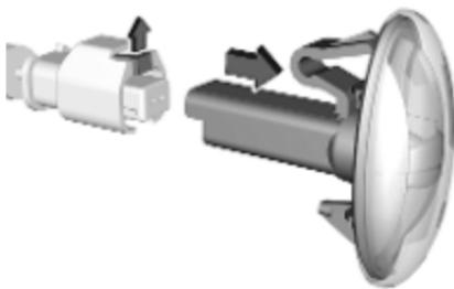
2. Pritisnite držalna ušesca navzgor in odstranite držalo žarnice iz nasadnega priključka.
