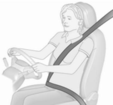
Izvlecite varnostni pas in ga zataknite v zaklep. Bočni del pasu ne sme biti zvit na nobenem delu in se mora tesno prilegati k telesu. Naslonjalo naj ne bo nagnjeno preveč nazaj (priporočen kot nagiba: največ 25°).
