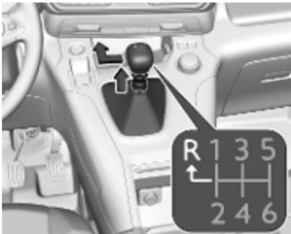
Če želite pri 6-stopenjskem menjalniku prestaviti v vzvratno prestavo, povlecite obroček pod glavo izbirne ročice in jo premaknite povsem v levo in naprej.
