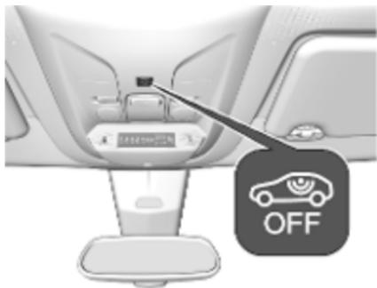
Nadziranje potniškega prostora izključite, če pustite v vozilu kakšno žival, ker se utegne sprožiti alarm zaradi gibanja v vozilu, ultrazvočnih valov in nagibanja vozila pri prevozu. Nadziranje potniškega prostora in nagiba vozila prav tako izključite pri prevozu na ladji ali vlaku.
