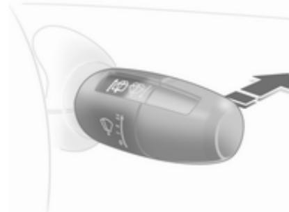
Ročico potisnite naprej. Brisalec briše zadnje steklo v intervalih. Izklop brisalca: ročico potisnite še enkrat naprej.
