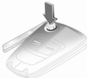
Za izskok ključeve brade pritisnite gumb. Za preklop ključeve brade pritisnite isti gumb.
