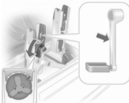
Z vrtljivo ročico na držalu pedala prilagodite nosilni vložek tipu (izstopanju) ojnice pedala primerno.
