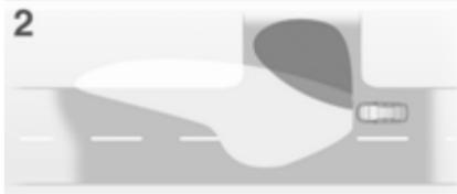
Zglobi žarometov se obračajo v odvisnosti od zavoja volana in hitrosti vozila.
