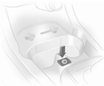
Dodatni avdio vir kot npr. prenosni CD predvajalnik lahko priklopite prek 3,5 mm vtikača na dodatni vhod.
