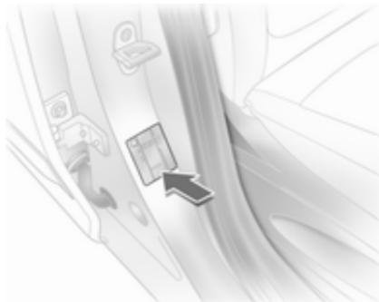
Tipska ploščica je pritrjena na okvir sprednjih desnih vrat - na stebru-B.
