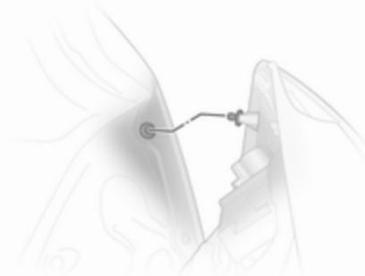
9. Ohišje luči pravilno namestite na svoje mesto na karoseriji in pritegnite pritrdilne matice z roko. Priključite kabelski priključek. Zaprite pokrov.
