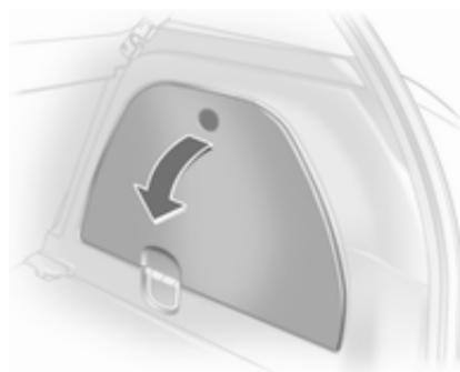
Komplet za popravilo pnevmatik se nahaja v prtljažniku v desnem stranskem predalu za spravljanje. Za odpiranje prostora iztaknite pokrov in ga odprite.
