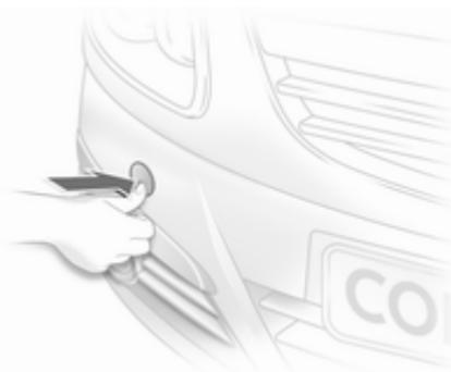
Iztaknite spodnji del pokrova in ga odstranite navzdol.
