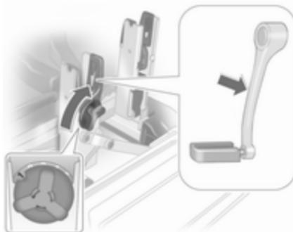
V primeru koles z izbočenimi ojnicami pedal obrnite vložek za pedalo navznoter (položaj 1).
