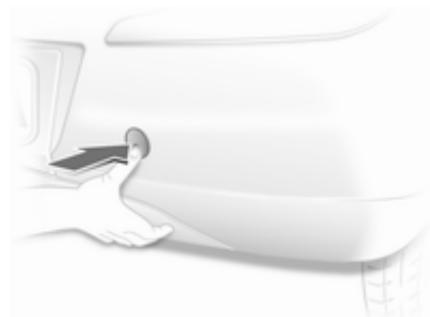
Iztaknite spodnji del pokrova in ga odstranite navzdol.
