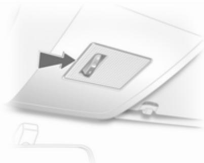
1. Iztaknite zaslonko z izvijačem na mestu, ki ga označuje zgornja slika.
