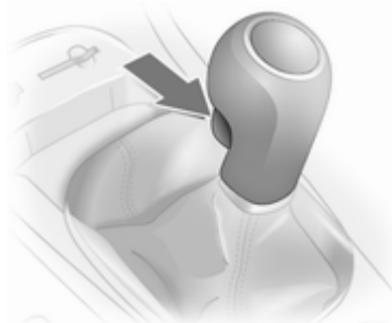
Za vklop vzvratne prestave: ko vozilo miruje, pritisnite pedal sklopke, tako počakajte 3 sekunde, potegnite vzvod (gumb) navzgor in prestavite.
