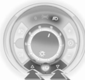
Za prilagoditev višine svetlobnega snopa, da ne slepite ostalih udeležencev v prometu: Pritisnjte tipko  $\Delta$  ali  $\nabla$ , dokler se na prikazovalniku prevoženih kilometrov ne pojavi želena nastavitev. Prikazovalnik označuje skupaj s simbolom  $\text{AD}$  za 4 sekunde pri vklopu kratkih luči ali vsakič, ko spremenite višino svetlobnega snopa.
