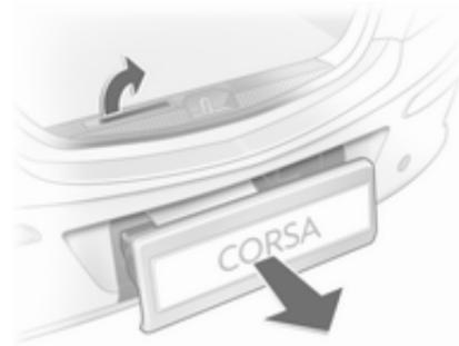
Potegnjite zaklepni vzvod navzgor. Sistem se sprosti in izskoči iz odbijača.
