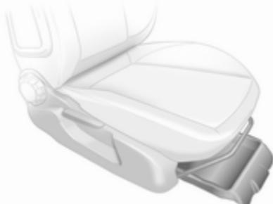
S prijemom izdolbljenega robu privzdignite predal in ga potegnjite naprej. Maksimalna nosilnost: 1,5 kg. Zapiranje predala: potisnite ga pod sedež, da se zatakne.
