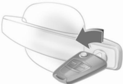
Obrnite ključ v ključavnici voznikovih vrat do konca. Z odpiranjem voznikovih vrat se odklenejo vsa vrata. Za odpiranje ostalih vrat vključite kontakt in pritisnite stikalo za centralno zaklepanje.
