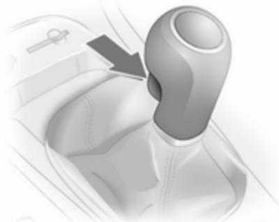
Vzvratna prestava: ko vozilo miruje, pritisnite pedal sklopke, tako počakajte 3 sekunde, potegnite vzvod (gumb) navzgor in prestavite.
