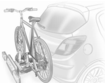
Zadnji nosilec (Flex-Fix sistem) omogoča nameščanje dveh koles na raztegljiv nosilec, ki je integriran v dnu vozila.
