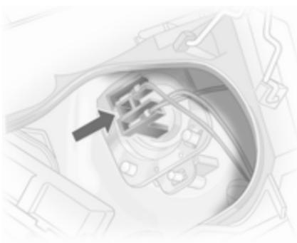
2. Nosilec žarnice potisnite v stran in ga skupaj z žarnico izvlecite iz žarometa.
