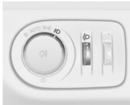
Za prilagoditev višine svetlobnega snopa, da ne slepite ostalih udeležencev v prometu: Obračajte gumb ⇨, dokler se na prikazovalniku prevoženih kilometrov ne pojavi zelenena nastavitev. Prikazovalnik označuje skupaj s simbolom ⇨ za
