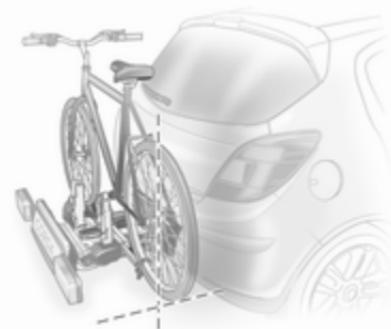
Kolo namestite longitudinalno glede na vozilo: Popustite vijak nastavka za ojnicu pedala.
