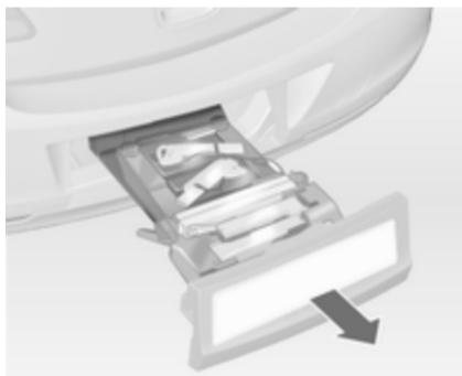
Potegnite zadnji nosilec do konca navzven, da se zaskoči.
