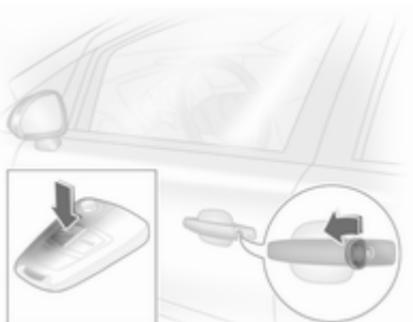
Obrnite ključ v ključavnici voznikovih vrat proti sprednjemu delu vozila ali pa pritisnite tipko
