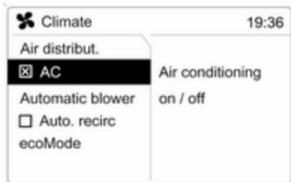
V meniju **Climate (klimatska naprava)** izberite postavko **AC** in jo s pritiskom na gumb vključite ali izključite.
