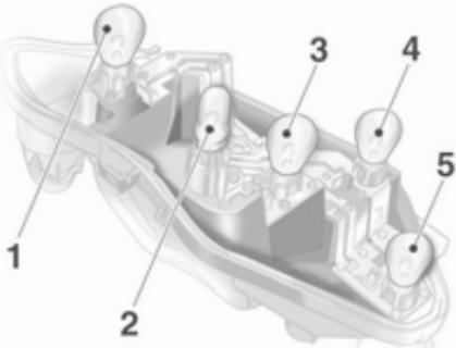
6. Žarnico rahlo pritisnite v nosilec, jo obrnite v levo in izvlecite ter vstavite novo žarnico.
