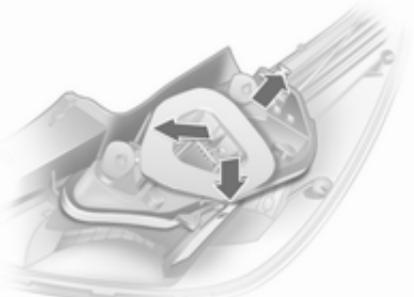
5. Narašlo pritisnite tri pritrdilne sponke ob stranicah nosilca žarnic navzven in nosilec z žarnicami izvlecite iz ohišja.
