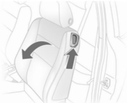
Privzdignite sprostilni vzvod in preklopite naslonjalo naprej. Spustite sprostilni vzvod in naslonjalo se zaskoči v prekopljenem položaju. Pomaknite sedež naprej.
