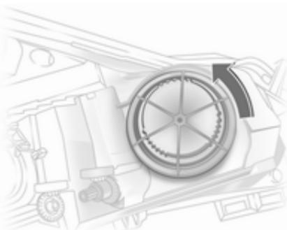
1. Pokrov **2** žarometa obrnite v obratno smer urinega kazalca in ga odstranite.
