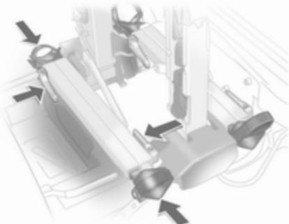
Pritisnite sprostilni vzvod in potisnite pritrdilna vodila za zračnice do blokade.
