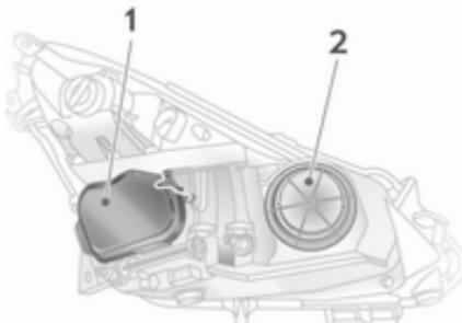
Sprednji žarometi z ločenimi kratkimi lučmi 1 (zunanja žarnica) in dolgimi lučmi 2 (notranja žarnica). Dodatna žarnica za osvetlitev krišič se nahaja pod pokrovom žarnice dolgih luči.
