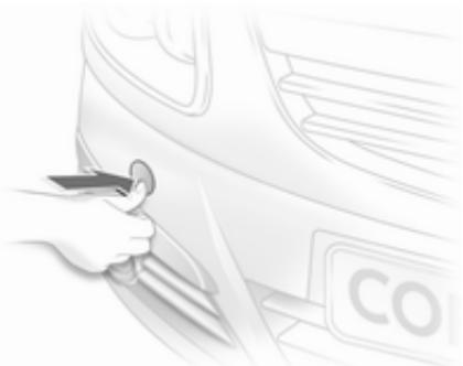
Iztaknите spodnji del pokrova in ga odstranite navzdol.
