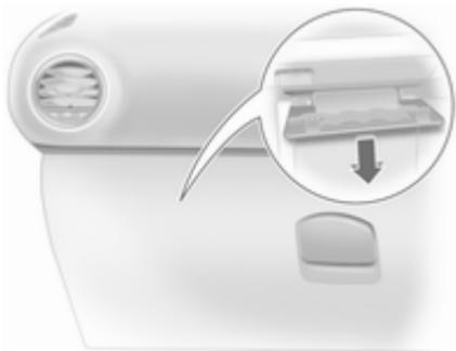
Pri vozilih z volanom na desni strani se škatla z varovalkami nahaja za pokrovom v sovoznikovem predalu. Odprite predal in odstranite pokrov. Zapiranje: namestite pokrov in ga zataknite v pravilen položaj.
