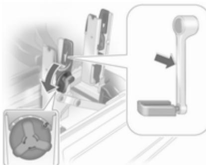
Z vrtljivo ročico na držalu pedala prilagodite nosilni vložek tipu (izstopanju) ojnice pedala primerno.
