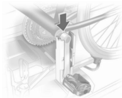
Postavite kolo na nosilec. Ojnico pedala vstavite v odprtino v držalu za pedalo, kot je prikazano na zgornji sliki.
