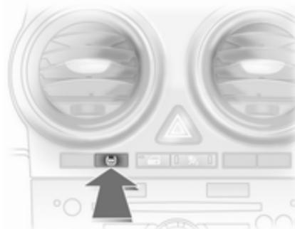
Po popravku tlaka v pnevmatikah ali po zamenjavi kolesa/pnevmatike morate sistem ponastaviti: Vključite kontakt, tipko DDS pridržite pritisnjeno približno 4 sekunde; kontrolna lučka ⚡ utripne trikrat.
