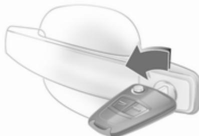
Obrnite ključ v ključavnici vozniških vrat do konca. Z odpiranjem vozniških vrat se odklenejo vsa vrata. Za odpiranje ostalih vrat vključite kontakt in pritisnite stikalo za centralno zaklepanje.
