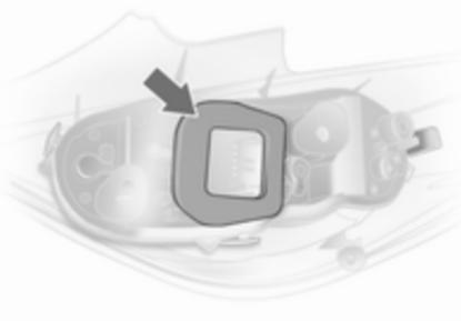
8. Pazite, da je tesnilo nosilca žarnic nameščeno tako, kot je prikazano na sliki. Na pritrdilni vijak namestite tesnilo.
