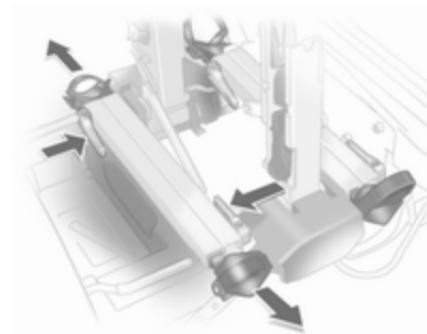
Pritisnite sprostilni vzvod in izvlecite pritrdilna vodila za zračnice.
