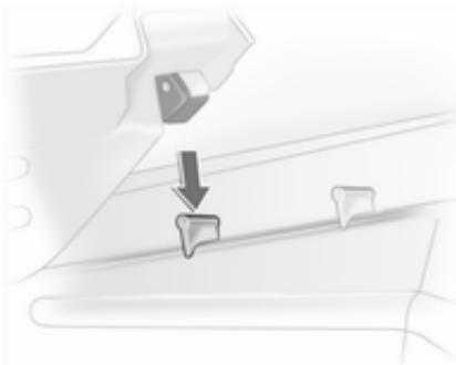
Za dviganje ostalih treh segmentov (zaporedje 2 do 4) - segment privzdignite na zadnjem delu, iztaknite, obrnите in odstranite.
