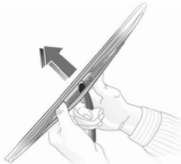
Dvignite brisalec. Iztaknite metlico brisalca, kot je prikazano na zgornji sliki, in jo odstranite.
