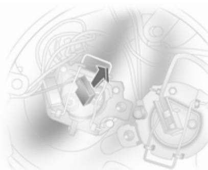
2. Z žarnice odklopite kabelski priključek.
