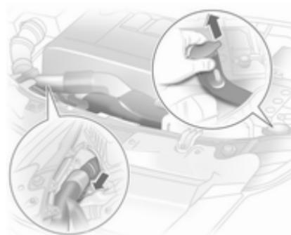
Pri menjavi žarnice na desni strani motornega prostora snemite zračno cev z zračnega filtra.
