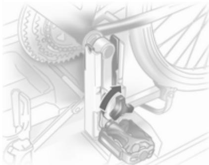
Pritrdite ojnicu pedala z obračanjem pritrdilnega vijaka na nastavku za ojnicu.
