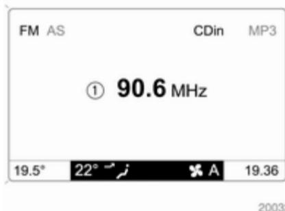
Podatki elektronske klimatske naprave so izpisani na Info-Display. Trenutno nastavljanje klimatske naprave se na kratko prikaže na Info-Display in prekrije ostale informacije na zaslonu.
