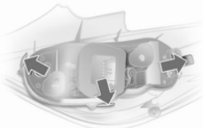
5. Narahlo pritisnite tri pritrtilne sponke ob stranicah nosilca žarnic navzven in nosilec z žarnicami izvlecite iz ohišja.
