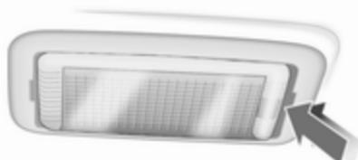
1. Luč iztaknite z izvijačem.
