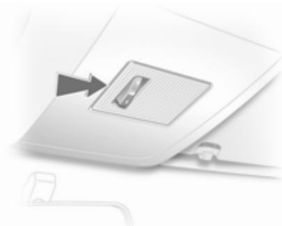
1. Iztaknите zaslонko z izvijačem na mestu, ki ga označuje zgornja slika.
