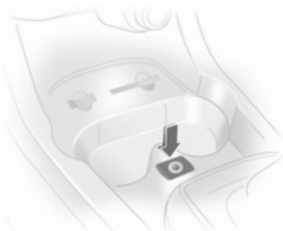
Dodatni avdio vir kot npr. prenosni CD predvajalnik lahko priklopite prek 3,5 mm vtikača na AUX vhod.
