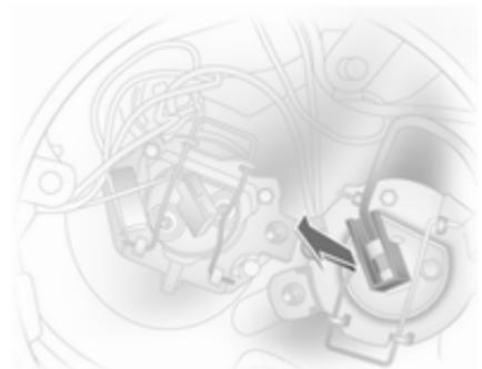
2. Z žarnice odklopite kabelski priključek.
