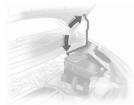
Zataknite podporno prečko.
