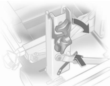
Sprostite zaklopec na diagonalni podporni prečki držala za pedalo in obe držali preklopite navzdol.
