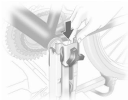
Vstavite nastavek za ojnicu pedala v držalo za pedalo od zgoraj in ga potisnite navzdol do blokade.
