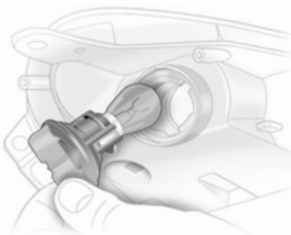
2. Žarnico rahlo pritisnite v nosilec, jo obrnite v levo in izvlecite ter vstavite novo žarnico.
