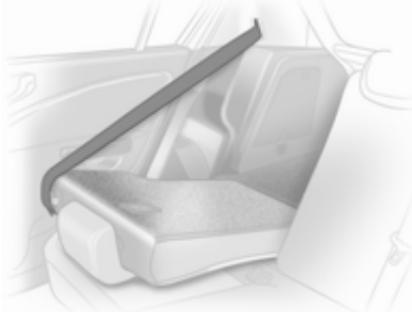
Sprostite sedežno naslonjalo (enojno ali dvojno) s pritiskom sprostitvenega vzvoda in ga spustite (preklopite) na sedež.
