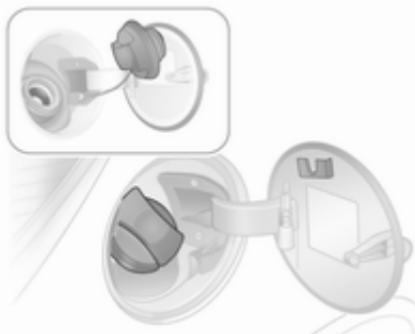
Odklenite pokrov rezervoarja goriva s ključem vozila, ga odvijte v levo in odstranite. Odvijte pokrov, ga snemite in zataknite na loputo.
