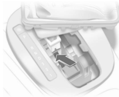
3. Z izvijačem potisnite rumeni zaklopec naprej in pretaknite izbirno ročico iz položaja P. Če pretaknete znova v P, se ročica ponovno blokira. Vzrok prekinitev napajanja dajte nemudoma odpraviti strokovnjakom v servisni delavnici.
