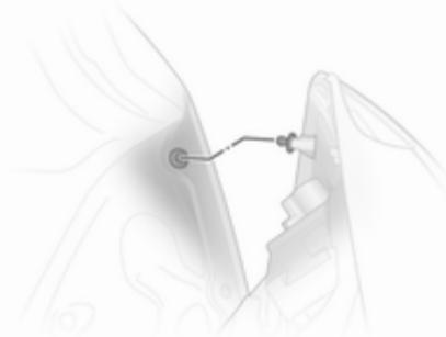
9. Ohišje luči pravilno namestite na svoje mesto na karoseriji in pritegnite pritrdilne matice z roko. Priklučite kabelski priključek. Zaprite pokrov.
