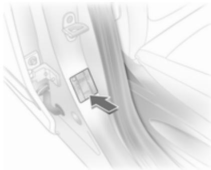
Tipska ploščica je pritrjena na okvir sprednjih desnih vrat - na stebru-B.
