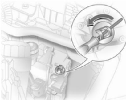
Če morate vozilo odmakniti s cestišča, odmaknite sklopko po sledečem:
