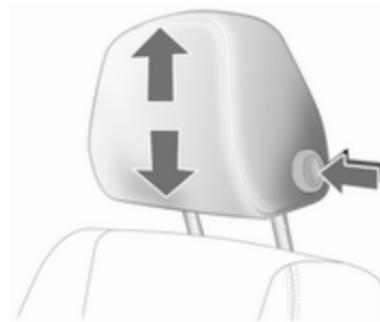
S pritiskom na gumb sprostite vzglavnik, nastavite višino in pustite, da se zaskoči v zavarovanem položaju.
