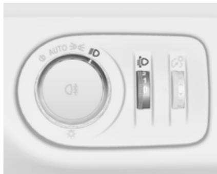
Za prilagoditev višine svetlobnega snopa, da ne slepite ostalih udeležencev v prometu: Obračajte gumb ⇠, dokler se na prikazovalniku prevoženih kilometrov ne pojavi želena nastavitev. Prikazovalnik označuje skupaj s simbolom ⇠ za
