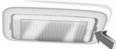
1. Luč iztaknite z izvijačem.
