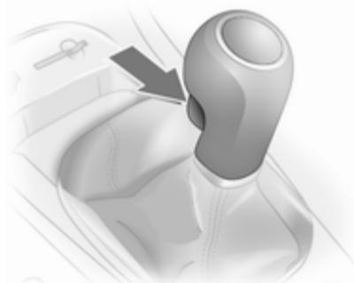
Vzvratna prestava: ko vozilo miruje, pritisnite pedal sklopke, tako počakajte 3 sekunde, pritisnite gumb na prestavnih ročicah in prestavite.
