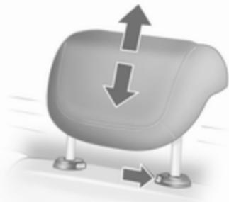
Višina zadnjih vzglavnikov je nastavljiva v dveh točkah. Za nastavitev v prvi položaj potegnite vzglavnik navzgor, za drugi položaj pritisnite vzemni gumb, označen na zgornji sliki in potisnite vzglavnik do konca navzgor. Za potisk vzglavnika navzdol pritisnite vzemni gumb, označen na zgornji sliki in potisnite vzglavnik navzdol.
