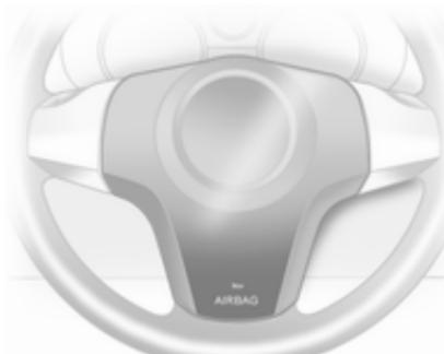
Varnostna meha s pirotehničnim polnilcem se nahajata v volanu in v armaturni plošči na desni strani. Označena sta z napisom **AIRBAG**.
