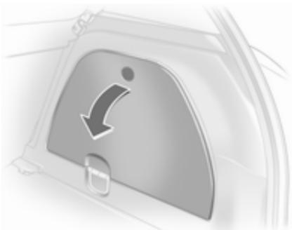
Komplet za popravilo pnevmatik se nahaja v prtljažniku v desnem stranskem predalu za spravljanje. Za odpiranje prostora iztaknite pokrov in ga odprite.
