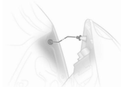
9. Ohišje luči pravilno namestite na svoje mesto na karoseriji in pritegnite pritrdilne matice z roko. Priključite kabelski priključek. Zaprite pokrov.
