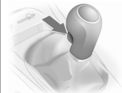
Za vklop vzvratne prestave: ko vozilo miruje, pritisnite pedal sklopke, tako počakajte 3 sekunde, pritisnite gumb na prestavni ročici in prestavite.
