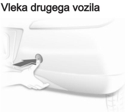
Iztaknite spodnji del pokrova in ga odstranite navzdol.
