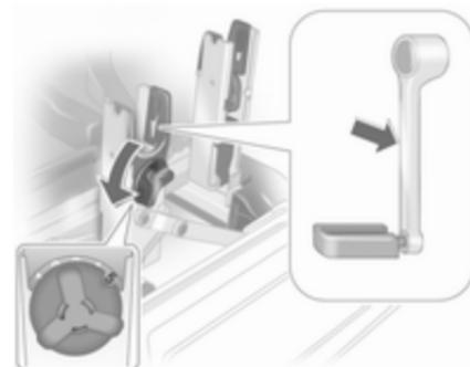
Z vrtljivo ročico na držalu pedala prilagodite nosilni vložek tipu (izstopanju) ojnice pedala primerno. V primeru koles z ravnimi ojnicami pedal obrnite vložek za pedal navzven (položaj 5).
