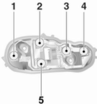
6. Žarnico rahlo pritisnite v nosilec, jo obrnite v levo in izvlecite ter vstavite novo žarnico.
