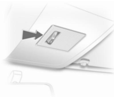
1. Iztaknите zaslонko z izvijačem na mestu, ki ga označuje zgornja slika.
