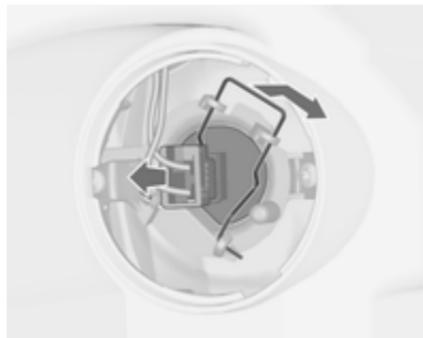
2. Z žarnice odklopite kabelski priključek.
