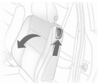
Privzdignite sprostilni vzvod in preklopite naslonjalo naprej. Spustite sprostilni vzvod in naslonjalo se zaskoči v prekopljenem položaju. Pomaknite sedež naprej.
