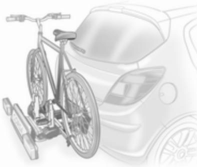
Zadnji nosilec (Flex-Fix sistem) omogoča nameščanje dveh koles na raztegljiv nosilec, ki je integriran v dnu vozila. Prevoz drugih stvari ni priporočljiv.
