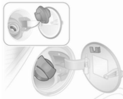
Odklenite pokrov rezervoarja goriva s ključem vozila. Odprete s počasnim sukanjem pokrovčka v levo. Odvijte pokrov, ga snemite in zataknite na loputo.
