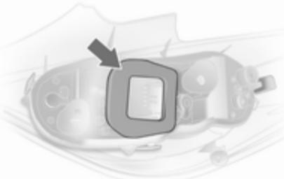
8. Pazite, da je tesnilo nosilca žarnic nameščeno tako, kot je prikazano na sliki. Na pritrdilni vijak namestite tesnilo.
