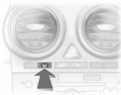
Po popravku tlaka v pnevmatikah ali po zamenjavi kolesa/pnevmatike morate sistem ponastaviti: Vključite kontakt, tipko **DDS** pridržite pritisnjeno približno 4 sekunde; kontrolna lučka utripte trikrat.
