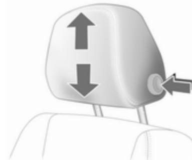
S pritiskom na gumb sprostite vzglavnik, nastavite višino in pustite, da se zaskoči v zavarovanem položaju.
