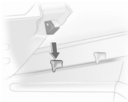
Za dviganje ostalih treh segmentov (zaporedje 2 do 4) - segment privzdignite na zadnjem delu, iztaknite, obrnite in odstranite.
