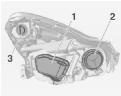
Žarometi imajo ločene sisteme za kratko luč 1 (zunanja žarnica), dolgo luč 2 (notranja žarnica) in dnevno luč/stransko luč 3.
