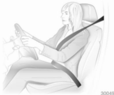
Izvlecite varnostni pas in ga zataknite v zaklep. Bočni del pasu ne sme biti zvit na nobenem delu in se mora tesno prilegati k telesu. Naslonjalo naj ne bo nagnjeno preveč nazaj (priporočen kot nagiba: največ 25°). Pas odpnete s pritiskom na rdečo tipko na zaklepnu.
