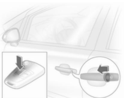
Obrnite ključ v ključavnici voznikovih vrat proti sprednjemu delu vozila ali pa pritisnite tipko
