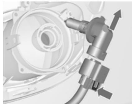
2. Nosilec z žarnico razvlecite s kabelskega priključka s pritiskom pritrdilne zaponke.
