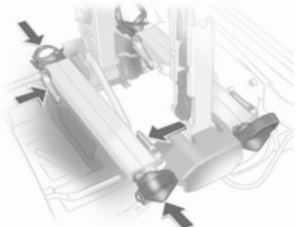
Pritisnite sprostiljeni vzvod in potisnite pritrdilna vodila za zračnice do blokade.
