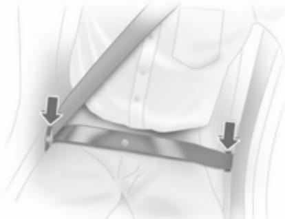
V primeru trčenja – od spredaj ali od zadaj – se zaklep pasu pomakne navzdol, bočni in ramenski del pasu se v trenutku napneta.
