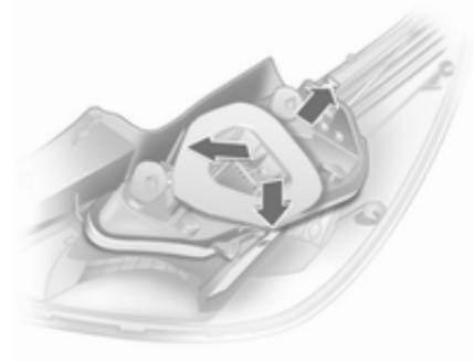
5. Narahlo pritisnite tri pritrdilne sponke ob stranicah nosilca žarnic navzven in nosilec z žarnicami izvlecite iz ohišja.
