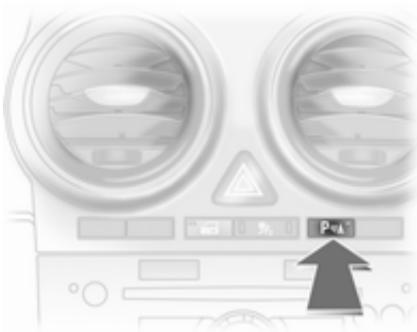
Če je vozilo opremljeno s tipko **P**▲, lahko sistem izključite s pritiskom na to tipko.
