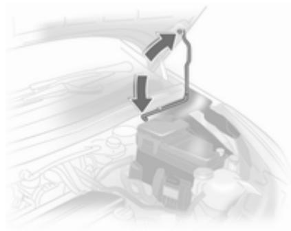
Zataknite podporno prečko.
