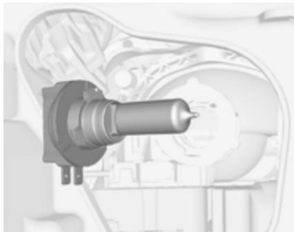
3. Novo žarnico z nosilcem vstavite v žaromet tako, da se jezička na nosilcu žarnice ujemata z odprtinama na žarometu.
