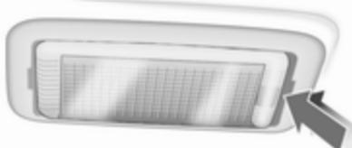
1. Luč iztaknite z izvijačem.
