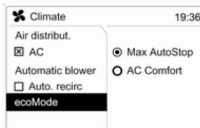
Pri vozilih s stop-start sistemom sta med funkcijo Autostop na razpolago dva režima delovanja klimatske naprave.
