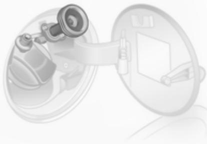
**Adapter ACME:** Privijte matico točilne pištote na adapter. Pritisnite navzdol varovalno ročico na točilni pištoli.
