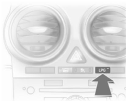
Po pritisku na tipko **LPG** se preklop med bencinskim in plinskim pogonom izvrši, takoj ko so izpolnjeni zahtevani pogoji (temperatura hladilne tekočine, temperatura plina in minimalno število vrtljavjev motorja). Ti pogoji so običajno izpolnjeni po približno 60 sekundah (odvisno od zunanjih temperature) in prvem odločnejšem pritisku na pedal za plin. Stanje LED lučk opozarja na trenutni način delovanja.
