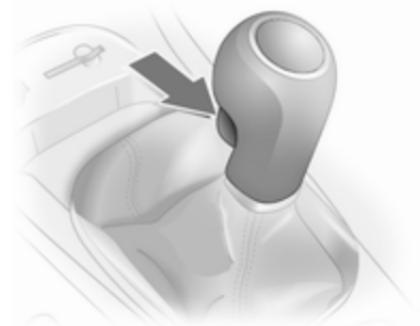
Vzvratna prestava: ko vozilo miruje, pritisnite pedal sklopke, tako počakajte 3 sekunde, pritisnite gumb na prestavnih ročicah in prestavite.
