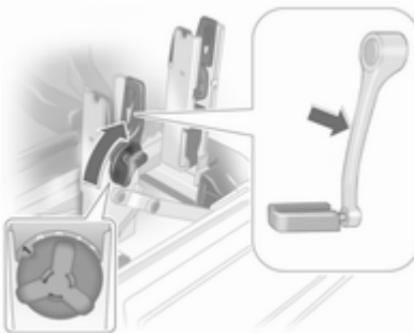
V primeru koles z izbočenimi ojnicami pedal obrnite vložek za pedal navznoter (položaj 1).
