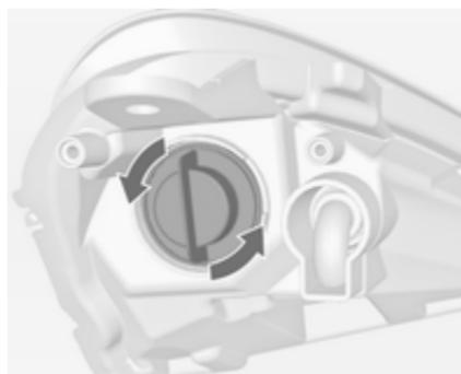
1. Nosilec žarnice **3** obrnite v obratno smer urinega kazalca. Iz žarometa izvlecite nosilec z žarnico stranske luči.
