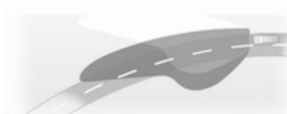
Zgubi žarometov se obračajo v odvisnosti od zavoja volana in hitrosti vozila za boljšo osvetlitev zavojev.
