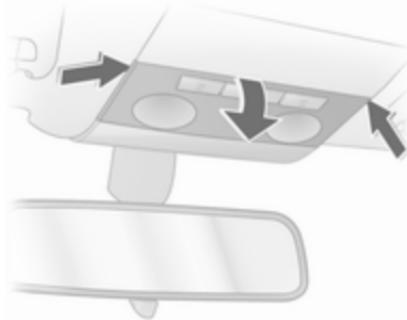
1. Iztaknite zaslonko iz ohišja luči z rokami, jo preklopite previdno navzdol in v tem položaju odstranite.
