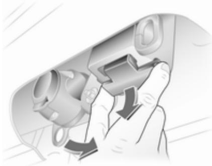
Iztaknite električni priključek za prikolico in ga preklopite navzdol. Iz odprtine za vlečno kljuko izvlecite tesnilni čep in ga pospravite v prtljažnik.
