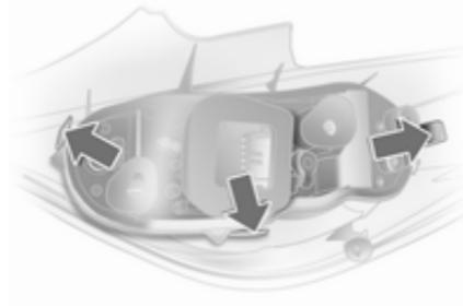
5. Narahlo pritisnite tri pritrdilne sponke ob stranicah nosilca žarnic navzven in nosilec z žarnicami izvlecite iz ohišja.
