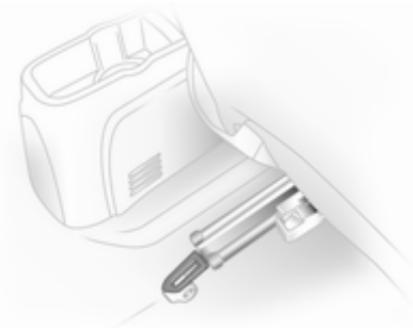
Simboli na stropni prevleki zadnjih stebrov in na vpenjalnih točkah označujejo pritrdilna ušesca za otroške varnostne sedeže.
