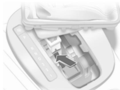
3. Z izvijačem potisnite rumeni zaklopec naprej in pretaknite izbirno ročico iz položaja P. Če pretaknete znova v P, se ročica ponovno blokira. Vzrok prekinitev napajanja dajte nemudoma odpraviti strokovnjakom v servisni delavnici.
