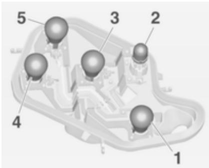
6. Žarnico rahlo pritisnite v nosilec, jo obrnite in levo in izvlecite ter vstavite novo žarnico.
