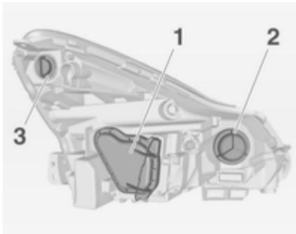
Žarometi imajo ločene sisteme za kratko in dolgo luč 1 (zunanja žarnica), smernik 2 (notranja žarnica) in dnevno luč/stransko luč 3.
