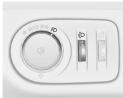
Za prilagoditev višine svetlobnega snopa, da ne slepite ostalih udeležencev v prometu: Obračajte gumb ⇧, dokler se na števcu prevoženih kilometrov ne prikaže želena nastavitev.
