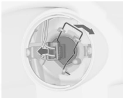
2. Z žarnice odklopite kabelski priključek.
