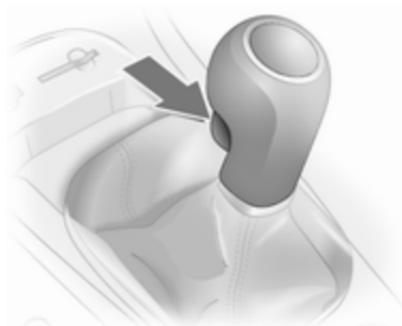
Za vklop vzvratne prestave: ko vozilo miruje, pritisnite pedal sklopke, tako počakajte 3 sekunde, pritisnite gumb na prestavni ročici in prestavite.
