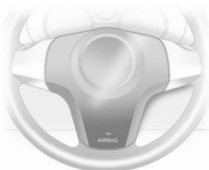
Varnostna meha s pirotehničnim polnilcem se nahajata v volanu in v armaturni plošči na desni strani. Označena sta z napisom **AIRBAG**.
