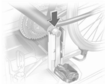
Postavite kolo na nosilec. Ojnice pedala vstavite v odprtino v držalu za pedalo, kot je prikazano na zgornji sliki.
