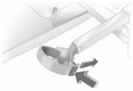
Vstavite nosilec jermina in ga potisnite do konca navzdol.
