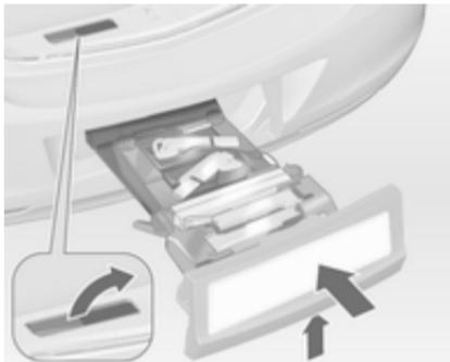
Potisnite zaklepni vzvod navzgor in zadržite. Sistem rahlo dvignite in ga potisnite v odbijač, da se zaskoči.
