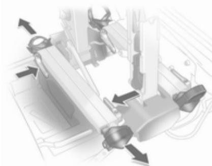
Pritisnite sprostilni vzvod in izvlecite pritrdilna vodila za zračnico.
