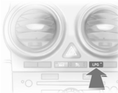
S pritiskom gumba **LPG** preklapljamte med pogonom na bencin in pogonom na utekočinjen naftni plin. Stanje LED-lučk opozarja na trenutni način delovanja.
