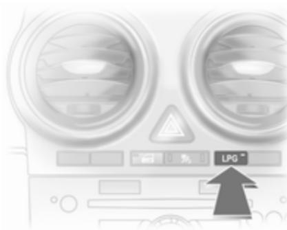
Po pritisku na tipko **LPG** se preklop med bencinskim in plinskim pogonom izvrši, takoj ko so izpolnjeni zahtevani pogoji (temperatura hladilne tekočine, temperatura plina in minimalno število vrtljajev motorja). Ti pogoji so običajno izpolnjeni po približno 60 sekundah (odvisno od zunanje temperature) in prvem odločnejšem pritisku na pedal za plin. Stanje LED lučk opozarja na trenutni način delovanja.
