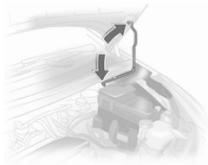
Zataknite podporno prečko.
