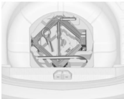
Izvedba 1: Dvigalka in orodje sta spravljena v prtljažniku pod rezervnim kolesom. Nalepka na dvigalki označuje vozila, za katera je predvidena.
