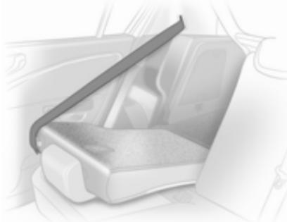
Sprostite sedežno naslonjalo (enojno ali dvojno) s pritiskom sprostitvenega vzvoda in ga spustite (preklopite) na sedež.
