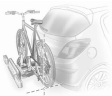
Kolo namestite longitudinalno glede na vozilo: Popustite vijak nastavka za ojnicico pedala.
