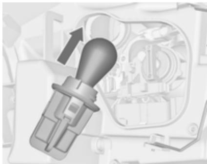
3. Žarnico rahlo pritisnite v nosilec, jo obrnite v levo in izvlecite.
