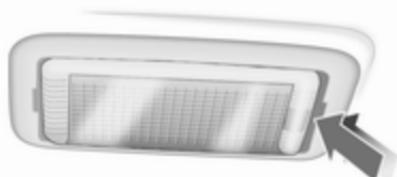
1. Luč iztaknite z izvijačem.
