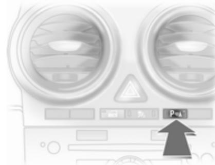
Če je vozilo opremljeno s tipko P $\Delta$ , lahko sistem izključite s pritiskom na to tipko.
