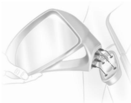
Corsa OPC: Zaradi varnosti pešcev se zunanjji ogledali pri modelu Corsa OPC ob trku z ustreznim visoko silo sprostita iz nosilca. Ogledalo ponovno namestite v nosilec: zatičte vstavite v odprite in pritrdite ogledalo z rahlim udarcem.
