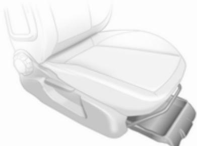
S prijemom izdolbljenega robu privzdignite predal in ga potegnite naprej. Maksimalna nosilnost: 1,5 kg. Zapiranje predala: potisnite ga pod sedež, da se zatakne.
