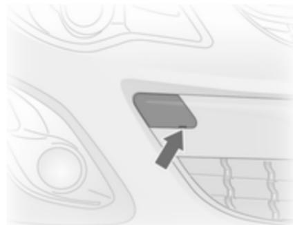
Vstavite primeren izvijač v spodnjo režo pokrova. Odpnite pokrov s previdnim pomikom izvijača navzdol.
