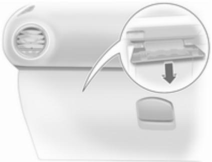
Pri vozilih z volantom na desni strani se škatla z varovalkami nahaja za pokrovom v sovoznikovem predalu. Odprite predal in odstranite pokrov. Zapiranje: namestite pokrov in ga zataknite v pravilen položaj.
