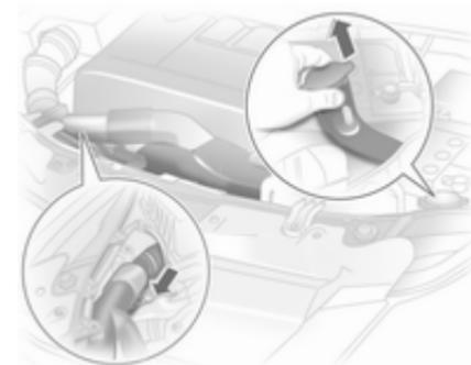
Pri menjavi žarnice na desni strani motornega prostora snemite zračno cev z zračnega filtra.
