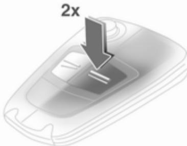
Pritisnite tipko **=** še enkrat v 10 sekundah po odklepanju.
