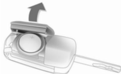
Pritisnite gumb, da izskoči ključeva brada in odprite ključ. Zamenjajte baterijo (tip baterije CR 2032). Pazite na pravilno vstavitev nove baterije. Zaprite daljinski upravljalnik in ga sinhronizirajte.
