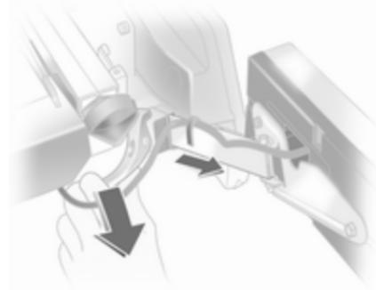
Zaklopec potisnite navzdol in potegnite oba nosilca luči iz sidrišč.
