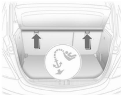
Odvisno od deželne različice opreme ima vozilo lahko dva ali tri pritrdilne obročke. Pritrdite Top-Tether otroški varnostni sedež na pritrdilna ušesca na hrbtni strani zadnjih sedežnih naslonjal in v zadnjem predelu nog poleg pritrdilnih vodil sovoznikovega sedeža. Pas mora potekati pod vzglavnikom med njegovima prečkama.
