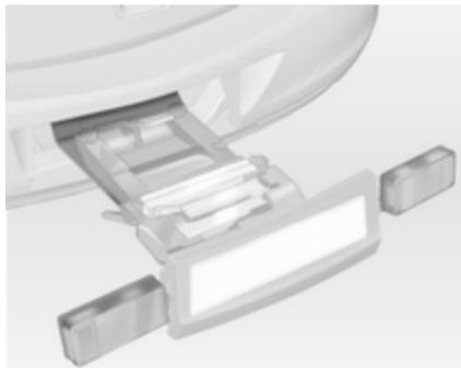
Preverite položaj ožičenja in luči, ali so pravilno nameščene in zavarovane.
