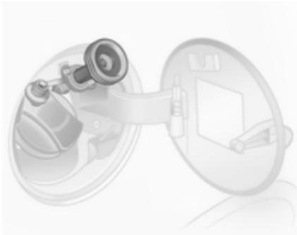
**Adapter ACME:** Privijte matico točilne pištote na adapter. Pritisnite navzdol varovalno ročico na točilni pištoli.
