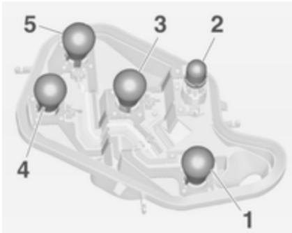
6. Žarnico rahlo pritisnite v nosilec, jo obrnite v levo in izvlecite ter vstavite novo žarnico.
