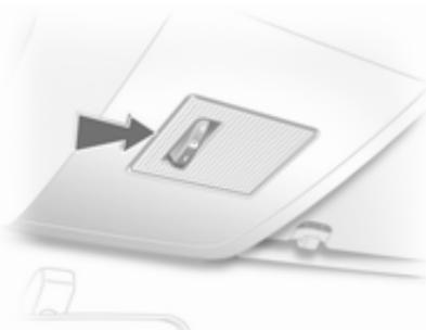
1. Iztaknите zaslonko z izvijačem na mestu, ki ga označuje zgornja slika.
