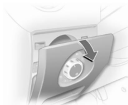
Pri vozilih z volanom na levi strani je škatla z varovalkami nameščena za stikalom luči. Potegnite zgornji rob panela in ga preklopite navzdol.
