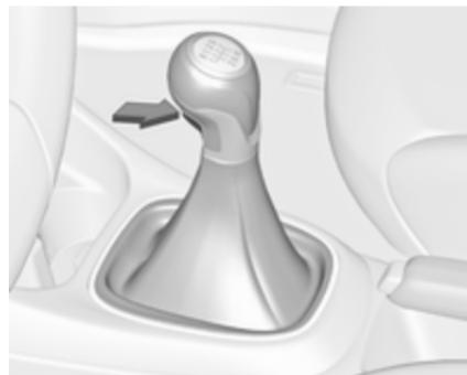
Za vklop vzvratne prestave pritisnite pedal sklopke, pritisnite sprostivni gumb na izbirni ročici in prestavite.
