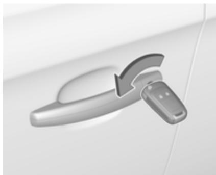
Odklenite voznikova vrata z obratom ključa v ključavnici. Vključite kontakt in pritisnite stikalo
