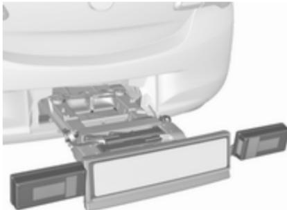
Preverite položaj ožičenja in luči, ali so pravilno nameščene in zavarovane.
