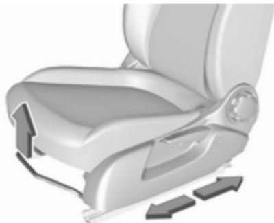
Potegnite ročico, pomaknite sedež, sprostite ročico. Pustite, da se sedež zaskoči v položaju.
