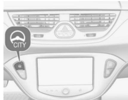
Medtem ko teče motor, pritisnite tipko . Sistem deluje od mirovanja do hitrosti 35 km/h in v vzvratni prestavi. Po prekoračitvi te hitrosti sistem preklopi v normalni način. Če je mestni način vključen, se samodejno vklopi pri hitrosti pod 35 km/h.
