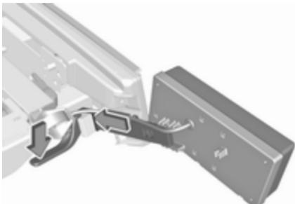
Zaporno ročico potisnite navzdol in potisnite nosilec luči v držalo, dokler se ne zaskoči.
