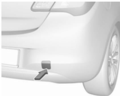
Vstavite izvijač v spodnjo režo pokrova. Odprite pokrov s previdnim pomikom izvijača navzdol.
