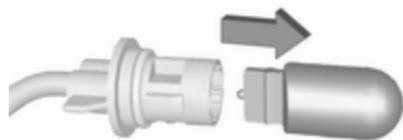
3. Žarnico izvlecite iz nosilca in vstavite novo.
