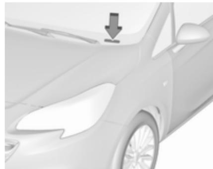
Identifikacijska številka vozila je lahko vtisnjena na instrumentni plošči in je vidna skozi vetrobransko steklo ali v motornem prostoru, na desni steni karoserije.
