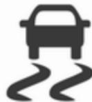
ESC je pripravljen za delovanje po zagonu motorja, potem ko ugasne kontrolna lučka .
