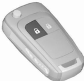
Za odklepanje vrat ter prtljažnika pritisnite tipko . Odprite vrata s potegom kljuke na vratih.
