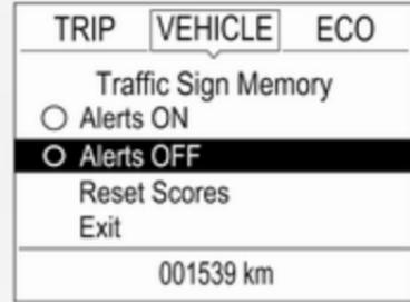
Ko se prikaže nastavitevna stran, izberite **Alert ON**, da vklopite pojavnega opozorila. Izklopite jih tako, da izberete **Alert OFF**. Pri vklopu vžiga je funkcija opozoril izključena.
