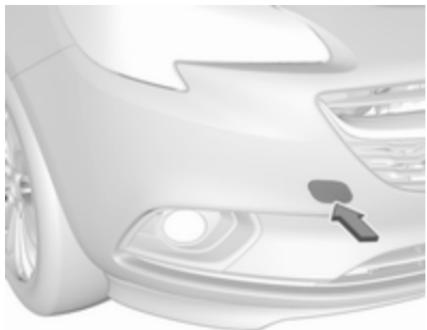
Vstavite izvijač v spodnji del pokrova.
