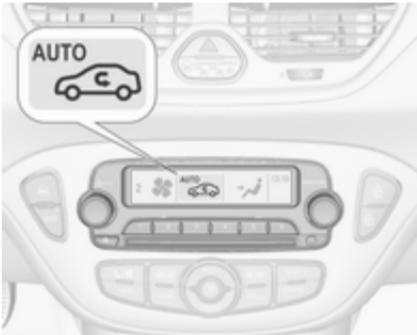
Nastavitev klimatske naprave so prikazane na informacijskem zaslonu. Spremenjene nastavitev se za hip pojavijo na zaslonu preko trenutno dejavnega menija.
