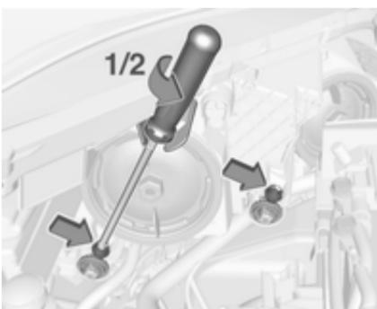
Na vsakem ohišju žarometa sta dva nastavitvena elementa.
