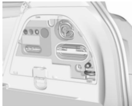
Pri različicah z nosilcem na zadku vozila ali dvojnim tovornim dnem se orodje nahaja na desni strani prtljažnika za pokrovom, vključno z vlečnim ušesom in kompletom za popravilo pnevmatik.
