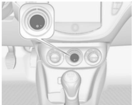
Za vklop hlajenja pritisnite tipko ☀. Vklop signalizira LED lučka v stikalu. Hlajenje deluje samo, kadar teče motor in je vklučen ventilator sistema za ogrevanje, prezračevanje, hlajenje.
