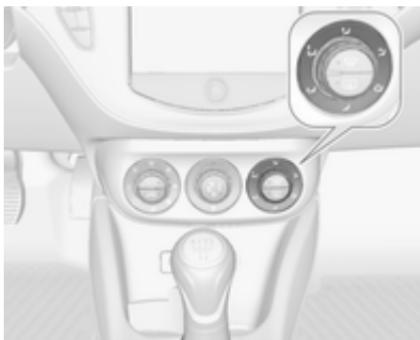
Za želeno nastavitev vrtite desni vrtljivi gumb. Nastavitev je prikazana na informacijskem zaslonu.
