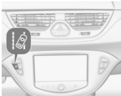
Sistem za opozorilo o nenamerni menjavi vozneg pasu se aktivira s pritiskom gumba . LED v stiku označuje, da je sistem vklojen. Kadar kontrolna lučka na instrumentni tabli sveti zeleno, je sistem pripravljen na delovanje.
