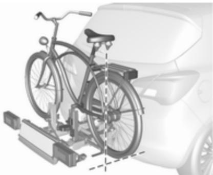
Kolo namestite longitudinalno glede na vozilo: Popustite vijak nastavka za ojnicu pedala.
