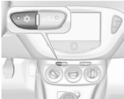
Za vklop hlajenja pritisnite tipko ☀. Vklop signalizira LED lučka v stikalu. Hlajenje deluje samo, kadar teče motor in je vključen ventilator sistema za ogrevanje, prezračevanje, hlajenje.
