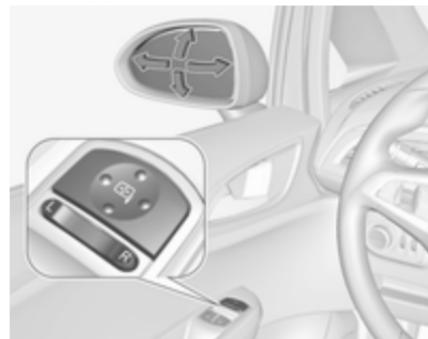
Izberite želeno zunanje ogledalo s pritiskom prevesnega stikala v levo (L) ali desno (R). Za nastavitev ogledala pomaknite
