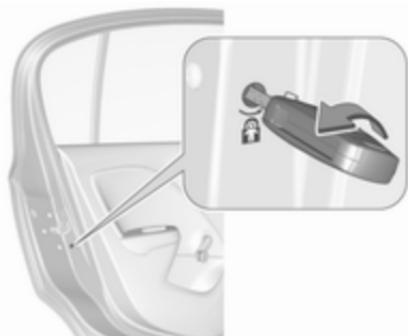
Zaklep na zadnjih vratih obrnite s ključem ali izvijačem v vodoravni položaj. Vrat od znotraj ni mogoče odpreti.
