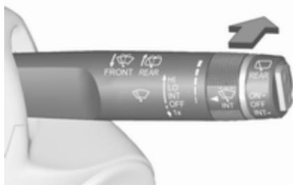
Potisnite ročično stikalo naprej. Šoba poškropi zadnje steklo, obenem brisalec nekajkrat obriše steklo.
