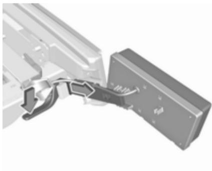
Zaklopeč potisnite navzdol in potegnite oba nosilca luči iz sidrišč.
