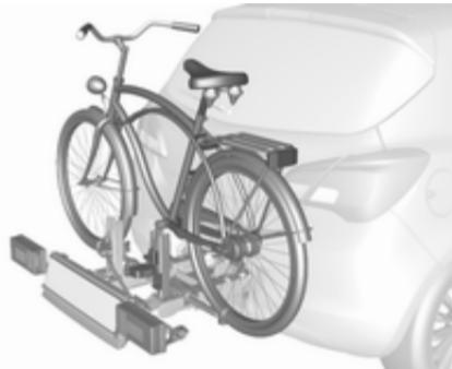
Zadnji nosilec (Flex-Fix sistem) omogoča nameščanje dveh koles na raztegljiv nosilec, ki je integriran v dnu vozila. Prevoz drugih stvari ni priporočljiv.
