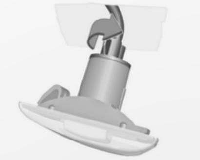
2. Obrnite držalo žarnice na levo in ga odstranite iz ohišja.
