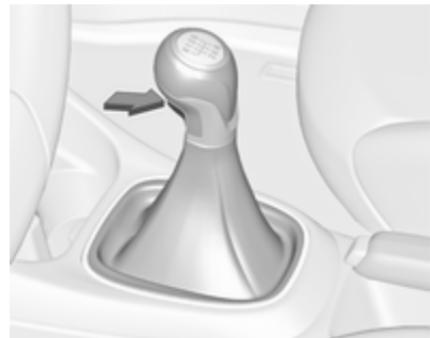
Vzvratna prestava: ko vozilo miruje, pritisnite pedal sklopke, nato pritisnite gumb na prestavnih ročicah in prestavite.
