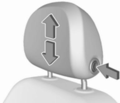
S pritiskom gumba sprostite vzglavnik, nastavite višino in pustite, da se zaskoči v zavarovani položaj.
