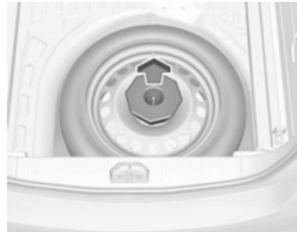
Odstranite distančnik nad rezervni kolesom, dvignite rezervno kolo, postavite ga v navpični položaj in ga izvlecite navzgor.
