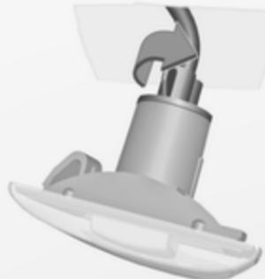
2. Obrnite držalo žarnice na levo in ga odstranite iz ohišja.
