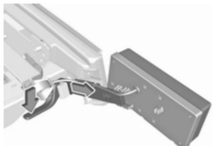
Zaklopec potisnite navzdol in potegnite oba nosilca luči iz sidrišč.
