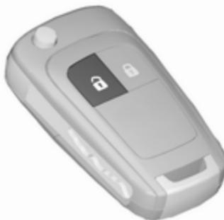
Za odklepanje vrat ter prtljažnika pritisnite ①. Odprite vrata s potegom kljuke na vratih.
