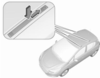
Pokrovčke strešnih nosilcev potisnite navzdol in nazaj s ključem za pokrovčke ventilov ⇨ 217.
