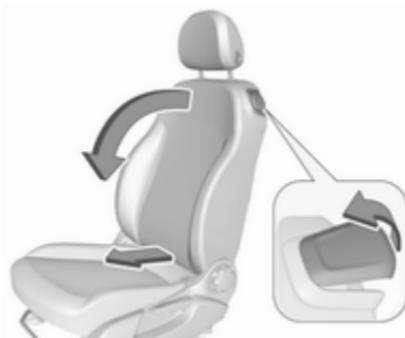
Potegnite sprostilno ročico naprej in preklopite naslonjalo naprej. Nato potisnite sedež naprej do omejevala.
