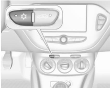
Za vklop hlajenja pritisnite ☀. LED dioda v gumbu sveti in s tem označuje vključeno stanje. Hlajenje deluje samo, kadar teče motor in je vključen ventilator sistema za ogrevanje, prezračevanje, hlajenje.
