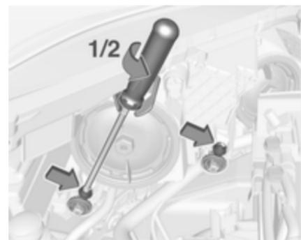
Na vsakem ohišju žarometa sta dva nastavljiva elementa.
