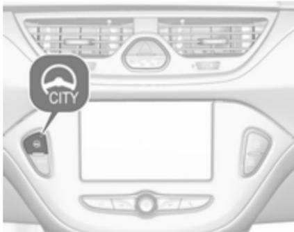
Medtem ko teče motor, pritisnite . Sistem deluje od mirovanja do hitrosti 35 km/h in tudi v vzvratni prestavi. Po prekoračitvi te hitrosti sistem preklopi v normalni način. Če je mestni način vključen, se samodejno vklopi pri hitrosti pod 35 km/h.
