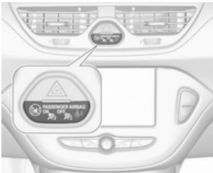
Če kontrolna lučka ⚡ po vključitvi kontakta vžiga svetl pribl. 60 sekund, je sistem varnostnih blazin na sovoznikovi strani aktiven in se bo v primeru trka sprožil.
