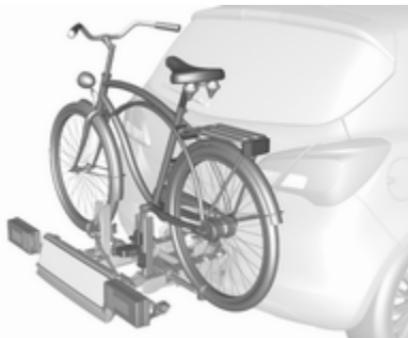
Nosilec na zadku vozila (sistem Flex-Fix) omogoča nameščanje koles na raztegljivi nosilec, ki je vgrajen v dno vozila. Prevoz drugih stvari ni priporočljiv.
