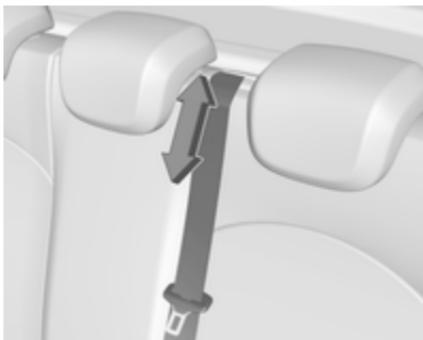
Varnostni pas sredinskega sedeža se lahko blokira, če so naslonjala prehitro preklopljena navzgor. Za deblokiranje navijalca potisnite pas v ali pa ga povlecite iz navijalca pribl. 20 mm ter ga sprostite.
