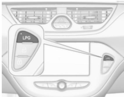
Po pritisku **LPG** se preklop med bencinskim in plinskim pogonom izvrši, takoj ko so izpolnjeni zahtevani pogoji (temperatura hladilne tekočine, temperatura plina in minimalno število vrtljajev motorja). Ti pogoji so običajno izpolnjeni po približno 60 sekundah (odvisno od zunanjega temperature) in prvem odločnejšem pritisku na pedal za plin. Stanje LED lučk opozarja na trenutni način delovanja.
