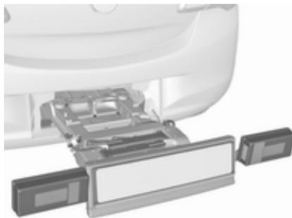
Preverite položaj ožičenja in luči in zagotovite, da so pravilno nameščene in zavarovane.
