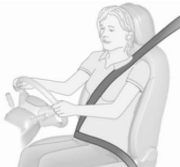
Izvlecite varnostni pas in ga zataknite v zaklep. Bočni del pasu ne sme biti zvit na nobenem delu in se mora tesno prilegati k telesu. Naslonjalo naj ne bo nagnjeno preveč nazaj (priporočen kot nagiba: največ 25°).
