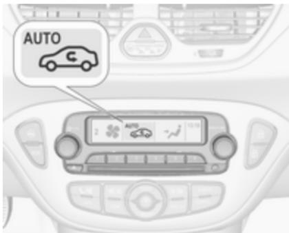
Nastavite klimatske naprave so prikazane na informacijskem zaslonu. Spremenjene nastavitev se za hip pojavijo na zaslonu preko trenutno dejavnega menija.
