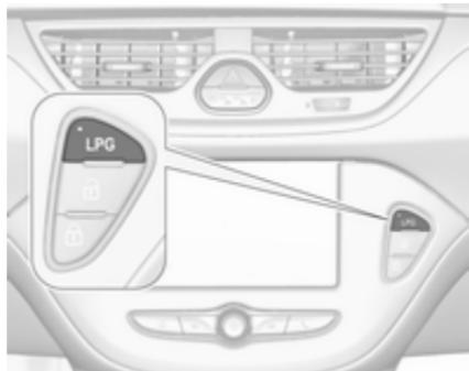
Pritisnite **LPG** za preklapljanje med pogonom na bencin in pogonom na utekočinjen naftni plin. Trenutni način delovanja označuje LED dioda v tipki.
