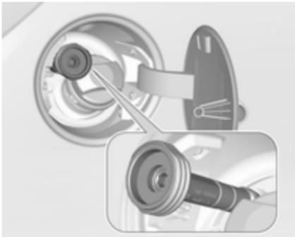
**Adapter ACME:** Privijte matico točilne pištoli na adapter. Pritisnite navzdol varovalno ročico na točilni pištoli.
