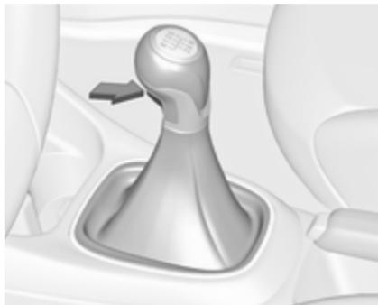
Vzvratna prestava: ko vozilo miruje, pritisnite pedal sklopke, nato pritisnite gumb na prestavnih ročicah in prestavite. Če ni možno prestaviti v vzvratno prestavo, ponovno pomaknite ročico v prosti tek, sprostite in še enkrat pritisnite pedal sklopke ter nato ponovno prestavite v vzvratno prestavo.
