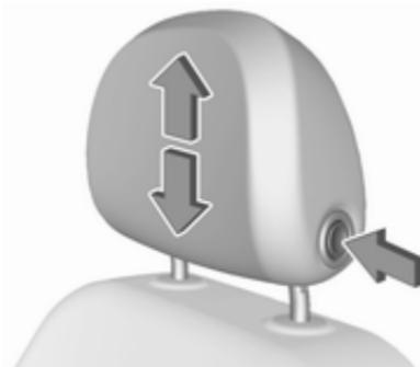
S pritiskom gumba sprostite vzglavnik, nastavite višino in pustite, da se zaskoči v zavarovan položaj.
