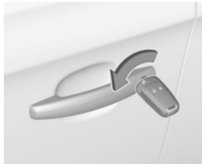
Odklenite voznikova vrata z obratom ključa v ključavnici. Vključite kontakt in pritisnite stikalo za odklepanje vseh ostalih vrat, prtljažnika in lopute rezervoarja goriva.
