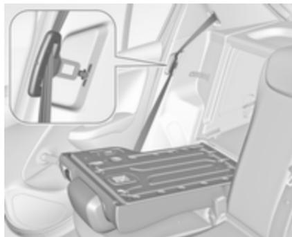
Če nameravate natovarjati vozilo skozi zadnja vrata, iztaknite varnostni pas iz vodila naslonjala in vstavite zaponko v odprtino, kot prikazuje slika.
