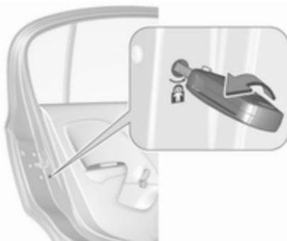
Zaklep na zadnjih vratih obrnite s ključem ali izvijačem v vodoravni položaj. Vrat od znotraj ni mogoče odpreti.
