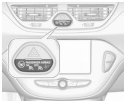
Če kontrolna lučka ☹️ po vključitvi kontakta vžiga sveti pribl. 60 sekund, je sistem varnostnih blazin na sovoznikovi strani aktiven in se bo v primeru trka sprožil.
