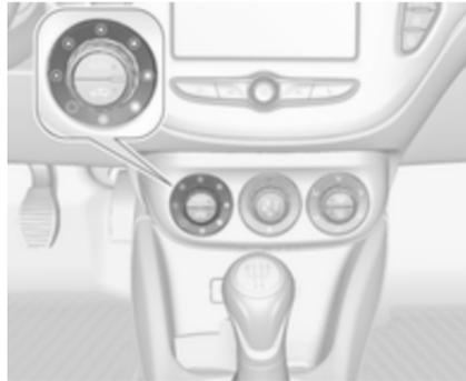
Za zmanjšanje ali povečanje hitrosti ventilatorja vrtite levi vrtljivi gumb. Hitrost ventilatorja je prikazana na informacijskem zaslonu.
