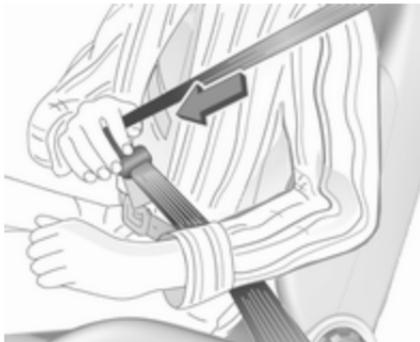
Enakomerno potegnite pas iz navijalca, ga nezvitega namestite čez telo in vstavite zaponko v zaklep, da se slišno zaskoči. Med vožnjo si pas na diagonalnem delu večkrat zategnite.
