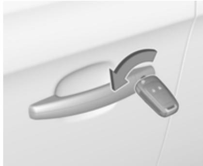
Odklenite voznikova vrata z obratom ključa v ključavnici. Vključite kontakt in pritisnite stikalo
