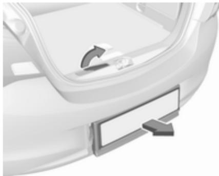
Potegnite zaklepni vzvod navzgor. Sistem se sprostí in izskočí iz odbijača.
