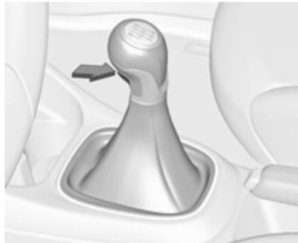
Za vklop vzratne prestave pritisnite pedal sklopke, pritisnite sprostivni gumb na izbirni ročici in prestavite.
