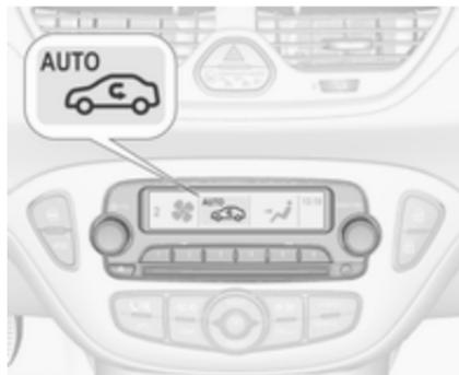
Nastavitve klimatske naprave so prikazane na informacijskem zaslonu. Spremenjene nastavitve se za hip pojavijo na zaslonu preko trenutno dejavnega menija.
