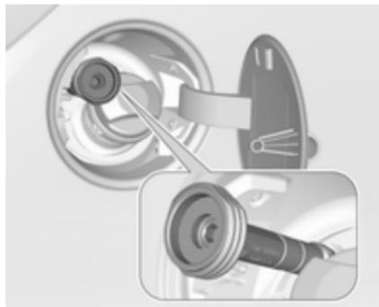
**Adapter ACME:** Privijte matico točilne pištole na adapter. Pritisnite navzdol varovalno ročico na točilni pištoli.
