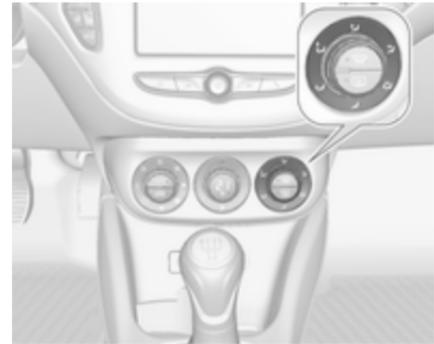
Za želeno nastavitev vrtite desni vrtljivi gumb. Nastavitev je prikazana na informacijskem zaslonu.
