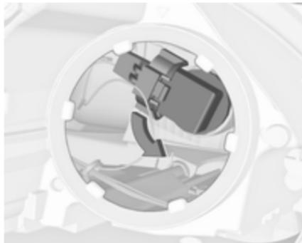
2. Nosilec žarnice obrnite v obratno smer urinega kazalca. Izvlecite nosilec z žarnico iz žarometu.
