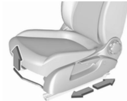
Potegnite ročico, pomaknite sedež, sprostite ročico. Sedež poskušajte pomakniti naprej in nazaj, da preverite, ali je pritrjen v ustreznem položaju.
