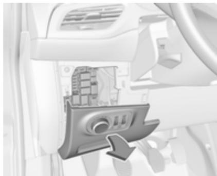
Škatla z varovalkami je za stikalom za luči v armaturni plošči. Primite ročaj, nato povlecite stikalom luči in ga preklopite navzdol.
