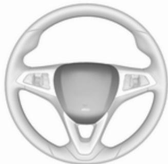
Sprednja varnostna meha se sprožita v primeru čelnega trka z določeno silo. Kontakt mora biti za to vključen.
