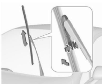
Dvignite ročico brisalca, da ostane v dvignjenem položaju. Pritisnite zaponki na obeh straneh, nagnite metlico brisalca pod kotom 90° na ročico brisalca in jo odstranite v smeri navzgor.
