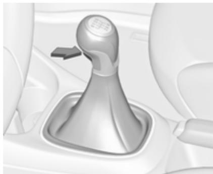
Vzratna prestava: ko vozilo miruje, pritisnite pedal sklopke, nato pritisnite gumb na prestavni ročici in prestavite.
