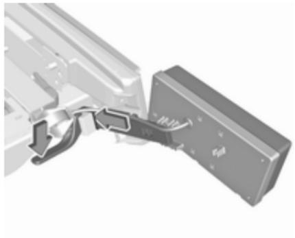
Zaporno ročico potisnite navzdol in potisnite nosilec luči v držalo, dokler se ne zaskoči.
