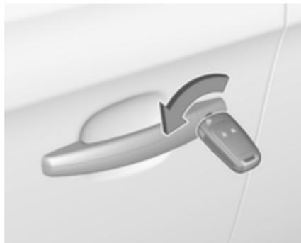
Odklenite voznikova vrata z obratom ključa v ključavnici. Vključite kontakt in pritisnite stikalo
