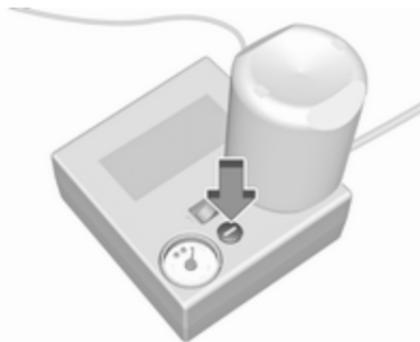
Če predpisan tlak ni dosežen v roku 10-ih minut, odstranite komplet za popravilo pnevmatik. Premaknite vozilo za en obrat kolesa. Ponovno priklopite komplet za popravilo pnevmatik in nadaljujte s postopkom polnjenja pnevmatike še dodatnih 10 minut.
