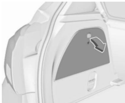
1. Sprostite pokrov v prtljažniku na ustrezni strani in ga odstranite. Odstranite vse dele, npr. komplet za popravilo pnevmatik in orodje, iz zadnjega predala. Stisnite ta vložek na zgornji strani in ga odstranite z bočne stene.
