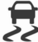
ESC je pripravljen za delovanje po zagonu motorja, potem ko ugasne kontrolna lučka
