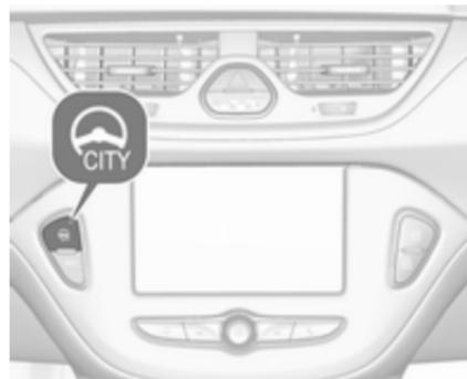
Medtem ko teče motor, pritisnite
