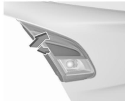
2. Sklop luči premaknite nekoliko navzven in ga nato odstranite iz vrat v prtlačniku.
