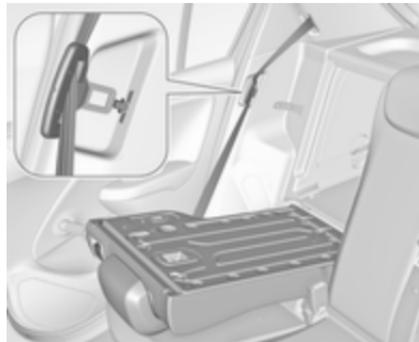
Če nameravate natovarjati vozilo skozi zadnja vrata, iztahnite varnostni pas iz vodila naslonjala in vstavite zaponko v odprtino, kot prikazuje slika.
