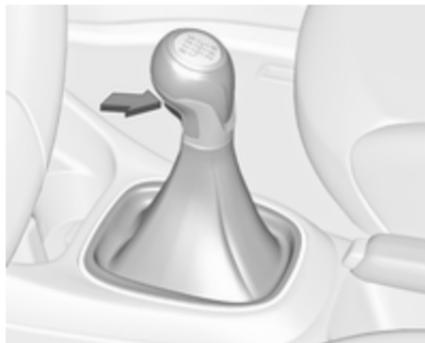
Za vklop vzratne prestave pritisnite pedal sklopke, pritisnite sprostitveni gumb na izbirni ročici in prestavite.
