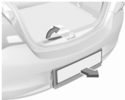
Potegnite zaklepni vzvod navzgor. Sistem se sprosti in izskoči iz odbijača.
