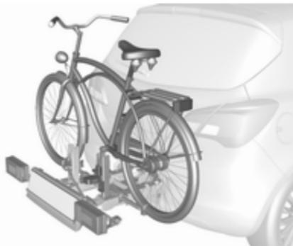
Nosilec na zadku vozila (sistem Flex-Fix) omogoča nameščanje koles na raztegljivi nosilec, ki je vgrajen v dno vozila. Prevoz drugih stvari ni priporočljiv.
