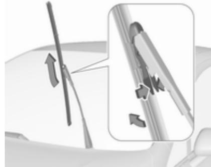
Dvignite ročico brisalca, da ostane v dvignjenem položaju. Pritisnite zaponki na obeh straneh, nagnite metlico brisalca pod kotom 90° na ročico brisalca in jo odstranite v smeri navzgor.
