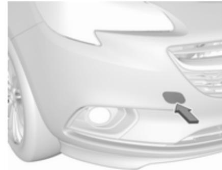
Okoli konice ploskega izvijača ovijte krpo, da preprečite poškodbo laka. Vstavite izvijač v spodnji del pokrova. Odnite pokrov s previdnim pomikom izvijača navzdol.
