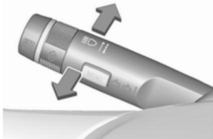
Preklop s kratkih na dolge luči: stikalno ročico potisnite naprej.
