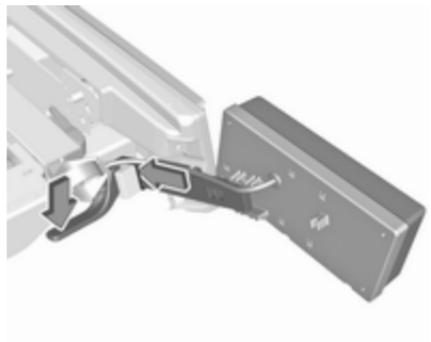
Zaporno ročico potisnite navzdol in potisnite nosilec luči v držalo, dokler se ne zaskoči.
