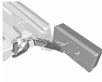
Zaklopec potisnite navzdol in potegnite oba nosilca luči iz sidrišč.
