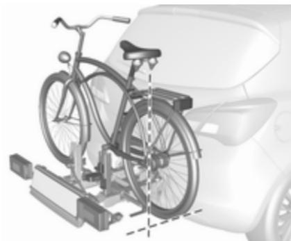
Kolo namestite longitudinalno glede na vozilo: Popustite vijak nastavka za ojnico pedala.
