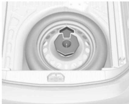
Odstranite distančnik nad rezervni kolesom, dvignite rezervno kolo, postavite ga v navpični položaj in ga izvlecite navzgor.
