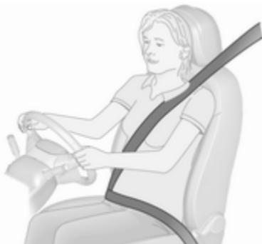
Izvalcite varnostni pas in ga zatakните v zaklep. Bočni del pasu ne sme biti zviti na nobenem delu in se mora tesno prilagati k telesu. Naslonjalo naj ne bo nagnjeno preveč nazaj (priporočen kot nagiba: največ 25°).
