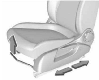
Potegnite ročico, pomaknite sedež, sprostite ročico. Sedež poskušajte pomakniti naprej in nazaj, da preverite, ali je pritrjen v ustreznem položaju.
