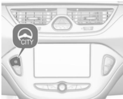
Medtem ko teče motor, pritisnite
