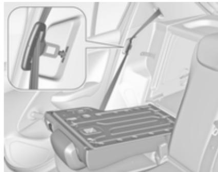
Če nameravate natovarjati vozilo skozi zadnja vrata, iztaknite varnostni pas iz vodila naslonjala in vstavite zaponko v odprtino, kot prikazuje slika.
