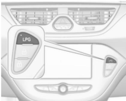
Po pritisku **LPG** se preklop med bencinskim in plinskim pogonom izvrši, takoj ko so izpolnjeni zahtevani pogoji (temperatura hladiilne tekočine, temperatura plina in minimalno število vrtljajev motorja). Ti pogoji so običajno izpolnjeni po približno 60 sekundah (odvisno od zunanje temperature) in prvem odločnejšem pritisku na pedal za plin. Stanje LED lučk opozarja na trenutni način delovanja.
