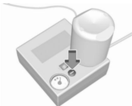
Presežek tlaka izpustite s pritiskom na gumb nad številčnico kompresorja.
