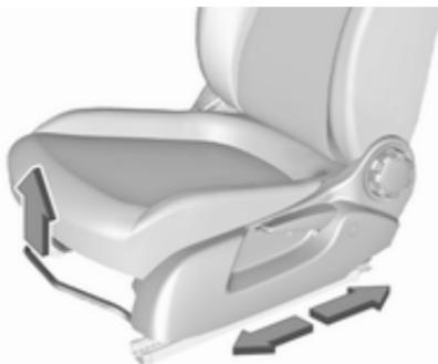
Potegnite ročico, pomaknite sedež, sprostite ročico. Sedež poskušajte pomakniti naprej in nazaj, da preverite, ali je pritrjen v ustreznom položaju.
