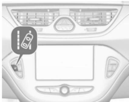
Sistem za opozorilo o nemamerni menjavi voznega pasu se aktivira s pritiskom . LED v stikalju označuje, da je sistem vključen. Kadar kontrolna lučka na instrumentni plošči sveti zeleno, je sistem pripravljen na delovanje.
