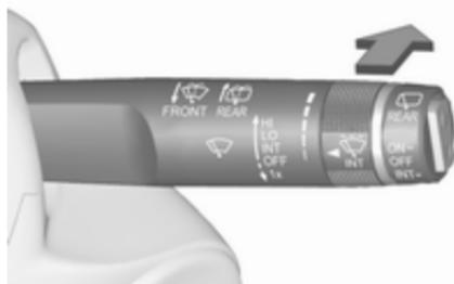
Potisnite ročično stikalo naprej. Šoba poškopi zadnje steklo, obenem brisalec nekajkrat obriše steklo.
