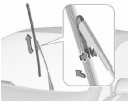
Dvignite ročico brisalca, da ostane v dvignjenem položaju. Pritisnite zaponki na obeh straneh, nagnite metlico brisalca pod kotom  $90^\circ$  na ročico brisalca in jo odstranite v smeri navzgor.
