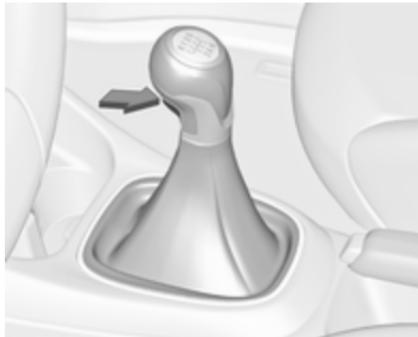
Za vklop vzvratne prestave pritisnite pedal sklopke, pritisnite sprostitveni gumb na izbirni ročici in prestavite.
