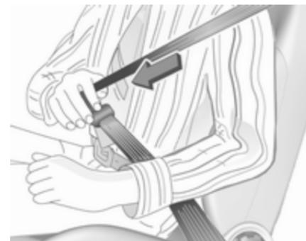
Enakomerno potegnite pas iz navjalca, ga nezvitega namestite čez telo in vstavite zaponko v zaklep, da se slišno zaskoči. Med vožnjo si pas na diagonalnem delu večkrat zategnite.
