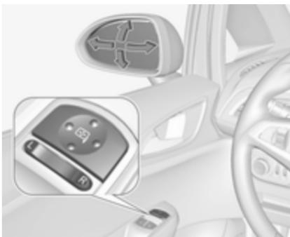
Izberite želeno zunanje ogledalo s pritiskom prevesnega stikala v levo (L) ali desno (R). Za nastavitev ogledala pomaknite
