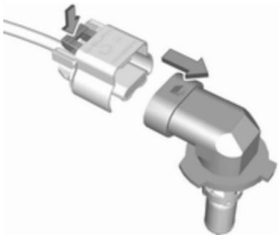
2. Držalo žarnice razvlecite s kabelskega priključka s pritiskom pritrdilne zaponke.
