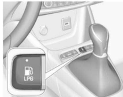
Po pritisku **LPG** se preklop med bencinskim in plinskim pogonom izvrši, takoj ko so izpolnjeni zahtevani pogoji (temperatura hladilne tekočine, temperatura plina in minimalno število vrtljajev motorja). Ti pogoji so običajno izpolnjeni po približno 60 sekundah (odvisno od zunanjé temperature) in prvem odločnejšem pritisku na pedal za plin. Lučka LED za stanje kaže trenutni način delovanja.
