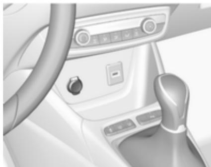
12 voltna električna vtičnica se
