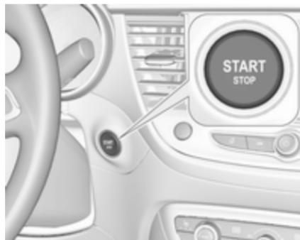
Ročni menjalnik: pritisnite sklopko in zavorni pedal.
