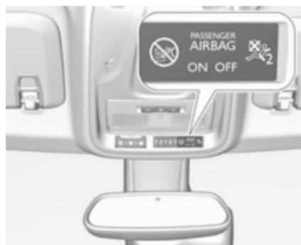
Če kontrolna lučka
