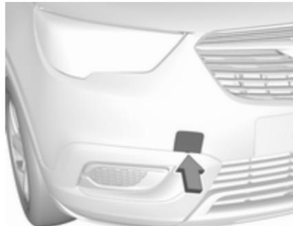
Vstavite izvijač v režo v spodnjem delu pokrova. Odpnite pokrov s previdnim pomikom izvijača navzdol.
