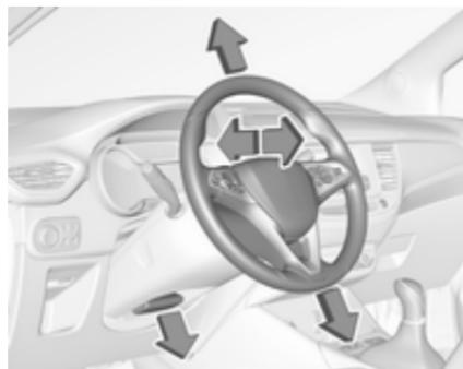
Sprostite ročico, nastavite volan, zataknite ročico v zavarovan položaj. Volana ne nastavljamte pri premikajočem vozilu in/ali blokiranim volanu.
