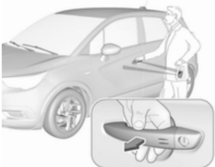
Pri tem mora biti elektronski oddajnik v dometu zunanjega sprejema antene, približno en meter od ustreznih vrat.
