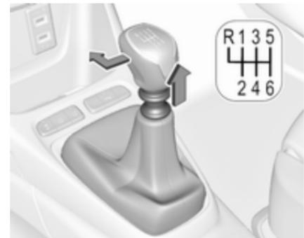
Če želite pri 6-stopenjskem menjalniku prestaviti v vzvratno prestavo, povlecite obroček pod glavo izbirne ročice in jo premaknite v levo in naprej.
