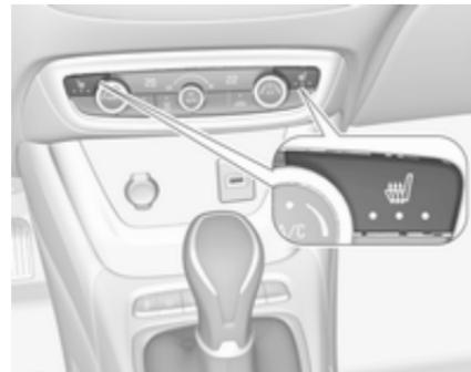
Nastavite želeno stopnjo ogrevanja s pritiskom na enkrat ali večkrat. Indikator v stiku označuje nastavitev.
