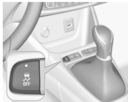
Elektronski stabilnostni nadzor in sistem proti zdrsu pogonskih koles lahko po potrebi izklopite tako, da pritisnete
