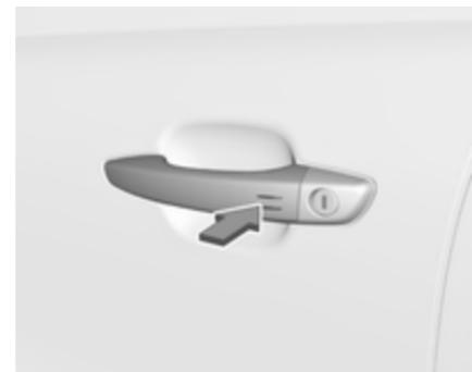
Sistem elektronskega oddajnika: Če vozilo odklenete s pritiskom na označeno mesto na eni od vratnih kljuk, se alarmna naprava izklopi.
