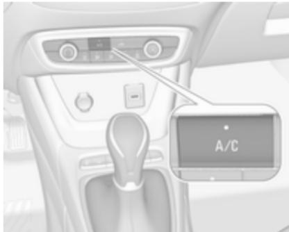
Za vklop hlajenja pritisnite **A/C**. Vklop signalizira LED indikator v stikalu. Hlajenje deluje samo, kadar teče motor in je vklučen ventilator sistema za ogrevanje, prezračevanje, hlajenje.
