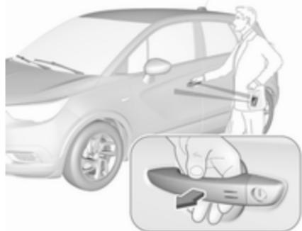
Pri tem mora biti elektronski oddajnik v dometu zunanjega sprejema antene, približno 1 m od ustreznih vrat.
