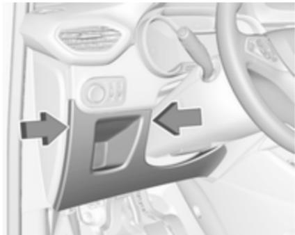
Pri modelih z volanom na levi: omarica z varovalkami je pod pokrovom na armaturni plošči. Pokrov sprostite ob strani in ga odstranite.
