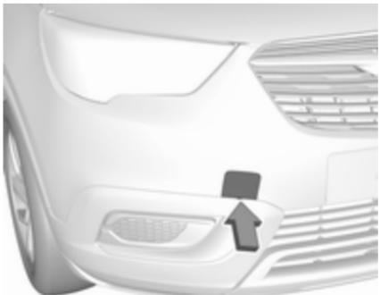
Okoli konice ploskega izvijača ovijte krpo, da preprečite poškodbo laka. Vstavite izvijač v režo v spodnjem delu pokrova. Odpnite pokrov s previdnim pomikom izvijača navzdol. Vlečno uho se nahaja med orodji vozila ⌀ 210.
