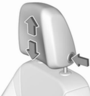
S pritiskom gumba sprostite vzglavnik, nastavite višino in pustite, da se zaskoči v zavarovani položaj.
