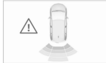
Prav tako je razdalja do ovir za avtomobilom prikazana s spremenjanjem črt razdalje na voznikovem informacijskem zaslonu 100. Ko se povsem približate oviri, se na zaslonu prikaže znak za nevarnost .
