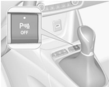
Sistem se samodejno izklopi, ko prestavite iz vzvratne prestave. Če želite ročno izklopiti sistem, pritisnite **POFF**. Če je sistem izklopljen, lučka LED v gumbu sveti. Če je bil sistem ročno izklopljen, se ne bo samodejno znova vkloplil, ko boste naslednjič vklopili kontakt.
