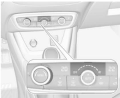
Nastavite želeni pretok zraka tako, da vrtljivi gumb ☰ nastavite na želeno hitrost. Za zmanjšanje hitnosti ga obrnite v levo, za povečanje pa v desno. Hitrost ventilatorja lahko spremenite tudi z gumboma na dotik na zaslonu za nastavitev klimatske naprave. Pritisnite  **MENU**, da odprete meni.
