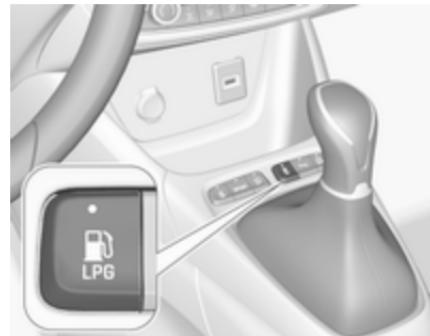
Po pritisku **LPG** se preklop med bencinskim in plinskim pogonom izvrši, takoj ko so izpolnjeni zahtevani pogoji (temperatura hladilne tekočine, temperatura plina in minimalno število vrtljajev motorja). Ti pogoji so običajno izpolnjeni po približno 60 sekundah (odvisno od zunanjega temperature) in prvem odločnejšem pritisku na pedal za plin. LED dioda prikazuje trenutni način delovanje z motorjem v teku.
