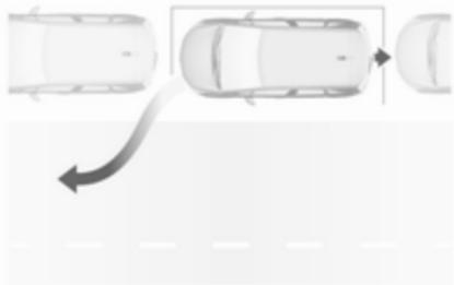
Vozili premikajte naprej in nazaj, pri čemer upoštevajte opozorila parkirnega pomočnika, dokler sistem ne prikaže, da je manever končan. Manever je končan, ko sprednji kolesi vozila zapustita parkirno mesto in lučka na instrumentni plošči ugasne.
