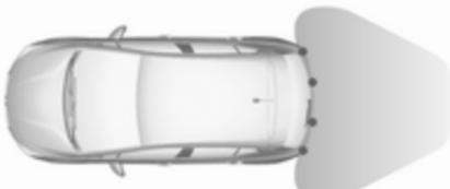
Sistem uporablja ultrazvočne senzorje, vgrajene v zadnjem odbijaču.
