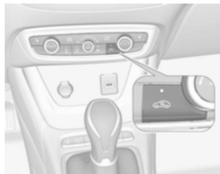
Za vklop kroženja zraka pritisnite . LED dioda v gumbu sveti in s tem označuje vključeno stanje.
