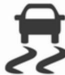
ESC in TC sta pripravljena za delovanje po zagonu motorja, potem ko ugasne kontrolna lučka .
