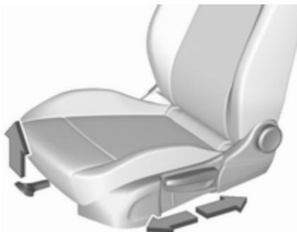
Potegnjte ročico, pomaknite sedež, sprostite ročico. Poskusite premakniti sedež nazaj in naprej in se tako prepričajte, da je sedež zavarovan v izbranem položaju.
