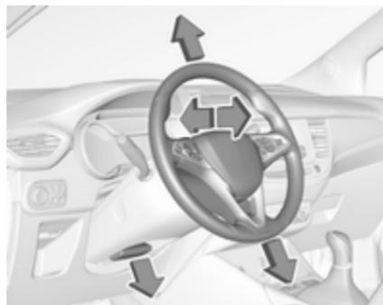
Sprostite ročico, nastavite volan, zataknite ročico v zavarovan položaj. Volana ne nastavljamte pri premikajočem vozilu in/ali blokiranem volanu.
