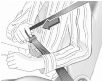
Enakomerno potegnite pas iz navjalca, ga nezvitega namestite čez telo in vstavite zaponko v zaklep, da se slišno zaskoči. Med vožnjo si pas na diagonalnem delu večkrat zategnjite.
