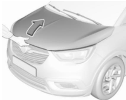
Premaknite varnostni zapah proti levi strani vozila in odprite pokrov motorja.
