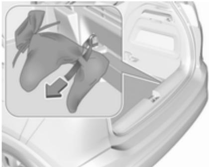
Napeljite trak skozi zadnje desno pritrdilno ušesce, ga zavijte dvakrat in zategnite, da bo vrečka pritrjena.
