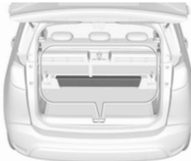
Opozorilni trikotnik pospravite v prostor na zadnjem delu prtljažnika in ga pritrdite s sprjemalnim trakom Velcro®.
