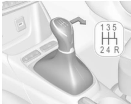
Če želite pri 5-stopenjskem menjalniku prestaviti v vzvratno prestavo, pritisnite stopalko sklopke in premaknite izbirno ročico v desno in nazaj.
