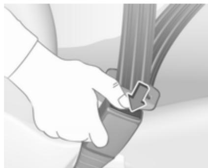
Pas odpnete s pritiskom na rdeč gumb na zaklepu.
