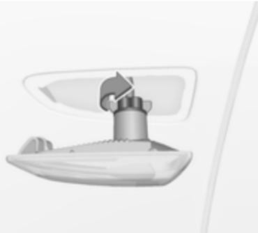
2. Obrnite držalo žarnice na levo in ga odstranite iz ohišja.
