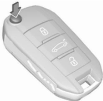
Za izskok ključeve brade pritisnite gumb. Za preklop ključeve brade pritisnite isti gumb.
