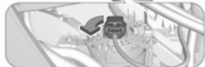
1. Držalo žarnice obrnite v levo in ga izvlecite iz ohišja žarometa.
