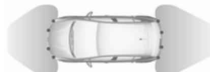
Sistem uporablja ultrazvočne senzorje, vgrajene v zadnjem in sprednjem odbijaču.
