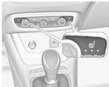
Nastavite želeno stopnjo ogrevanja s pritiskom na enkrat ali večkrat. Indikator v stikalnu označuje nastavitev.
