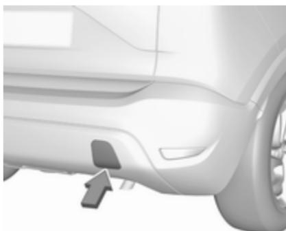
Okoli konice ploskega izvijača ovijte krpo, da preprečite poškodbo laka. Vstavite izvijač v režo v spodnjem delu pokrova. Odpnite pokrov s previdnim pomikom izvijača navzdol. Vlečno uho se nahaja med orodji vozila ⇨ 211.
