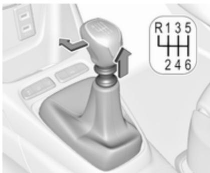
Če želite pri 6-stopenjskem menjalniku prestaviti v vzvratno prestavo, povlecite obroček pod glavo izbirne ročice in jo premaknite v levo in naprej.
