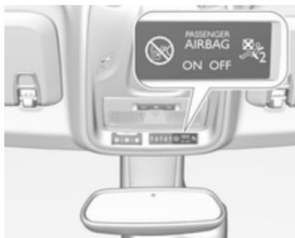
Če kontrolna lučka
