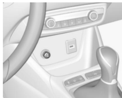
Vžigalnik je pod pokrovom prostora za spravljanje pod upravnimi elementi klimatske naprave. Za odpiranje pritisnite pokrov.
