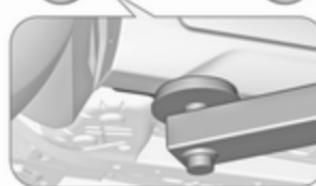
Sprednji položaj roke dvigalke sredinsko pod ustreznno dvigalno točko vozila.
