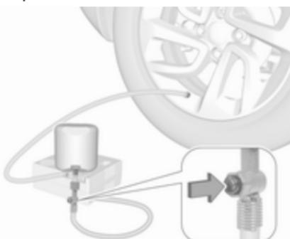
Previsok tlak v pnevmatikah zmanjšajte s pritiskom gumba na zračni cevi.
