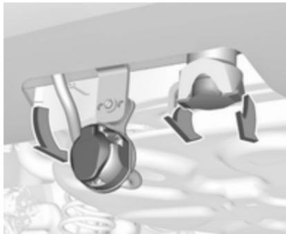
Prikluček obrnite navzdol. Iz odprtine za vlečno kljuko izvlecite tesnilni čep in ga pospravite v prtljažnik.
