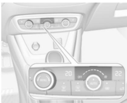
Nastavite želeni pretok zraka tako, da vrtljivi gumb
