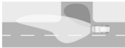
Pri zavijanju v križišču se na podlagi kota zasuka volana in vklopljenega smernika vklopijo določene lučke LED, ki osvetlijo smer vožnje. Funkcija deluje le pod hitrostjo 40 km/h.
