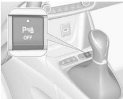
Sistem se samodejno izklopi, ko prestavite iz vzvratne prestave. Če želite ročno izklopliti sistem, pritisnite . Če je sistem izklopljen, lučka LED v gumbu sveti. Če je bil sistem ročno izklopljen, se ne bo samodejno znova vklopil, ko boste naslednjič vklopili kontakt.
