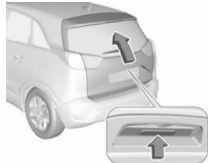
Po zaklepanju pritisnite gumb vrat prtlažnika in odprite vrata prtlažnika.
