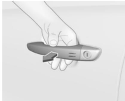
Za odklepanje vozila primite za kljuko sprednjih vrat ali pa pritisnite stikalo na vratih prtljažnika.
