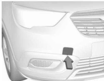
Okoli konice ploskega izvijača ovijte krpo, da preprečite poškodbo laka. Vstavite izvijač v režo v spodnjem delu pokrova. Odpnite pokrov s previdnim pomikom izvijača navzdol.
