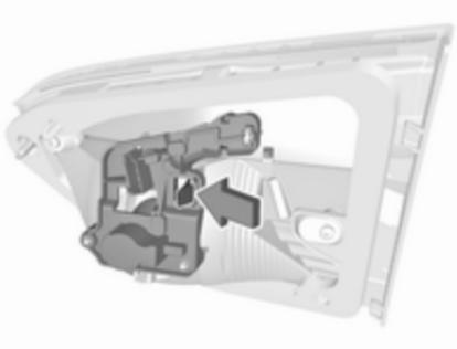
4. Pritisnite zapah, da sprostite in odstranite nosilec žarnice.
