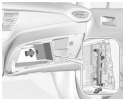
Pri vozilih z volanom na levi strani se škatla z varovalkami nahaja za pokrovom v sovoznikovem predalu. Odprite predal in odstranite pokrov. Odstranite nosilec.
