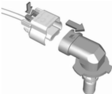
2. Držalo žarnice razvlecite s kabelskega priključka s pritiskom pritrtilne zaponke.
