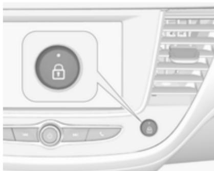
To funkcijo lahko trajno izklopite ali vklopite. Pri vključenem kontaktu pritisnite gumb in ga držite, dokler se ne sproži zvočni signal in prikaže ustrezno sporočilo.
