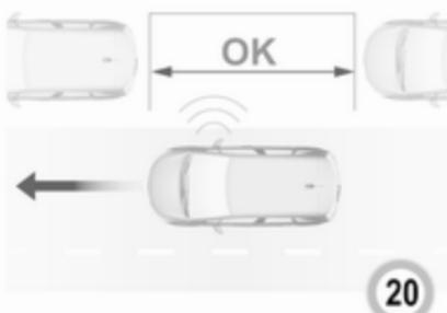
Ko sistem zazna ustrezno mesto, pošlje vizualno povratno informacijo barvnemu informacijskemu zaslonu in sproži prvi zvočni signal. Počasi zapeljite naprej. Ko zaslišite drugi zvočni signal, zaustavite vozilo, prestavite v vzvratno prestavo, spustite volan in začnite premikati vozilo s hitrostjo pod 7 km/h.
