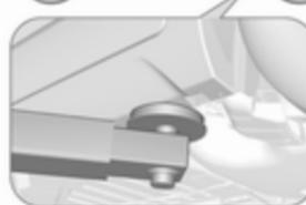
Zadnji položaj roke dvigalke sredinsko pod ustreznno dvigalno točko vozila.
