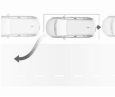
Vozili premikajte naprej in nazaj, pri čemer upoštevajte opozorila parkirnega pomočnika, dokler sistem ne prikaže, da je manever končan. Manever je končan, ko sprednji kolesi vozila zapustita parkirno mesto in lučka na instrumentni plošči ugasne.
