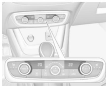
Po želji nastavite temperaturo posebej za voznikovo in sovoznikovo stran z levim in desnim krmilnim gumbom. Z vrtljivim gumbom na sovoznikovi strani nastavite temperaturo na sovoznikovi strani. Z vrtljivim gumbom na voznikovi strani nastavite temperaturo na voznikovi strani ali na obeh straneh, odvisno od sinhronizacije **MONO** v meniju nastavitev klimatske naprave.
