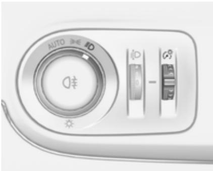
Svetlost luči za vožnjo za drugim vozilom je mogoče prilagoditi v načinu **AUTO**, če senzor svetlobe zazna nočne razmere, prav tako jih je mogoče prilagoditi pri nastavitevah  $\text{D}\text{E}$  in  $\text{S}\text{D}$ :
