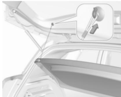
Iztaknite nosilni vrvici z vrat prtljažnika.
