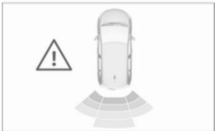
Prav tako je razdalja do ovir za avtomobilom prikazana s spremenjanjem črt razdalje na voznikovem informacijskem zaslonu 100. Ko se povsem približate oviru, se na zaslonu prikaže znak za nevarnost .
