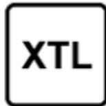
parafinsko dizelsko gorivo, ki ustreza standardu EN15940, mešano z biodizelskim gorivom, ki ustreza standardu EN14214 (in vsebuje največ 7 % metilnega estra maščobnih kislin).
