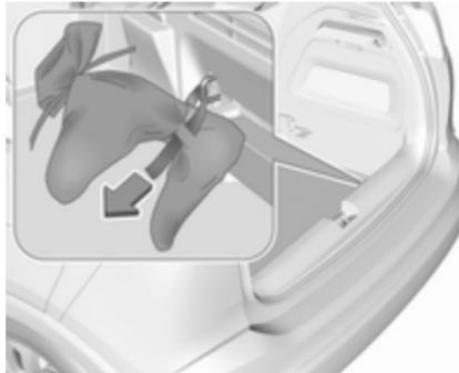
Napeljite trak skozi zadnje desno pritrnilno ušesce, ga zavijte dvakrat in zategnite, da bo vrečka pritrjena.
