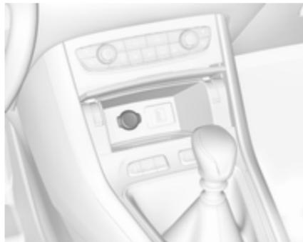
12-voltna električna vtičnica se nahaja za pokrovom prostora za spravljanje. Za odpiranje pritisnite pokrov.
