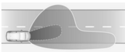
Upravlja jih brisalec ali senzor za dež. Širši svetlobni snop - rahlo usmerjeno navzven - boljša osvetlitev robov ceste. Intenzivnost osvetlitve na daljavo se poveča, da kljub slabemu vremenu lažje opažate predmete in oznake ob cesti ter ovire na cesti. Z
