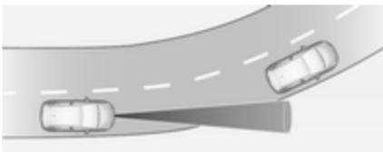
Prilagodljivi regulator hitrosti izračuna predvideno pot na osnovi centrifugalne sile. Ta predvidena pot upošteva značilnosti trenutnega zavoja, vendar pa ne more upoštevati spremembe zavoja v prihodnje. Sistem lahko izgubi vozilo pred vami ali upošteva vozilo ki ni na vašem voznem pasu. To se lahko zgodi ob vstopu v zavoj ali izstopu iz njega ali če zavoj postane bolj ali manj oster. Če sistem ne zaznava več spredaj vozečega vozila, lučka ugasne.
