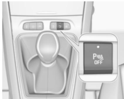
Sistem se samodejno izklopi, ko prestavite iz vzvratne prestave. Če želite ročno izklopiti sistem, pritisnite **PARK OFF**. Če je sistem izklopljen, lučka LED v gumbu sveti. Če je bil sistem ročno izklopljen, se ne bo samodejno znova vklopil, ko boste naslednjič vklopili kontakt.
