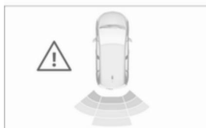
Prav tako je razdalja do ovir za avtomobilom prikazana s spremenjanjem črt razdalje na voznikovem informacijskem zaslonu ▷ 103. Ko se povsem približate oviri, se prikaže znak za nevarnost △.
