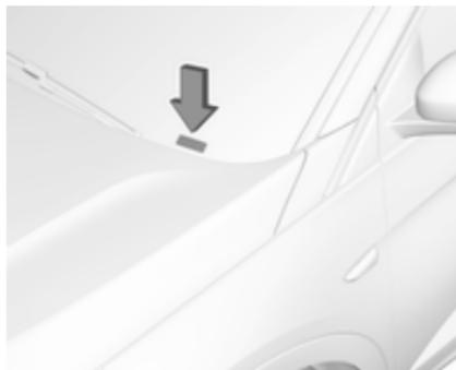
Identifikacijska številka vozila je lahko vtisnjena na instrumentni plošči in je vidna skozi vetrobransko steklo ali v motornem prostoru, na desni steni karoserije.
