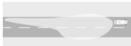
Samodejno se vklopi pri hitrosti med 55 km/h in 115 km/h, če vozite po podeželski cesti. Izboljša osvetlitev voznega pasu in predela ob cesti. Ne zaslepi voznikov, ki vozijo v nasprotni smeri in pred vami.
