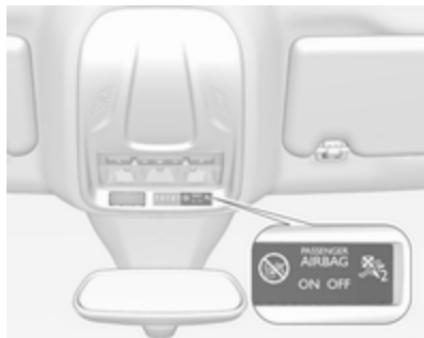
Če kontrolna lučka ⚡ po vključitvi kontakta vžiga sveti pribl. 60 sekund, je sistem varnostnih blazin na sovoznikovi strani aktiven in se bo v primeru trka sprožil.
