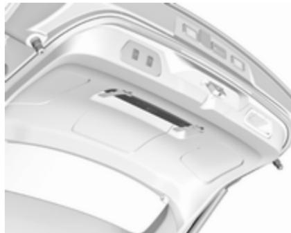
Opozorilni trikotnik pospravite v prostor v vratih prtljažnika in ga pritrdite s sprijemalnim trakom.
