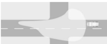
Samodejno se vklopijo pri približno 55 km/h in določeni jakosti svetlobe v okolini. Svetlobni snop je širok in simetričen. Če hitrost pada pod 30 km/h, se žarometi usmerijo malo navzven, da omogočijo hitrejše prepoznavanje pešcev in predmetov na obeh straneh ceste. Poseben vzorec svetlobnega snopa preprečuje zaslepljevanje drugih udeležencev v prometu.
