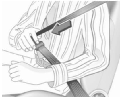
Enakomerno potegnite pas iz navjalca, ga nezvitega namestite čez telo in vstavite zaponko v zaklep, da se slišno zaskoči. Med vožnjo si pas na diagonalnem delu večkrat zategnite.
