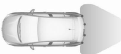
Sistem uporablja ultrazvočne senzorje, vgrajene v zadnjem odbijaču.
