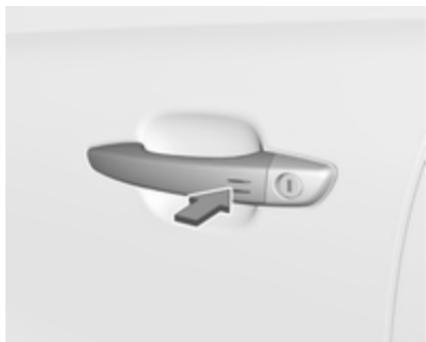
Sistem elektronskega oddajnika: Če vozilo odklenete s pritiskom na označeno mesto na eni od vratnih kljuk, se alarmna naprava izklopi.
