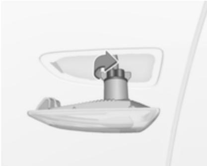
2. Obrnite držalo žarnice v desno in ga odstranite iz ohišja.
