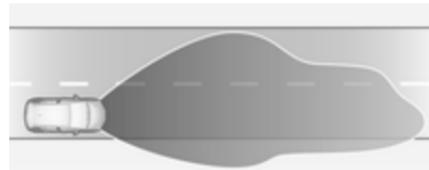
Samodejno se vklopi pri hitrosti nad 115 km/h. Osvetlitev se prilagodi hitrejši vožnji po avtocesti. Če v nasprotni smeri ni prometa, se
