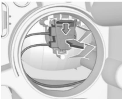
2. Držalni zaponki pritisnite navzdol in držalo žarnice povlecite proti zadnjemu delu.
