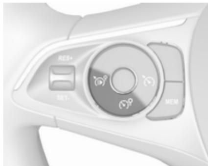
Pritisnite  $\text{ODO}$ , na voznikovem informacijskem zaslonu se prikaže simbol  $\text{ODO}$  in sporočilo. Sistem še ni aktivен.
