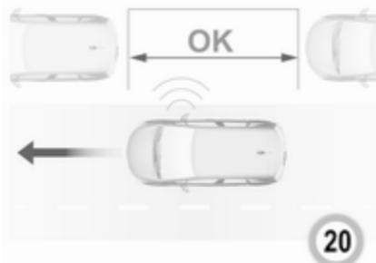
Ko sistem zazna ustrezeno mesto, pošlje vizualno povratno informacijo informacijskemu zaslonu in sproži prvi zvočni signal. Počasi zapeljite naprej. Ko zaslišite drugi zvočni signal, zaustavite vozilo, prestavite v vzvratno prestavo, spustite volan in začnite počasi peljati vozilo. Na informacijskem prikazovalniku se pokažejo slikovne povratne informacije.
