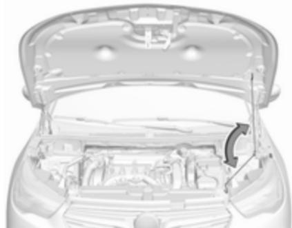
Zataknite podporno prečko.
