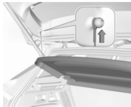
Iztaknite nosilni vrvici z vrat prtljažnika.
