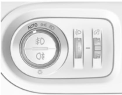
Pri vklopljeni funkciji samodejnega vklopa luči med obratovanjem motorja sistem preklopi med dnevнимi lučmi in samodejno delajočimi lučmi na podlagi podatkov o zunanjih svetlobnih razmerah, ki jih prejme od sistema brisalcev.
