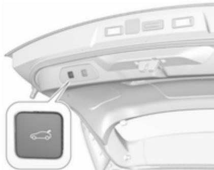
Za zapiranje vrat prtljažnika pridržite pritisnjeni na odprtih vratih, dokler se vrata ne pričnejo zapirati.
