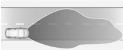
Samodejno se vklopi pri hitrosti nad 115 km/h. Osvetlitev se prilagodi hitrejši vožnji po avtocesti. Če v nasprotni smeri ni prometa, se osvetlitev pred vozilom razširi. Domet se s 70 m poveča na 140 m, kar omogoča prepoznavanje predmetov po celotni širini ceste.
