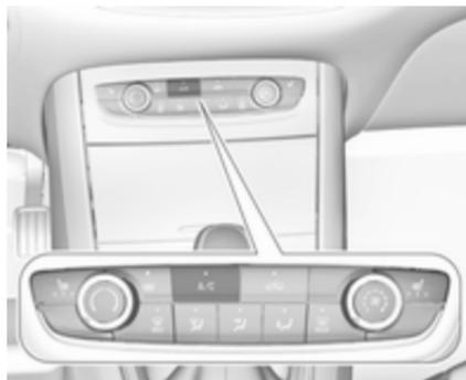
Za vklop hlajenja pritisnite **A/C**. LED dioda v gumbu sveti in s tem označuje vključeno stanje. Hlajenje deluje samo, kadar teče motor in je vključen ventilator.
