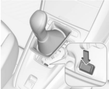
3. Gumb potisnite navzdol in izbirno ročico povlecite iz položaja **P**. Vzrok prekinitve napajanja dajte nemudoma odpraviti strokovnjakom v servisni delavnici.
