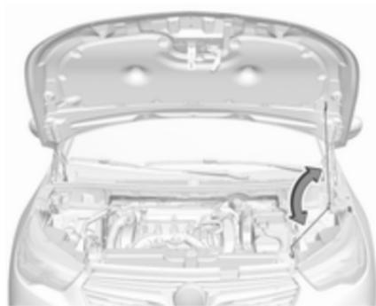
Zataknite podporno prečko.
