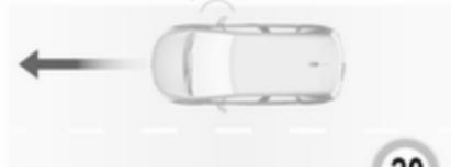
Ko sistem zazna ustrezno mesto, pošlje vizualno povratno informacijo informacijskemu zaslonu in sproži prvi zvočni signal. Počasi zapeljite naprej. Ko zaslišite drugi zvočni signal, zaustavite vozilo, prestavite v vzvratno prestavo, spustite volan in začnite počasi peljati vozilo. Na informacijskem prikazovalniku se pokažejo slikovne povratne informacije.
