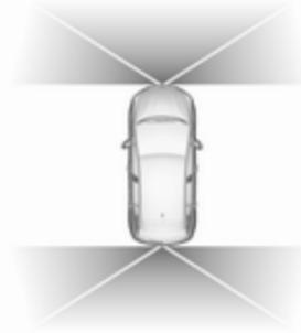
Prikaz kota vidnega polja s kotom 180° olajša vzratno speljevanje s parkirišča, saj prikazuje bližajoče se pešce, kolesarje in vozila. Ne priporočamo, da celoten manever izvedete izključno na podlagi tega prikaza. Sestavljen je iz treh območij: levega 1, srednjega 2 in desnega 3. Ta prikaz je na voljo samo v meniju za izbiranje prikaza.
