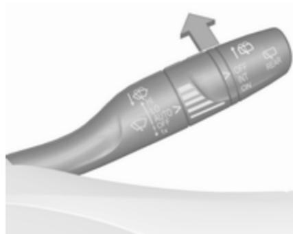
Potisnite ročično stikalo naprej. Šoba poškrabi zadnje steklo, obenem brisalec nekajkrat obriše steklo. Pri prenizkem nivoju tekočine za pranje ne deluje pranje zadnjega stekla.
