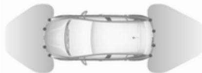
Sistem uporablja ultrazvočne senzorje, vgrajene v zadnjem in sprednjem odbijaču.
