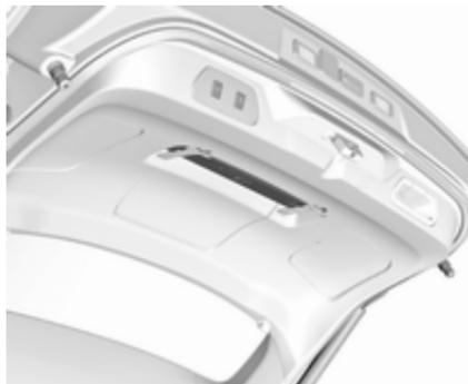
Opozorilni trikotnik pospravite v prostor v vratih prtljažnika in ga pritrdite s sprijemalnim trakom Velcro®.
