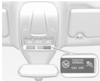
Če kontrolna lučka
