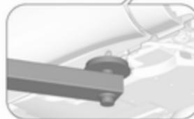
Zadnji položaj roke dvigalke sredinsko pod ustrezno dvigalno točko vozila.
