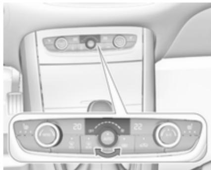
Nastavite želeni pretok zraka tako, da vrtljivi gumb nastavite na želeno hitrost. Za zmanjšanje hitrosti ga obrnite v levo, za povečanje pa v desno. Hitrost ventilatorja je mogoče spremeniti tudi v meniju nastavitve klimatske naprave. Pritisnite **MENU**, da odprete meni.
