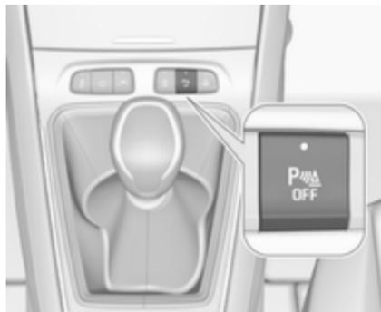
Sistem se samodejno izklopi, ko prestavite iz vzvratne prestave. Če želite ročno izklopiti sistem, pritisnite **P OFF**. Če je sistem izklopljen, lučka LED v gumbu sveti. Če je bil sistem ročno izklopljen, se ne bo samodejno znova vklopil, ko boste naslednjič vklopili kontakt.
