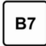
dizelsko gorivo, ki ustreza standardu EN590, mešano z biodizelskim gorivom, ki ustreza standardu EN14214 (in vsebuje največ 7 % metilnega estra maščobnih kislin).
