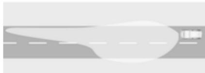
Samodejno se vklopi pri hitrosti med 55 km/h in 115/km/h, če vozite po podeželski cesti. Izboljša osvetlitev voznega pasu in predela ob cesti. Ne zaslepi voznikov, ki vozijo v nasprotni smeri in pred vami.
