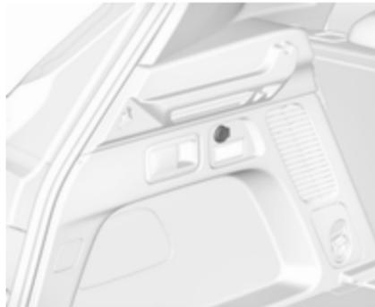
Še ena 12-voltna električna vtičnica je vgrajena v levi bočni steni v prtljažnem prostoru.
