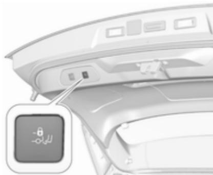
Če pri odprtih vratih prtljažnika pritisnete gumb
