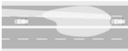
Pomočnik za dolge luči ima poseben način delovanja za avtoceste. Če po avtocesti vozite s hitrostjo nad 115 km/h on, se svetlobni snop dolgih luči zmanjša, da ne bi zaslepil voznikov, ki vozijo v nasprotni smeri. Pri vožnji za drugimi vozili in prehitevanju se osvetlitev prilagodi tako, da omeji zaslepljujoč odsev.
