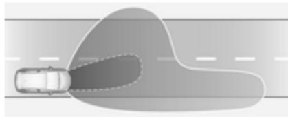
Upravlja jih brisalec ali senzor za dež. Širši svetlobni snop - rahlo usmerjeno navzven - boljše osvetlitev robov ceste. Intenzivnost osvetlitve na daljavo se poveča, da kljub slabemu vremenu lažje opazate predmete in oznake ob cesti ter ovire na cesti. Z zmanjšanjem odseva na mokrih cestah bo učinek zaslepljujoče svetlobe za prihajajoči promet manjši. Osvetlitev za slabo vreme se vklopi pri hitrosti 70 km/h.
