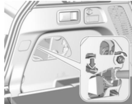
2. Matico luči odvijte s ključem za vijačenje. Pod matico postavite krpo, da preprečite, da bi vam padla v opažno oblogo bočnega dela.
