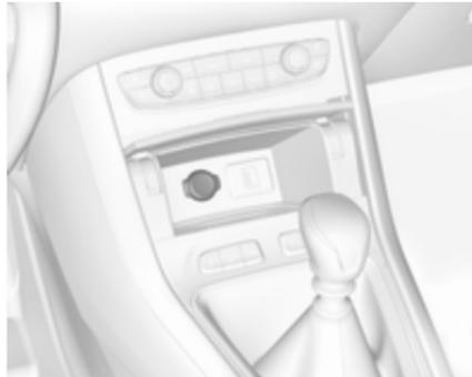
12-voltna električna vtičnica se nahaja za pokrovom prostora za spravljanje. Za odpiranje pritisnite pokrov.
