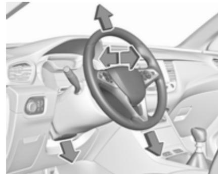
Sprostite ročico, nastavite volan, zataknite ročico v zavarovan položaj. Volana ne nastavljajte pri premikajočem vozilu in/ali blokiranem volanu.
