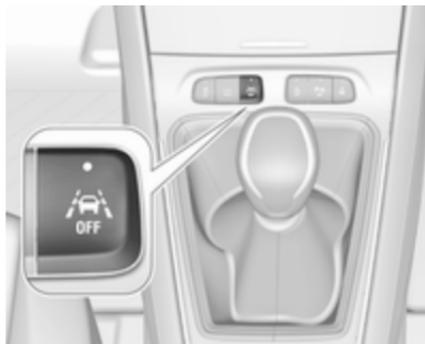
Če je sistem vklopljen, lučka LED v gumbu
