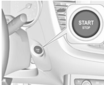
Elektronski oddajnik mora biti v vozilu.
