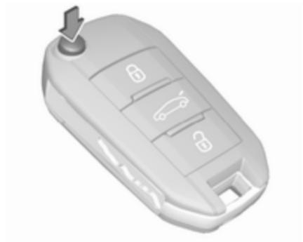
Za izskok ključeve brade pritisnite gumb. Za preklon ključeve brade pritisnite isti gumb.
