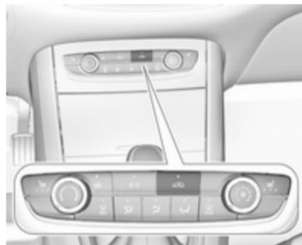
Za vklop kroženja zraka pritisnite
