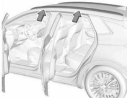
Strešni prtljažnik pritrdite na strešni nosilec na pritrditvenih točkah, ki so nad vratnimi okvirji.
