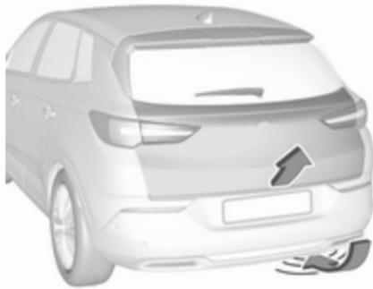
Če želite odpreti ali zapreti vrata prtljažnika, s stopalom pomigajte naprej in nazaj pod zadnjim prtljažnikom na predelu pod registrsko tablico. Ključ mora biti znotraj enega metra. Stopala ne držite za dalj časa ali ga ne prepočasi pomaknite pod odbijač. Pri tem mora biti elektronski oddajnik v dometu zunanje sprejema antene, približno en meter od vrat prtljažnika.
