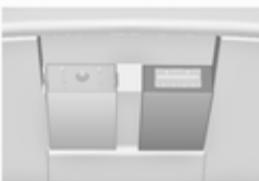
Pod pokrovom na sredinski konzoli je USB vtičnica za priklop zunanjih avdio naprav.
