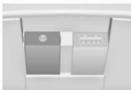
Pod pokrovom na sredinski konzoli je AUX vtičnica za priklop zunanjih avdio naprav.
