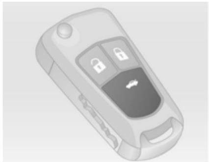
V ta namen pritisnite pri izključenem kontaktu tipko , dokler se vrata prtljažnika ne odprejo samodejno. Vsa ostala vrata ostanejo zaklenjena. Električna vrata prtljažnika ⇨ 24.
