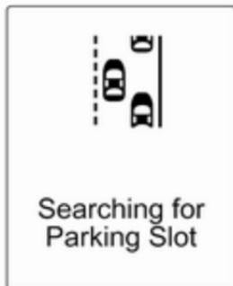
Ko vozilo obide vrsto parkiranih vozil pri aktiviranem sistemu, začne napredni pomočnik pomagati iskati primerno parkirno mesto. Ko je primerno parkirno mesto zaznano, se na voznikovem informacijskem prikazovalniku pojavi obvestilo in oglasi se zvočni signal.
