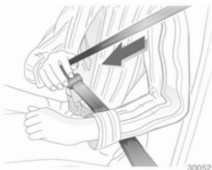
Enakomerno potegnite pas iz navjalca, ga nezvitega namestite čez telo in vstavite zaponko v zaklep, da se slišno zaskoči. Med vožnjo si pas
