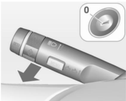
Žarometi, zadnje luči, vzvratne luči in osvetlitev registrske tablice svetijo določen (programljen) čas po zapuščanju vozila.
