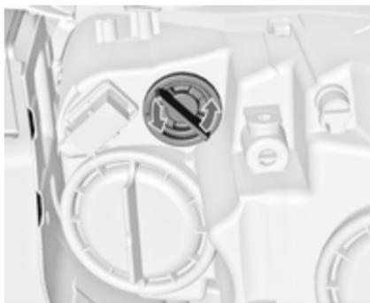
1. Nosilec žarnice obrnite v obratno smer urinega kazalca in iztaknite.
