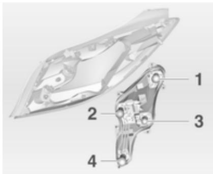
5. Žarnico rahlo pritisnite v nosilec, jo obrnite v levo in izvlecite ter vstavite novo žarnico.
