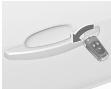
Odklenite voznikova vrata z obratom ključa v ključavnici. Vključite kontakt in pritisnite stikalo
