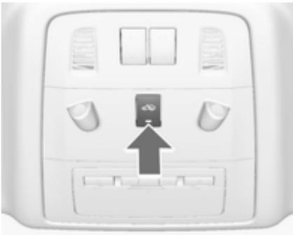
Nadziranje potniškega prostora in nagiba vozila izključite, če pustite v vozilu kakšno žival, ker se utegne sprožiti alarm zaradi gibanja v vozilu, ultrazvočnih valov in nagibanja vozila pri prevozu. Nadziranje potniškega prostora in nagiba vozila izključite tudi pri prevozu na ladji ali vlaku.
