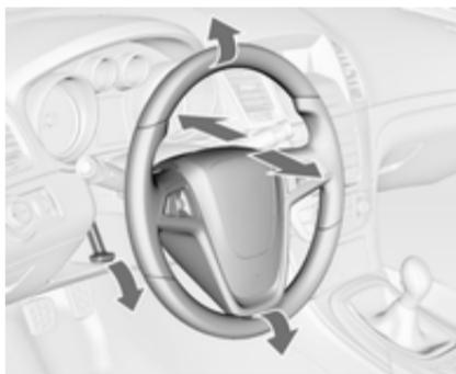
Sprostite ročico, nastavite volan, zataknite ročico v zavarovan položaj. Volana ne nastavlajte pri premikajočem vozilu in/ali blokiranim volanu.
