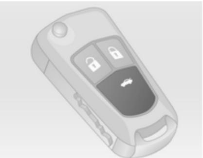
Z radijskim daljinskim upravljalnikom: tipko pridržite pritisnjeno, dokler se vrata prtljažnika ne odprejo samodejno. Ali pa potegnite gumb pod prijemkom na vratih po odklepanju.
