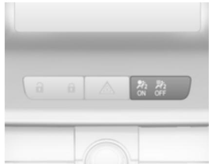
Kadar kontrolna lučka
