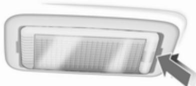
1. Luč iztaknite z izvijačem.
