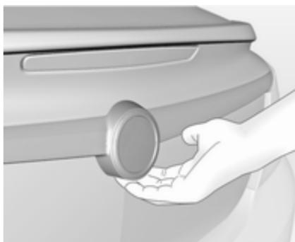
Po odklepanju pritisnite gumb pod prijemkom na vratih prtljažnika in potegnite vrata navzgor.
