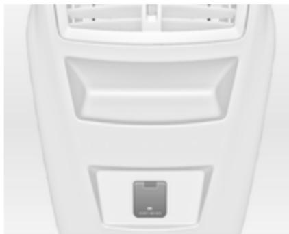
230 voltna električna vtičnica se nahaja v zadnji talni konzoli. Pri vključenem kontaktu in priklopljenem porabniku sveti LED na vtičnici zeleno.
