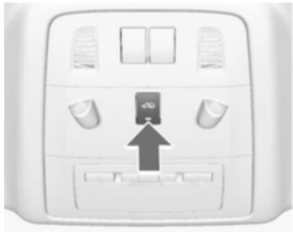
Nadziranje potniškega prostora in nagiba vozila izključite, če pustite v vozilu kakšno žival, ker se utegne sprožiti alarm zaradi gibanja v vozilu, ultrazvočnih valov in nagibanja vozila pri prevozu. Nadziranje potniškega prostora in nagiba vozila izključite tudi pri prevozu na ladji ali vlaku.
