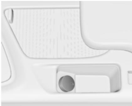
12 voltne vtičnice so vgrajene v sprednjem in zadnjem delu sredinske konzole.
