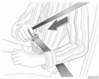
Enakomerno potegnite pas iz navjalca, ga nezvitega namestite čez telo in vstavite zaponko v zaklep, da se slišno zaskoči. Med vožnjo si pas na diagonalnem delu večkrat zategnjite. Opozorilna lučka za pripenjanje varnostnega pasu ⇨ 87
