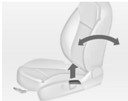
Potegnite vzvod, nastavite naklon in sprostite vzvod. Sedežno naslonjalo naj se primerno zaskoči.
