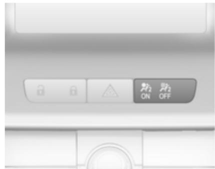
Kadar kontrolna lučka ne sveti, se sovoznikove varnostne blazine sprožijo v primeru trka.
