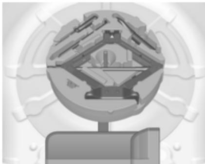
Dvigalka in orodja so spravljeni v prtljažniku v prostoru pod rezervnim kolesom. Rezervno kolo ⌂ 198.
