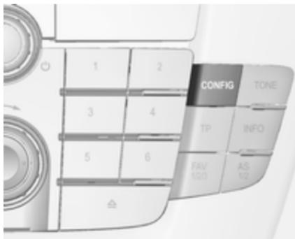
Pritisnite gumb **CONFIG**. Prikaže se meni **Settings (nastavitev)**.
