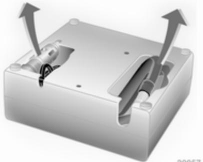
3. Vzemite iz predalčkov na spodnji strani kompresorja električni kabel s priključkom in zračno cev.
