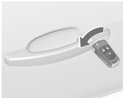
Odklenite voznikova vrata z obratom ključa v ključavnici. Vključite kontakt in pritisnite stikalilo za odklepanje vseh vrat, prtljažnika in lopute rezervoarja goriva. Ob vklopu kontakta za vžig se izklopi varovalni zaklep proti kraji.
