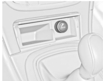
Vžigalnik pritisnite navznoter. Vžigalnik se samodejno izklopi in izskoči iz ležišča, ko je spirala razzarjena. Vžigalnik izvlecite.
