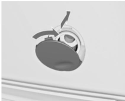
Vstavite pokrov na spodnjem delu, ga rahlo obrnite v desno in zaprite.
