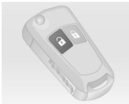
V ta namen pritisnite pri izključenem kontaktu tipko ③. Vrata prtljažnika se odklenejo in jih lahko odprete z dotikom tipke pod prijemkom na vratih.
