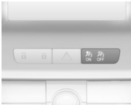
Kadar kontrolna lučka
