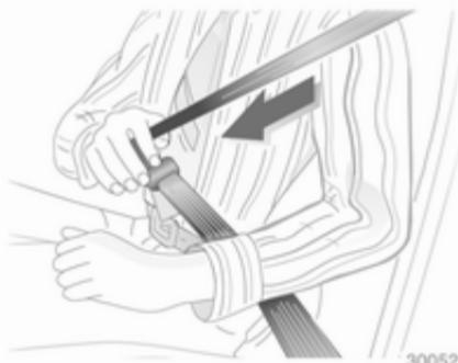
Enakomerno potegnite pas iz navjalca, ga nezvitega namestite čez telo in vstavite zaponko v zaklep, da se slišno zaskoči. Med vožnjo si pas na diagonalnem delu večkrat zategnjite. Opozorilo za pripenjanje varnostnega pasu ⚡ 87.
