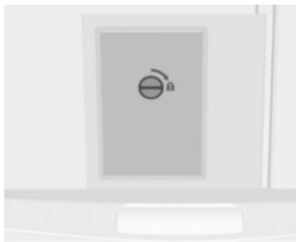
Zaprt pokrov lahko zavarujete s strani prtljažnega prostora. Obrnite zaklep za 90°:
