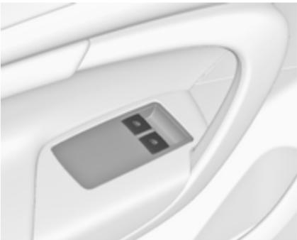
Za odpiranje želenega okna pritisnite ustrezen stikalo in za zapiranje okna stikalo potegnite.
