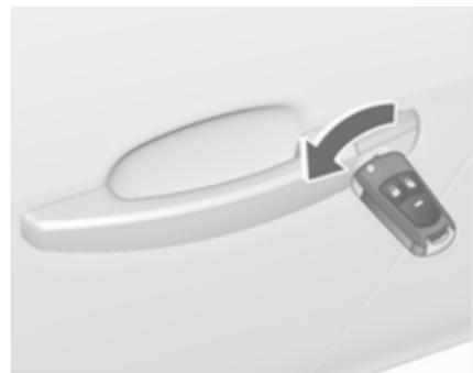
Odklenite voznikova vrata z obratom ključa v ključavnici. Vključite kontakt in pritisnite stikalo za odklepanje vseh vrat, prtljažnika in lopute rezervoarja goriva. Ob vklopu kontakta za vžig se izklopi varovalni zaklep proti kraji.
