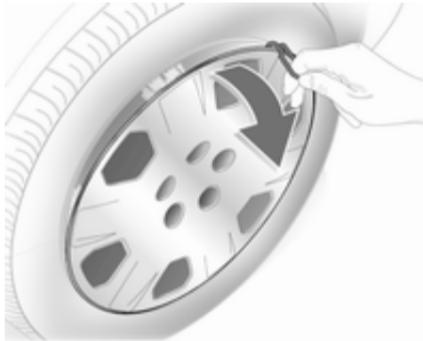
1. Pokrove vijakov odstranite s pomočjo izvijača. S kavljem iztaknite in snemite okrasni pokrov kolesa. Orodje vozila ⇨ 187.
