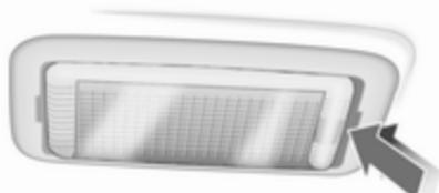
1. Luč iztaknite z izvijačem.
