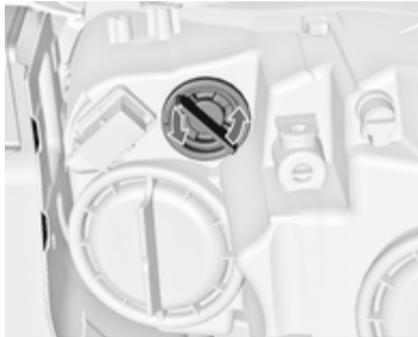
1. Obrnite nosilec žarnice v nasprotni smeri urnega kazalca in ga sprostite.
