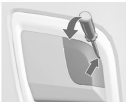
**Insignia OPC:** Vstavite izvijač v odprtino na zgornjem robu pokrova. Odpnite pokrov s previdnim pomikom izvijača navzdol. Za zaščito vstavite med izvijač in okvir mehko krpo.
