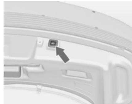
Za zapiranje vrat prtljažnika pridržite pritisnjeno gumb na odprtih vratih, dokler se vrata ne pričnejo zapirati.
