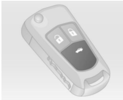
V ta namen pritisnite pri izključenem kontaktu tipko , dokler se vrata prtljažnika ne odprejo samodejno.
