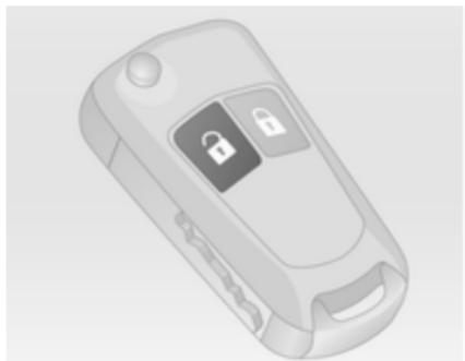
V ta namen pritisnite pri izključenem kontaktu tipko ②. Vrata prtljažnika se odklenejo in jih lahko odprete z dotikom tipke pod prijemkom na vratih.
