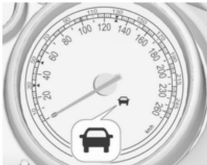
V merilniku hitrosti se prikaže zeleni znak za spredaj vočevo vozilo 🚗, če sistem zaznava vozilo v smeri vožnje pred vami.
