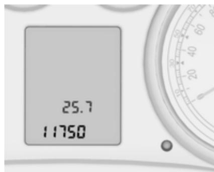
Voznikov informacijski zaslon (DIC) se nahaja na instrumentni plošči med merilnikom hitrosti in merilnikom vrtljajev motorja. Na voljo je za zaslon srednje stopnje, zaslon višje stopnje ali kombinirani zaslon višje stopnje.
