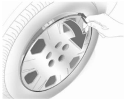
1. Pokrove vijakov odstranite s pomočjo izvijača. S kavljem iztaknite in snemite okrasni pokrov kolesa. Orodje vozila  $\diamond$  211.
