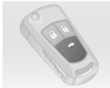
Pritisnite gumb na radijskem daljinskem upravljalniku, dokler se vrata prtljažnika ne odprejo samodejno, ali pa po odklepanju potegnite gumb pod oblogo vrat prtljažnika.
