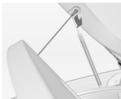
Iztaknite nosilni vrviči z vrat prtljažnika.
