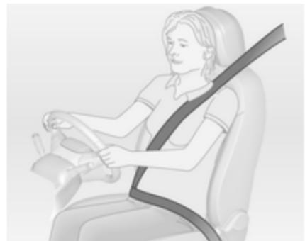
Izvlecite varnostni pas in ga zataknite v zaklep. Bočni del pasu ne sme biti zvit na nobenem delu in se mora tesno prilegati k telesu. Naslonjalo naj ne bo nagnjeno preveč nazaj (priporočen kot nagiba: največ 25°).
