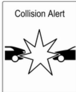
Ko se vozilo prehitro bliža drugemu vozilu, se na voznikovem informacijskem zaslonu prikaže stran z opozorilom glede trka. Hkrati se zasliši opozorilni zvok. Pritisnite zavorno stopalko, če to od vas zahteva situacija.
