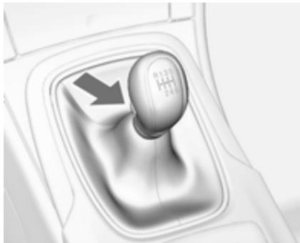
Vzvratna prestava: ko vozilo miruje, pritisnite pedal sklopke, pritisnite gumb na prestavnici ročici in prestavite.
