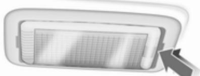
1. Luč iztaknite z izvijačem.
