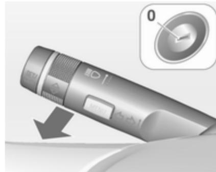
Žarometi, zadnje luči in osvetlitev registrske tablice svetijo določen (programljen) čas po zapuščanju vozila.
