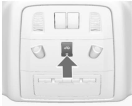
Nadziranje potniškega prostora in nagiba vozila izključite, če pustite v vozilu kakšno žival, ker se utegne sprožiti alarm zaradi gibanja v vozilu, ultrazvočnih valov in nagibanja vozila pri prevozu. To izključite tudi pri prevozu vozila na ladji ali vlaku.
