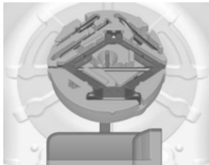
Dvigalka in orodja so spravljeni v prtljažniku v prostoru pod rezervnim kolesom. Rezervno kolo ⇨ 222.
