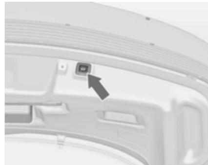
Za zapiranje vrat prtlažnika pridržite pritisnjeni gumb
