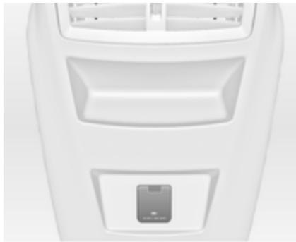
230 voltna električna vtičnica se nahaja v zadnji talni konzoli. Pri izklučenem kontaktu in priklapljenem porabniku sveti LED na vtičnici zeleno.
