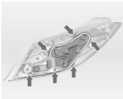
4. Odvijte vijke in odstranite nosilec žarnic.
