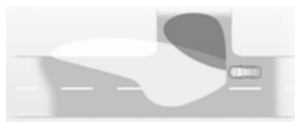
V ostrih zavojih ali pri zavijanju s ceste - odvisno od kota volana in/ali vklopa smernikov - se vklopi dodaten žaromet, ki osvetli cesto v pravem kotu v želeni smeri vožnje. Funkcija deluje le pod hitrostjo 40 km/h.
