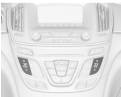
Nastavite temperature so za voznika in sovoznika ločeno označeni na ploščah.
