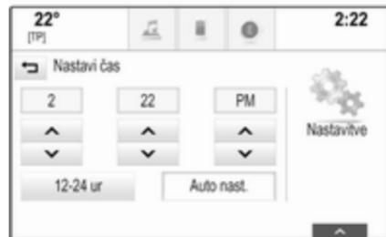
Izberite gumb Samodejna nastavitev na dnu zaslona. Vklopite Vklop - način RDS ali Izklop - ročni način.
