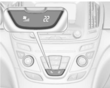
Nastavitevi temperature in hitrosti ventilatorja so označene na prikazovalniku klimatske naprave.
