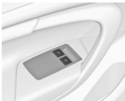
Za odpiranje želenega okna pritisnite ustrezeno stikalo in za zapiranje okna stikalo potegnjite.
