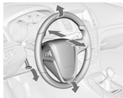
Sprostite ročico, nastavite volan, zataknite ročico v zavarovan položaj. Volana ne nastavljajte pri premikajočem vozilu in/ali blokiranim volanu.
