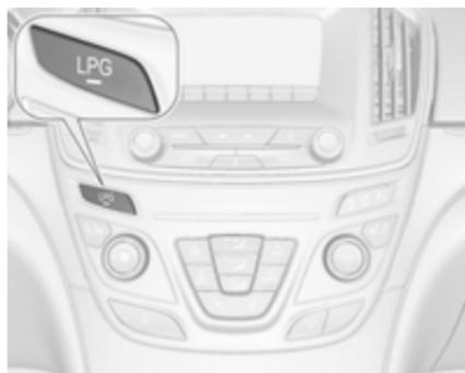
Pritisnite tipko **LPG** za preklop med bencinskim in plinskim pogonom, takoj ko so izpolnjeni zahtevani pogoji (temperatura hladilne tekočine, temperatura plina in minimalno število vrtljajev motorja). Ti pogoji so običajno izpolnjeni po približno 60 sekundah (odvisno od zunanje temperature) in prvem odločnejšem pritisku na pedal za plin. Stanje LED lučk opozarja na trenutni način delovanja.
