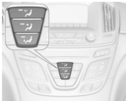
Pritisnite ustrezen gumb za želeno nastavitev. Vklop signalizira LED indikator v stikalu. Hlajenje deluje samo, kadar teče motor in je vključen ventilator sistema za ogrevanje, prezračevanje, hlajenje.
