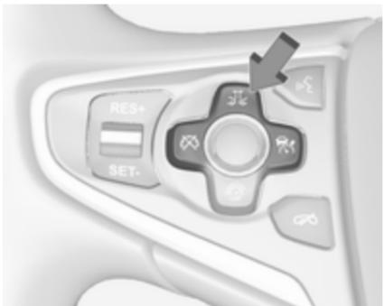
Pritisnite gumb . Trenutna nastavitev se prikaže na informacijskem centru voznika. Znova pritisnite gumb , da spremenite občutljivost opozorila. Nastavitev se prikaže tudi na voznikovem informacijski zaslonu.
