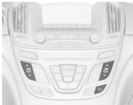
Nastavite želeno temperaturo z dotikom ▲ za višje temperature ali ▼ za nižje temperature.
