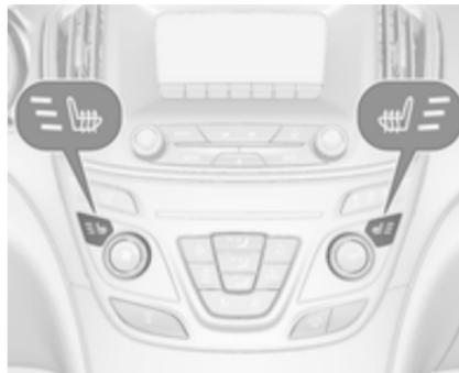
Nastavite želeno stopnjo ogrevanja s pritiskom na gumb enkrat ali večkrat. Indikator v stikalnu označuje nastavitev.
