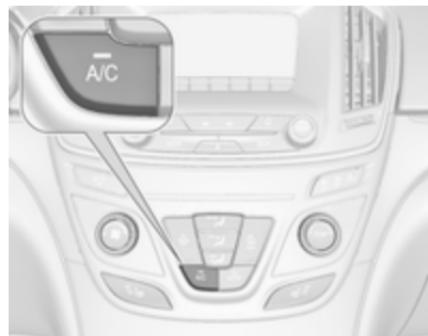
Za vklop hlajenja pritisnite gumb **A/C**. Vklop signalizira LED indikator v stikalnu. Hlajenje deluje samo, kadar teče motor in je vključen ventilator sistema za ogrevanje, prezračevanje, hlajenje.
