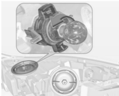
2. Žarnico rahlo pritisnite v nosilec, jo obrnite v levo in izvlecite.
