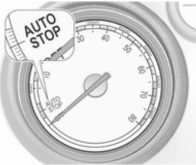
Režim Autostop označuje kazalec v legi **AUTOSTOP** na števcu vrtljavjev motorja. Na nekaterih različicah zasveti kontrolna lučka v instrumentni plošči, ko je motor v načinu samodejne zaustavitve.
