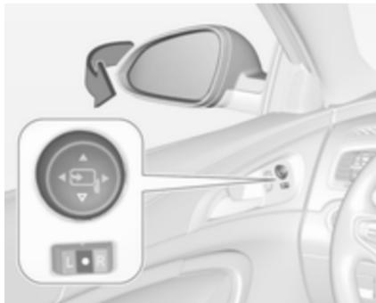
Element za upravljanje preklopite na ● in potisnite krmilni gumb ▼ navzdol. Obe zunanjti ogledali se preklopita.
