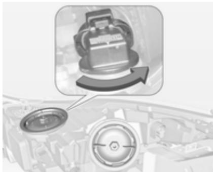
2. Nosilec žarnice obrnite v obratno smer urinega kazalca. Izvlecite nosilec z žarnico iz žarometa.
