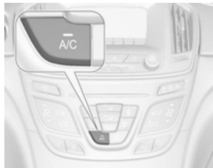
Za vklop hlajenja pritisnite tipko **A/C**. Vklop signalizira LED indikator v stikalu. Hlajenje deluje samo, kadar teče motor in je vključen ventilator sistema za ogrevanje, prezračevanje, hlajenje.
