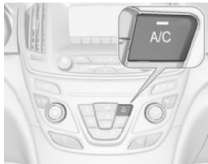
Za vklop hlajenja pritisnite tipko **A/C**. Vklop signalizira LED indikator v stikalnu. Hlajenje deluje samo, kadar teče motor in je vključen ventilator sistema za ogrevanje, prezračevanje, hlajenje.
