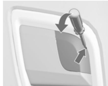
**OPC:** vstavite izvijač v odprtino na zgornjem robu pokrova. Odpnite pokrov s previdnim pomikom izvijača navzdol. Za zaščito vstavite med izvijač in okvir mehko krpo.
