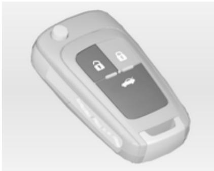
Za odklepanje vrat ter prtljažnika pritisnite tipko . Odprite vrata s potegom kljuke na vratih. Za odpiranje vrat prtljažnika potegnite gumb pod prijemkom.
