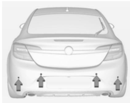
Parkirni pomočnik spredaj-zadaj meri razdaljo med vozilom in ovirami pred in za vozilom. Sistem oddaja zvočna opozorila in prikazuje sporočila.
