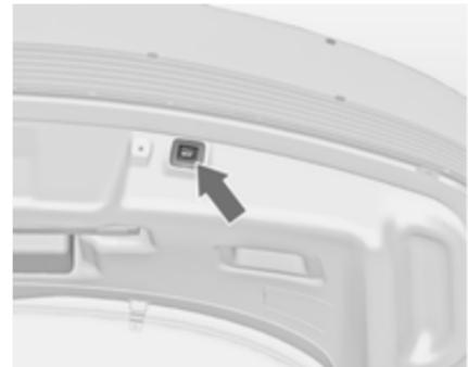
Za zapiranje vrat prtljažnika pridržite pritisnjeni gumb na odprtih vratih, dokler se vrata ne pričnejo zapirati.
