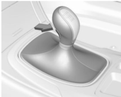
Vzvratna prestava: ko vozilo miruje, pritisnite pedal sklopke, pritisnite gumb na prestavnici ročici in prestavite. Če ni možno prestaviti v vzvratno prestavo, ponovno pomaknite ročico v prosti tek, sprostite in še enkrat pritisnite pedal sklopke ter nato ponovno prestavite v vzvratno prestavo.
