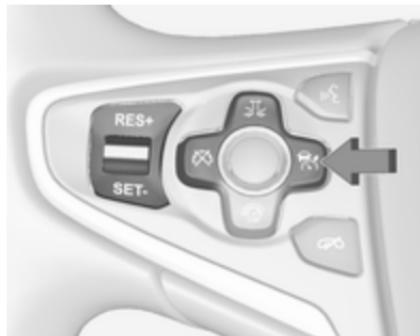
Pritisnite gumb za vklop adaptivnega tempomata. Kontrolna lučka ali na instrumentni plošči sveti belo.
