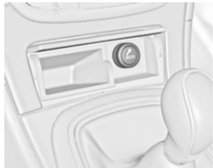
Vžigalnik pritisnite navznoter. Vžigalnik se samodejno izklopi in izskoči iz ležišča, ko je spirala razžarjena. Vžigalnik izvlecite.
