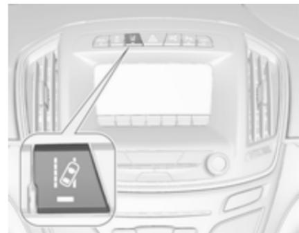
Sistem za opozorilo o nenamerni menjavi voznega pasu se aktivira s pritiskom gumba . LED v stikalju označuje, da je sistem vključen. Kadar kontrolna lučka na instrumentni tabli sveti zeleno, je sistem pripravljen na delovanje.
