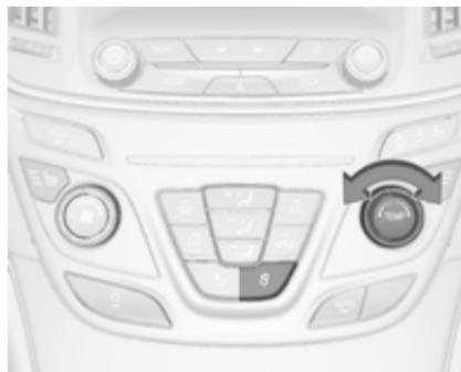
Nastavite temperaturo z vrtenjem regulatorja **TEMP** na želeno vrednost.
