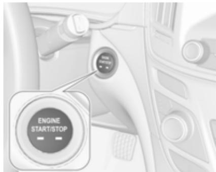
gumb za vklop: pritisnite in sprostite gumb **Engine Start/Stop**
