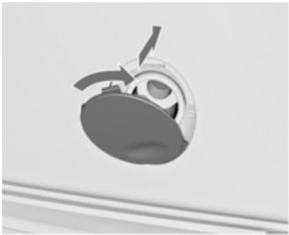
**5-vratna izvedba, 4-vratna limuzina, Sports Tourer, OPC:** vstavite spodnji pokrov, ga zavrtite malo v desno in zaprite.
