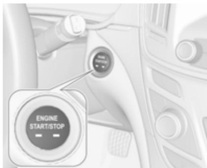
Ročni menjalnik: pritisnite sklopko in zavorni pedal.
