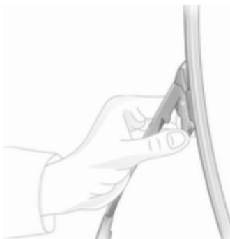
Dvignite brisalec. Pritisnите обa zaklopca na brisalcu in odstranite metlico brisalca.
