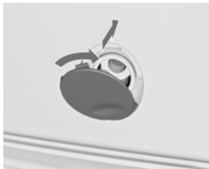
**5-vratna izvedba, 4-vratna limuzina, Sports Tourer:** vstavite spodnji pokrov, ga zavrtite malo v desno in zaprite.
