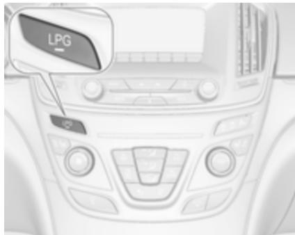
S pritiskom gumba **LPG** preklapljate med pogonom na bencin in pogonom na utekočinjen naftni plin. Lučka LED za stanje ─ kaže trenutni način delovanja.
