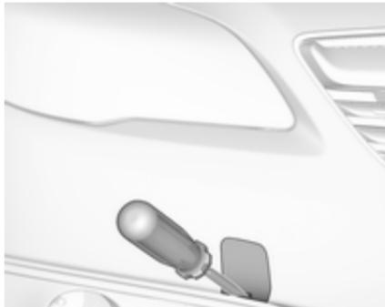
**Country Tourer:** Vstavite izvijač v režo v spodnjem robu pokrova. Odpnite pokrov s previdnim pomikom izvijača navzdol. Za zaščito vstavite med izvijač in okvir mehko krpo.
