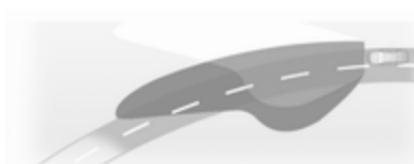
Zgubi žarometov se obračajo v odvisnosti od zavoja volana in hitrosti vozila za boljšo osvetlitev zavojev. Kontrolna lučka
