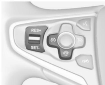
Pritisnite tipko . Kontrolna lučka na instrumentni plošči sveti belo. Če je tempomat ali adaptivni tempomat že prej aktiviran, se izklopi, ko se aktivira omejevalnik hitrosti, zato ugasne kontrolna lučka .
