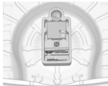
Orodje in vlečno uho sta spravljena skupaj v kompletu za popravilo pnevmatik v škatli z orodjem pod talnim pokrivalom v prtljažniku.
