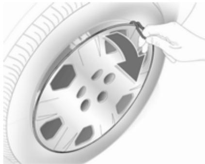
1. Pokrove vijakov odstranite s pomočjo izvijača. S kavljem iztaknite in snemite okrasni pokrov kolesa. Orodje vozila ⇨ 245.
