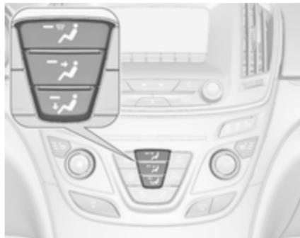
Pritisnite ustrezen gumb za želeno nastavitev. Vklop signalizira LED indikator v stikalu.
