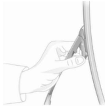
Dvignite brisalec. Pritisnite oba zaklopca na brisalcu in odstranite metlico brisalca.
