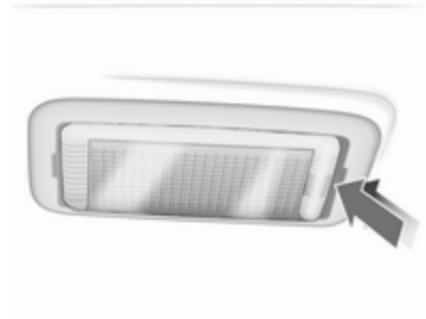
1. Luč iztaknite z izvijačem.
