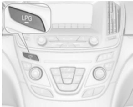
Pritisnite **LPG** za preklop med bencinskim in plinskim pogonom, takoj ko so izpolnjeni zahtevani pogoji (temperatura hladilne tekočine, temperatura plina in minimalno število vrtljajev motorja). Ti pogoji so običajno izpolnjeni po približno 60 sekundah (odvisno od zunanje temperature) in prvem odločnejšem pritisku na pedal za plin. Stanje LED lučk opozarja na trenutni način delovanja.
