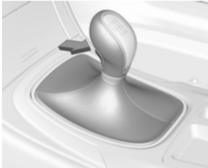
Vzratno prestavo vklopite, ko vozilo miruje: pritisnite pedal sklopke, pritisnite gumb na prestavni ročici in prestavite.
