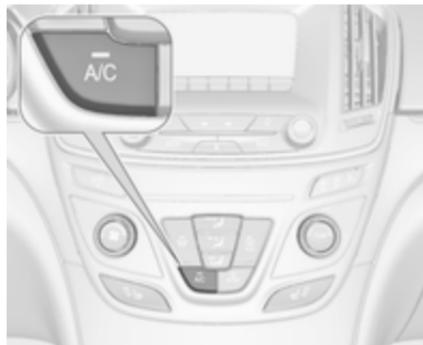
Za vklop hlajenja pritisnite **A/C**. Vkllop signalizira LED indikator v stikalu. Hlajenje deluje samo, kadar teče motor in je vključen ventilator sistema za ogrevanje, prezračevanje, hlajenje.
