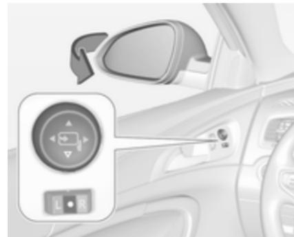
Element za upravljanje preklopite na ● in potisnite krmilni gumb ▽ navzdol. Obe zunanji ogledali se preklopita.
