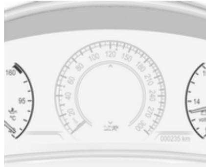
Na levi in desni strani merilnika hitrosti je prikazan merilnik za "Temperaturo olja", "Oljni tlak" ali "Napetost akumulatorja", odvisno od nastavitve na zaslonu višje stopnje.
