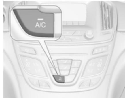
Za vklop hlajenja pritisnite **A/C**. Vkllop signalizira LED indikator v stikalu. Hlajenje deluje samo, kadar teče motor in je vključen ventilator sistema za ogrevanje, prezračevanje, hlajenje.
