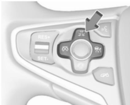
Pritisnite . Trenutna nastavev se prikaže na informacijskem centru voznika. Za spremembo občutljivosti opozorila znova pritisnite . Nastavev se prikaže tudi na voznikovem informacijski zaslonu.
