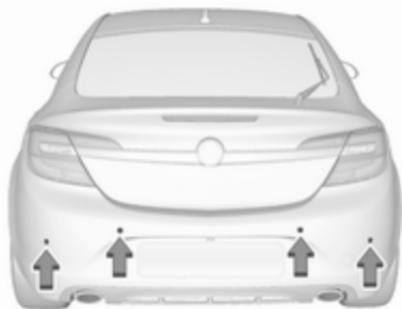
Parkirni pomočnik spredaj-zadaj meri razdaljo med vozilom in ovirami pred in za vozilom. Sistem oddaja zvočna opozorila in prikazuje sporočila.
