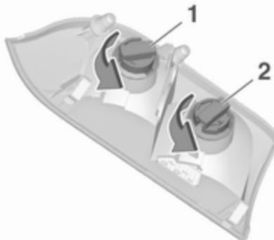
4. Odvijte plastično matico v obratno smer urinega kazalca in izvlcite iz nosilca žarnice.
