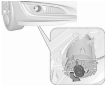
1. Nosilec žarnice odvijte v nasprotno smer urinega kazalca in ga odstranite iz žarometa.
