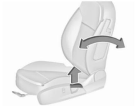
Potegnite vzvod, nastavite naklon in sprostite vzvod. Sedež naj se primerno zaskoči.
