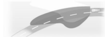
Zglobi žarometov se obračajo v odvisnosti od zavoja volana in hitrosti vozila za boljše osvetlitev zavojev.
