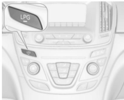
S pritiskom **LPG** preklapljate med pogonom na bencin in pogonom na utekočinjen naftni plin. Lučka LED za stanje
