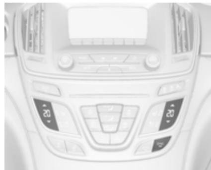
Nastavite želeno temperaturo z dotikom ▲ za višje temperature ali ▼ za nižje temperature.
