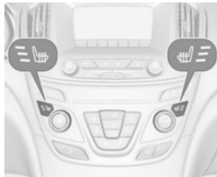
Nastavite zeleno stopnjo ogrevanja s pritiskom na
