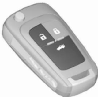
Za odklepanje vrat ter prtljažnika pritisnite
