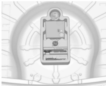
Orodje in vlečno uho sta spravljena skupaj v kompletu za popravilo pnevmatik v škatli z orodjem pod talnim pokrivalom v prtljažniku.
