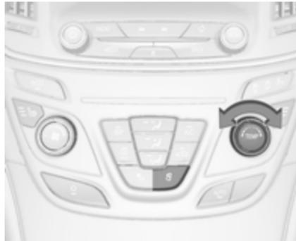
Nastavite temperaturo z vrtenjem regulatorja **TEMP** na zeleno vrednost.
