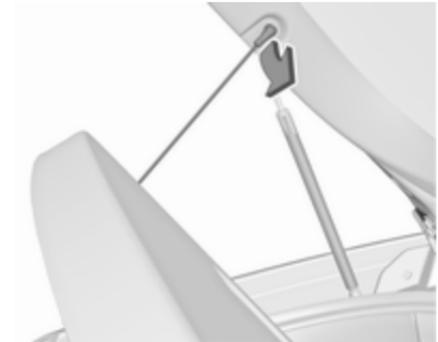
Iztaknite nosilni vrvič z vrat prtljažnika.
