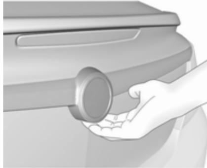
Po odklepanju potegnite gumb pod oblogo vrat prtljažnika in ročno odprite vrata prtljažnika.
