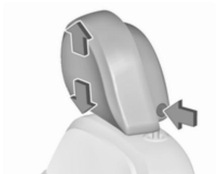
S pritiskom gumba sprostite vzglavnik, nastavite višino in pustite, da se zaskoči v zavarovani položaj.
