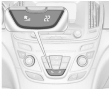
Nastavitvi temperature in hitrosti ventilatorja so označene na prikazovalniku klimatske naprave.
