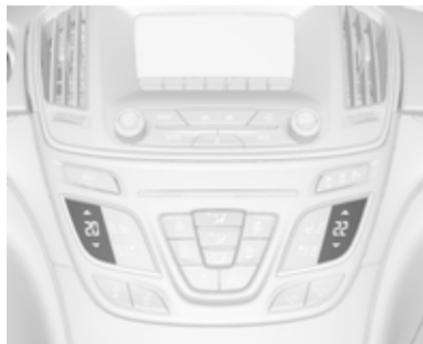
Nastavitve temperature so za voznika in sovoznika ločeno označeni na ploščah.
