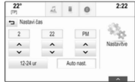
Izberite gumb **Auto nast.** na dnu zaslona. Vključite način **Vklop - RDS** ali **Izklop - samodejno**.
