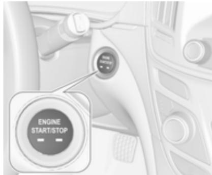
Ročni menjalnik: pritisnite sklopko in zavorni pedal.
