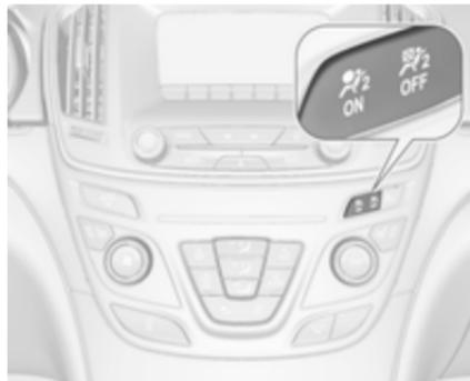
Kadar kontrolna lučka
