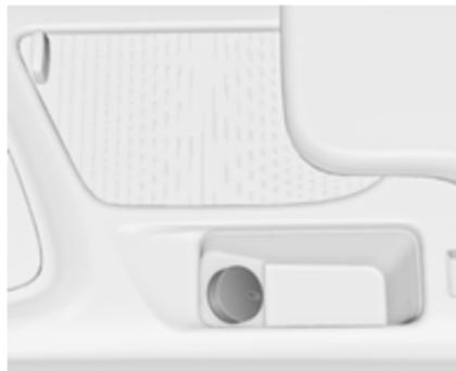
Dodatne 12-voltna vtičnica so vgrajene v sprednjem in zadnjem delu sredinske konzole.
