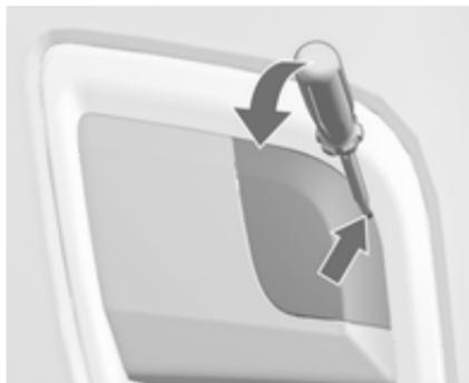
**OPC:** vstavite izvijač v odprtino na zgornjem robu pokrova. Odpnite pokrov s previdnim pomikom izvijača navzdol. Za zaščito vstavite med izvijač in okvir mehko krpo.
