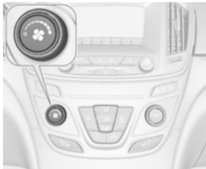
Nastavite pretok zraka z obračanjem krmilnika 🌀 do zelene hitrosti. **O** pomeni izklop ventilatorja.
