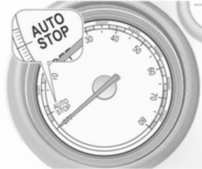
Režim Autostop označuje kazalec v legi **AUTOSTOP** na števcu vrtljajev motorja. Na nekaterih različicah zasveti kontrolna lučka v instrumentni plošči, ko je motor v načinu samodejne zaustavitve.
