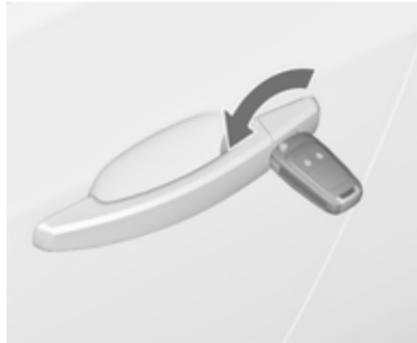
Odklenite voznikova vrata z obratom ključa v ključavnici. Vključite kontakt in pritisnite stikalo
