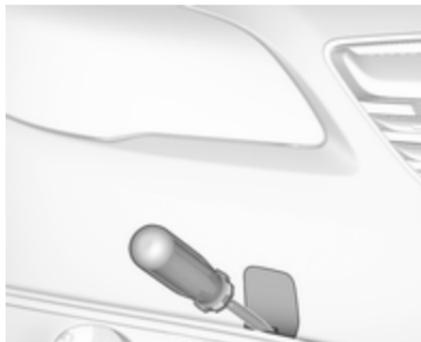
**Country Tourer:** Vstavite izvijač v režo v spodnjem robu pokrova. Odpnite pokrov s previdnim pomikom izvijača navzdol. Za zaščito vstavite med izvijač in okvir mehko krpo.
