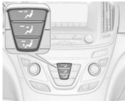
Pritisnite ustrezen gumb za zeleno nastavitev. Vkllop signalizira LED indikator v stikalu
