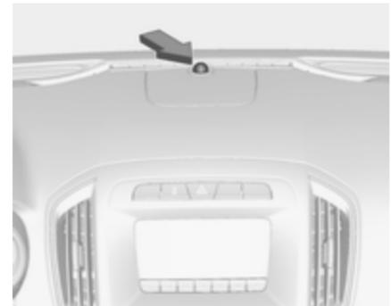
Varnostni LED indikator je integriran v senzor na armaturni plošči.
