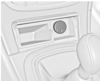
12-voltna električna vtičnica je za pokrovom predala za shranjevanje, pod upravnimi elementi klimatske naprave. Za odpiranje pritisnite pokrov.
