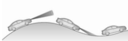
Učinkovitost sistema v klancih je odvisna od hitrosti vozila, obremenjenosti vozila, razmer na cesti in vrste ceste. Sistem med vožnjo po klancih morda ne bo zaznal vozila na vaši poti. Na strmih klancih boste morda morali uporabiti stopalko za plin, da ohranite hitrost vozila. Pri vožnji po klancu navzdol boste morda morali zavirati, da bi ohranili ali zmanjšali hitrost.
