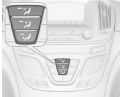
Pritisnite ustrezen gumb za zeleno nastavitvev. Vkllop signalizira LED indikator v stikalu
