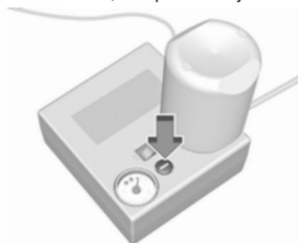
Če predpisan tlak ni dosežen v roku 10-ih minut, odstranite komplet za popravilo pnevmatik. Premaknite vozilo za en obrat kolesa. Ponovno priključite komplet za popravilo pnevmatik in nadaljujte s postopkom polnjenja pnevmatike še dodatnih 10 minut. Če predpisan tlak tudi po naknadnih 10-ih minutah ni dosežen, je pnevmatika preveč poškodovana. Poiščite strokovno pomoč v servisni delavnici. Presežek tlaka izpustite s pritiskom na gumb nad številčnico kompresorja.
