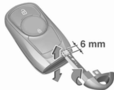
2. Znova vstavite ključ približno 6 mm globoko in ga obrnite, da odprete ohišje. Če ključ potisnete globlje, lahko poškodujete ohišje.
