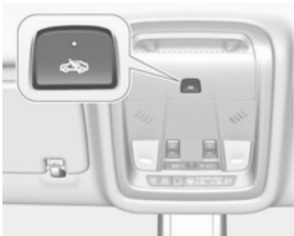
Nadziranje potniškega prostora in nagiba vozila izključite, če pustite v vozilu kakšno žival, ker se utegne sprožiti alarm zaradi gibanja v vozilu, ultrazvočnih valov in nagibanja vozila pri prevozu. Nadziranje potniškega prostora in nagiba vozila prav tako izključite pri prevozu na ladji ali vlaku.
