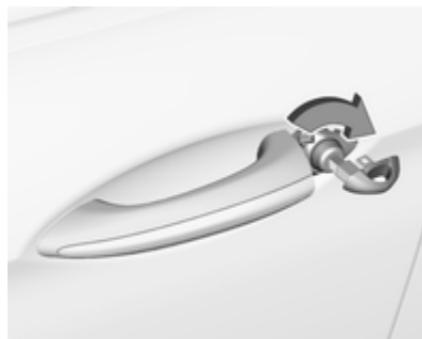
Zatiče za zaklepanje na vseh vratih razen voznikovih potisnite navznoter ali pa na plošči na voznikovih vratih pritisnite
