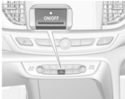
Hlajenje, ventilator in samodejni način lahko izklučite s pritiskom **ON/OFF**. Če je sistem izklopljen, lučka LED v gumbu **ON/OFF** ne sveti.
