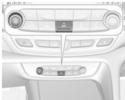
Za vklop hlajenja pritisnite **A/C**. Vklop signalizira LED indikator v stikalnu. Hlajenje deluje samo, kadar teče motor in je vključen ventilator sistema za ogrevanje, prezračevanje, hlajenje.
