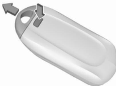
Pritisnite gumb na elektronskem ključu in izvlecite običajni ključ.
