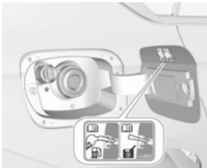
Omejevalo za preprečevanje dolivanja napačne vrste goriva omogoča odpiranje polnilne odprtine smo s točilno ročko ustreznou vrsto goriva ali lijem za dolivanje goriva v sili.
