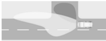
Pri zavijanju na odcepih se na podlagi kota volana in vklopljenega smernika vklopijo določene lučke LED, ki osvetlijo smer vožnje. Funkcija deluje le pod hitrostjo 40 km/h.
