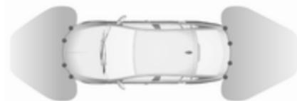
Sistem vsebuje štiri senzorje, vgrajene v zadnjem in sprednjem odbijaču.
