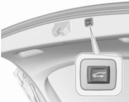
Za zapiranje vrat prtljažnika pridržite pritisnjeno na odprtih vratih, dokler se vrata ne pričnejo zapirati.
