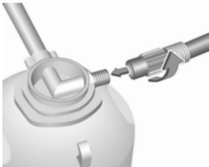
**2. 1. vrsta:** zračno cev tlačile privijte na priključek na plastenki s tesnilnim sredstvom in plastenko s tesnilnim sredstvom pritrdite v ležišče na kompresorju.
