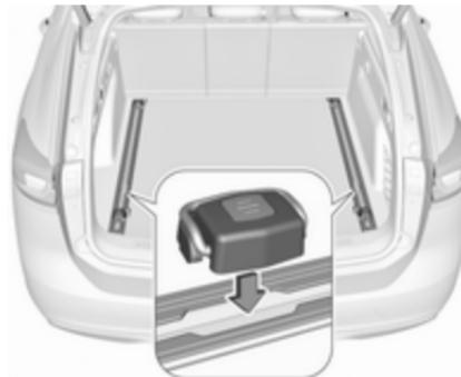
Nosilce vstavite v tračnici na dnu prtljažnika. Vstavite ga v vdri del na tračnici in pritisnite gumb na nosilcu.
