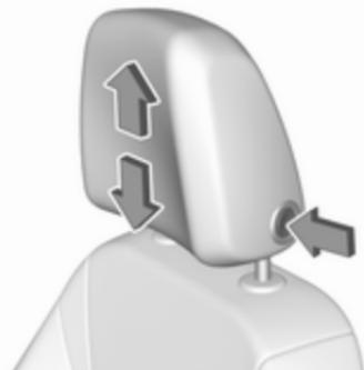
S pritiskom gumba sprostite vzglavnik, nastavite višino in pustite, da se zaskoči v zavarovani položaj.
