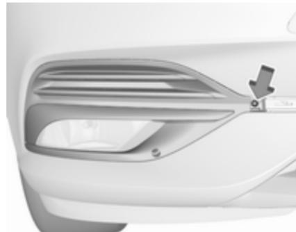
Odvijte vijak in odstranite čelno ploščo.
