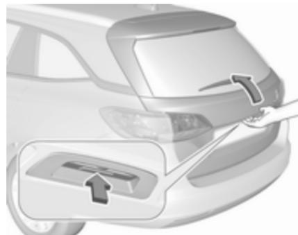
Za odpiranje vrat prtljažnika pritisnite tipko pod prijemkom vrat, dokler se vrata ne pričnejo odpirati. Če je vozilo zaklenjeno, mora biti elektronski oddajnik v dometu zunanjega sprejema antene, približno en meter od vrat prtljažnika.
