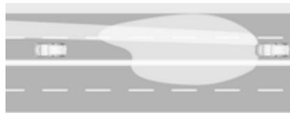
Pomočnik za dolge luči ima poseben način delovanja za avtoceste. Če po avtocesti vozite s hitrostjo nad 115 km/h on, se svetlobni snop dolgih
