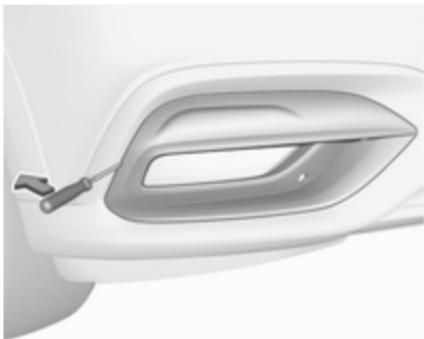
Izvijač potisnite v dolbino in ga uporabite kot vzvod, da odstranite čelno ploščo.
