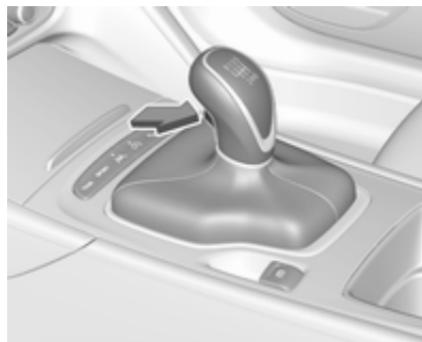
Vzvratna prestava: ko vozilo miruje, pritisnite pedal sklopke, pritisnite gumb na prestavnih ročicah in prestavite. Ročni menjalnik ⇨ 182.
