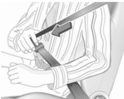
Enakomerno potegnite pas iz navjalca, ga nezvitega namestite čez telo in vstavite zaponko v zaklep, da
