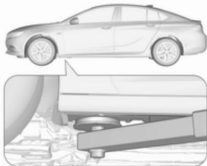
Sprednji položaj roke dvigalke sredinsko pod ustreznou dvigalno točko vozila.
