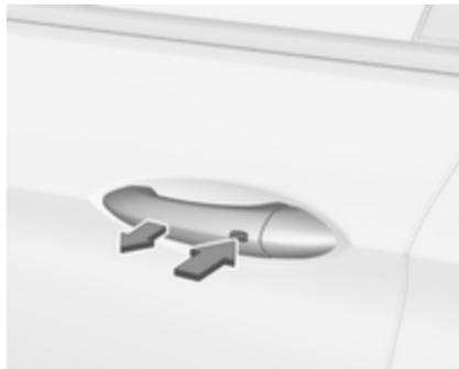
Pritisnite gumb na ustrejni ročici zunanjih vrat in potegnite ročico.
