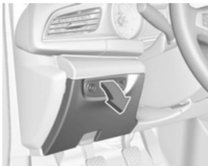
Pri modelih z volanom na levi: omarica z varovalkami je pod pokrovom na armaturni plošči.
