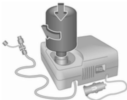
**2. vrsta:** odstranite navojna čepa s kompresorja in plastenke s tesnilnim sredstvom. Plastenko privijte na kompresor, ne da bi s plastenke odstranili zaščitno folijo.
