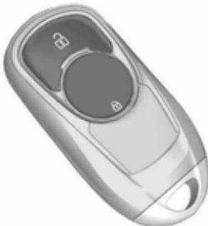
Za odklepanje vrat ter prtljažnika pritisnite ③. Odprite vrata s potegom kljuke na vratih. Če želite odpreti vrata prtljažnika, pritisnite značko znamke in jih odprite.
