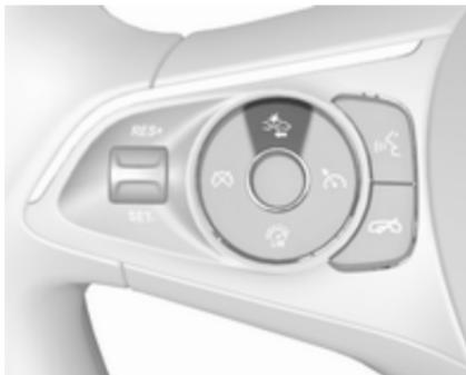
S prvim pritiskom gumba na voznikovem informacijskem zaslonu prikažete trenutno nastavitev. Nastavitev spremenite z naknadnim pritiskanjem istega gumba. Izbrana nastavitev se ohrani, dokler je ne spremenite. Čas vklopa opozoril je odvisen od hitrosti vozila. Večja ko je hitrost vožnje, večja bo razdalja, pri kateri se bo pojavilo opozorilo. Pri izbiranju nastavitev časa prikaza opozorila upoštevajte prometne in vremenske razmere.
