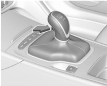
Za vklop vzvratne prestave pritisnite pedal sklopke, pritisnite sprostiljeni gumb na izbirni ročici in prestavite.
