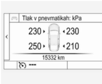
Stanja sistema in opozorila v zvezi s tlakom se prikažejo kot sporočilo zadevne pnevmatike na voznikovem informacijskem zaslonu.
