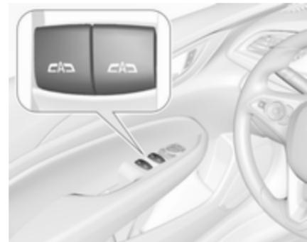
Za odpiranje želenega okna pritisnite **cla**, za zapiranje okna pa povlecite stikalo.
