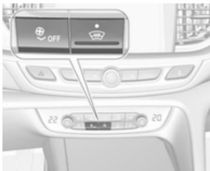
Če je vozilo opremljeno z ogrevanim vetrobranskim stekлом, ima namesto gumba **ON/OFF** gumb
