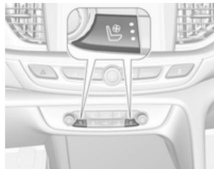
Nastavite želeno stopnjo zračenja s pritiskom na enkrat ali večkrat. Indikator v stikalu označuje nastavitev.
