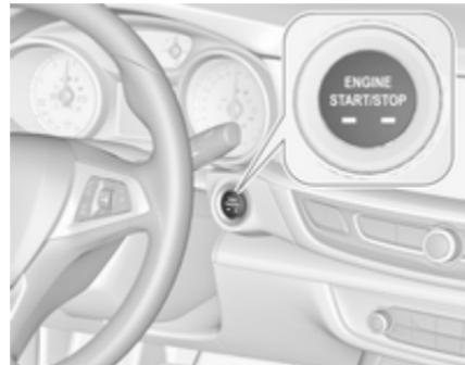
Ročni menjalnik: pritisnite sklopko in zavorni pedal.
