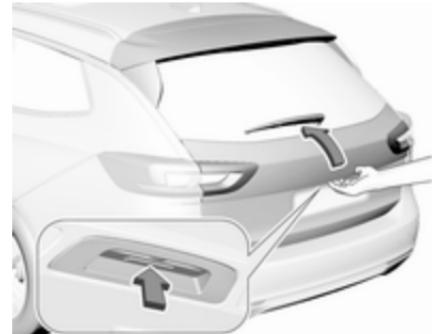
Za odpiranje vrat prtljažnika se dotaknite stikala pod prijemkom na vratih prtljažnika po odklepanju.
