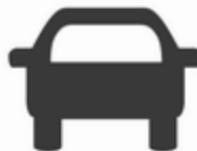
Prižge se zelena lučka "spredaj vožeče vozilo" 🚗, če sistem zazna vozilo v smeri vožnje pred vami. Domet senzorjev je med 25 in 150 metrov, odvisno od hitrosti vozila. Opozorilo za trk spredaj ⇨ 203. Če se ta simbol ne prikaže, ali se prikaže na kratko, se prilagodljivi regulator hitrosti ne bo odzval na vozila pred vami.
