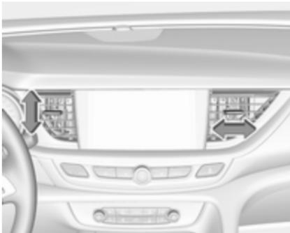
Na ilustraciji sta prikazani sredinski zračni šobi na armaturni plošči.
