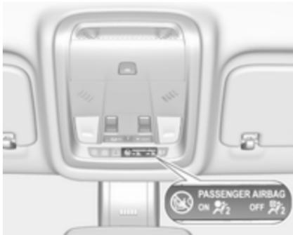
Če kontrolna lučka po vklopu kontakta vžiga sveti pribl. 60 sekund, je sistem varnostnih blazin na sovoznikovi strani aktiven in se bo v primeru trka sprožil.
