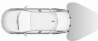
Sistem vsebuje štiri senzorje, vgrajene v zadnjem odbijaču.
