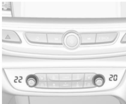
Po želji nastavite temperaturo posebej za voznikovo in sovoznikovo stran z levim in desnim krmilnim gumbom. Z vrtljivim gumbom na sovoznikovi strani spremenite temperaturo na sovoznikovi strani. Z vrtljivim gumbom na voznikovi strani spremenite temperaturo na voznikovi strani ali na obeh straneh, če je vklopljena sinhronizacija **SYNC**. Priporočamo temperaturo 22 °C. Temperatura se za kratek čas prikaže v obliki pojavnega okna ob krmilnih gumbih na informacijskem prikazovalniku.
