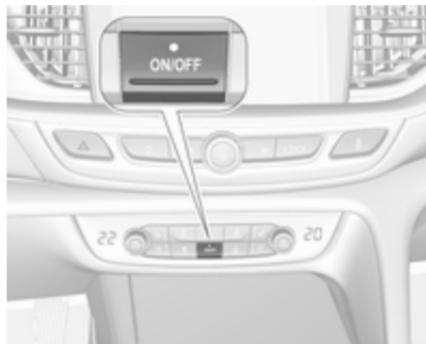
Hlajenje, ventilator in samodejni način lahko izklopite s pritiskom gumba **ON/OFF**. Če je sistem izklopljen, lučka LED v gumbu **ON/OFF** ne sveti. Vklop potrdite s ponovnim pritiskom gumba **ON/OFF** ali **AUTO**. LED dioda v gumbu sveti in s tem označuje vključeno stanje.
