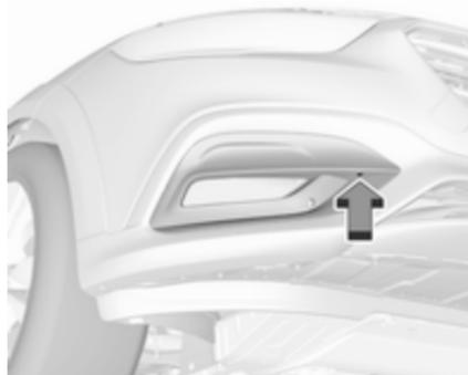
Vijak odvijte z izvijačem torx.
