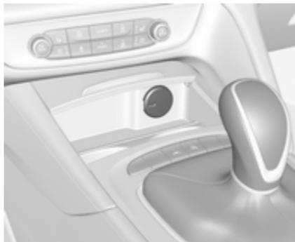
12 voltna električna vtičnica se nahaja v sredinski konzoli. Pri izključenem kontaktu je ta električna vtičnica brez napetosti.
