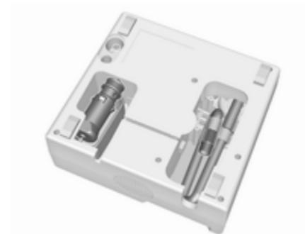
1. Vzemite iz predalčkov na spodnji strani kompresorja električni kabel s priključkom in zračno cev.
