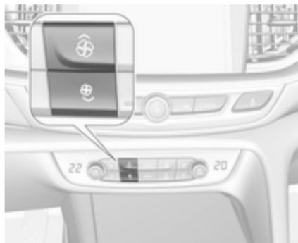
Hitrost ventilatorja povečate z zgornjim gumbom ☼, zmanjšate pa s spodnjim ☾. Hitrost ventilatorja se prikaže kot pojavno okno na informacijskem zaslonu. Hitrost ventilatorja lahko spremenite tudi z gumboma na dotik na zaslonu nastavitve klimatske naprave. Pritisnite **Climate**, da odprete meni.
