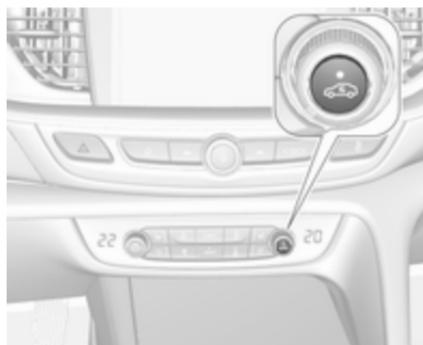
Za vklop kroženja zraka pritisnite
