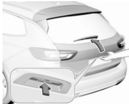
Za odpiranje vrat prtljažnika pritisnite tipko pod prijemkom vrat, dokler se vrata ne pričnejo odpirati. Če je vozilo zaklenjeno, mora biti elektronski oddajnik v dometu zunanega sprejema antene, približno en meter od vrat prtljažnika.
