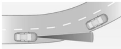
Prilagodljivi regulator hitrosti izračuna predvideno pot na osnovi centrifugalne sile. Ta predvidena pot upošteva značilnosti trenutnega zavoja, vendar pa ne more upoštevati spremembe zavoja v prihodnje. Sistem lahko izgubi vozilo pred vami ali upošteva vozilo ki ni na vašem voznem pasu. To se lahko zgodi ob vstopu v zavoj ali izstopu iz njega ali
