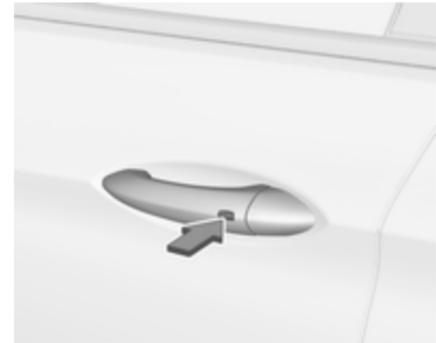
Odklepanje vozila s pritiskom gumba na katerih koli zunanjih vratih izključi alarmno napravo.
