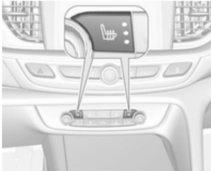
Nastavite zeleno stopnjo ogrevanja s pritiskom na
