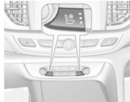
Nastavite zeleno stopnjo zračenja s pritiskom na
