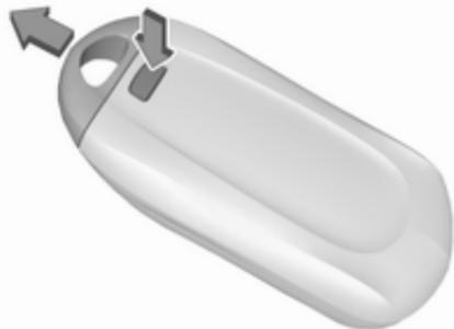
1. Pritisnite gumb za zadnji strani elektronskega ključa in ključ izvlecite iz ohišja.
