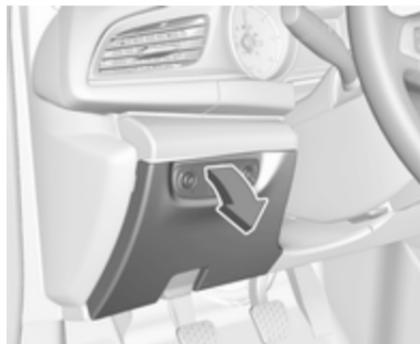
Pri modelih z volanom na levi: omarica z varovalkami je pod pokrovom na armaturni plošči. Pokrov sprostite ob strani in ga odstranite.
