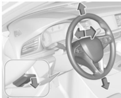
Sprostite ročico, nastavite volan, zataknete ročico v zavarovan položaj.
