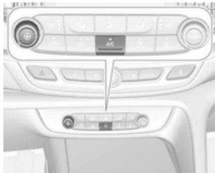
Za vklop hlajenja pritisnite **A/C**. Vklop signalizira LED indikator v stikalu. Hlajenje deluje samo, kadar teče motor in je vključen ventilator sistema za ogrevanje, prezračevanje, hlajenje.
