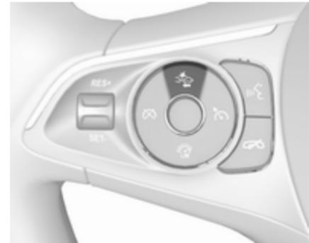
S prvim pritiskom gumba na voznikovem informacijskem zaslonu prikažete trenutno nastavitve. Nastavitve spremenite z naknadnim pritiskanjem istega gumba. Izbrana nastavitve se ohrani, dokler je ne spremenite. Čas vklopa opozoril je odvisen od hitrosti vozila. Večja ko je hitrost vožnje, večja bo razdalja, pri kateri se bo pojavilo opozorilo. Pri izbiranju nastavitve časa prikaza opozorila upoštevajte prometne in vremenske razmere.
