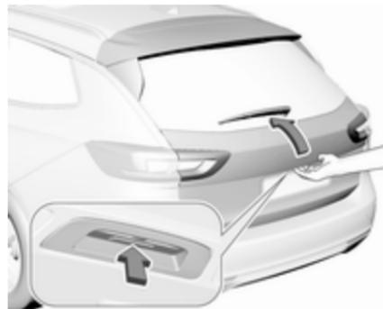
Za odpiranje vrat prtljažnika se dotaknite stikala pod vdolbino na vratih prtljažnika po odklepanju. Centralno zaklepanje ⇨ 24.
