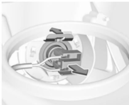
2. Sprostite držalo žarnice tako, da zaponko potisnete naprej. Izvlecite držalo žarnice iz ohišja žarometu.
