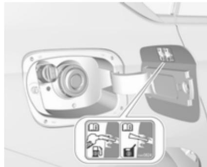
Omejevalo za preprečevanje dolivanja napačne vrste goriva omogoča odpiranje polnilne odprtine smo s točilno ročko ustrezno vrsto goriva ali lijem za dolivanje goriva v sili.
