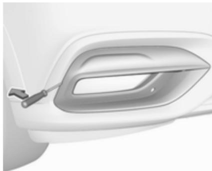
Okoli konice ploskega izvijača ovijte krpo, da preprečite poškodbo laka. Izvijač potisnite v režo in ga uporabite kot vzvod pri odstranjevanju.
