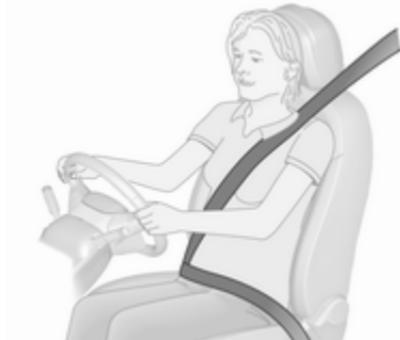
Izvlomite varnostni pas in ga zataknete v zaklep. Bočni del pasu ne sme biti zviti na nobenem delu in se mora tesno prilagati k telesu. Naslonjalo naj ne bo nagnjeno preveč nazaj (priporočen kot nagiba: največ 25°).
