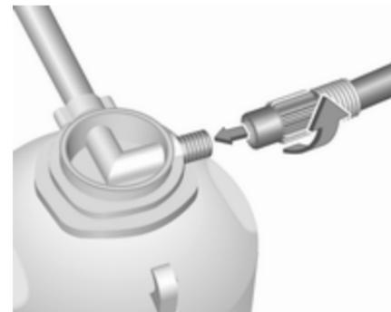
2. **1. vrsta:** zračno cev tlačile privijte na priključek na platenki s tesnilnim sredstvom in platenko s tesnilnim sredstvom pritrdite v ležišče na kompresorju.
