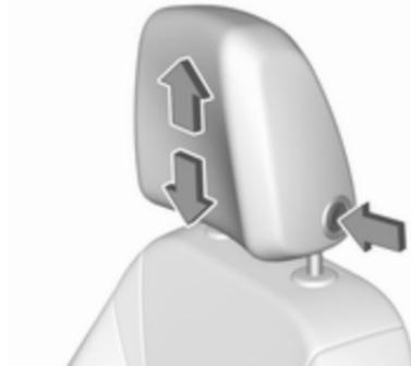
S pritiskom gumba sprostite vzglavnik, nastavite višino in pustite, da se zaskoči v zavarovani položaj.
