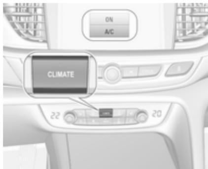
Pritisnite **Climate**, da odprete meni, nato pa z gumboma na dotik **A/C ON** in **A/C OFF** vklopite/izklopite klimatsko napravo.
