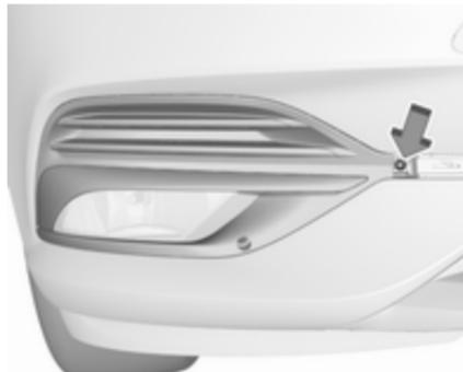
Vijak odvijte z izvijačem torx in odstranite čelno ploščo.
