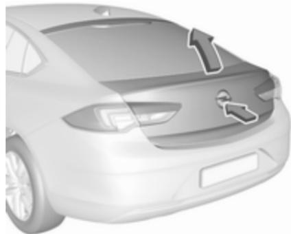
Po odklepanju pritisnite značko znamke in odprite vrata prtljažnika.
