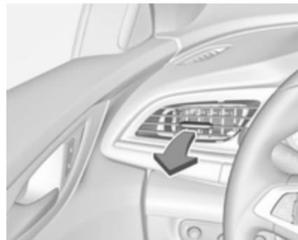
Na ilustraciji sta prikazani stranski zračni šobi na armaturni plošči.
