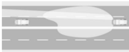
Pomočnik za dolge luči ima poseben način delovanja za avtoceste. Če po avtocesti vozite s hitrostjo nad 115 km/h on, se svetlobni snop dolgih
