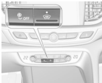
Če je vozilo opremljeno z ogrevanim vetrobranskim steklom, ima namesto gumba **ON/OFF** gumb
