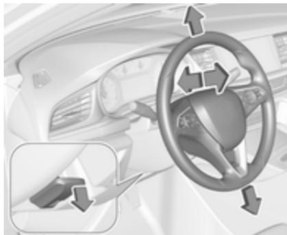
Sprostite ročico, nastavite volan, zatakните ročico v zavarovan položaj. Volana ne nastavljajte pri premikajočem vozilu in/ali blokiranem volanu.
