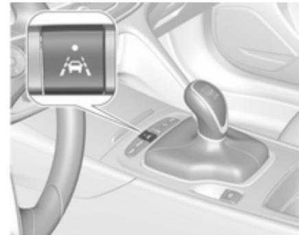
Pomočnik za ohranjanje voznega pasu vklopite s pritiskom na stikalo zasveti, da prikaže, da je sistem vključen.
