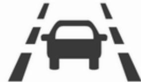
Ko kontrolna lučka na instrumentni plošči ali na nadglavnem zaslonu zasveti v zeleni barvi, je sistem pripravljen za izvajanje funkcije pomoči.
