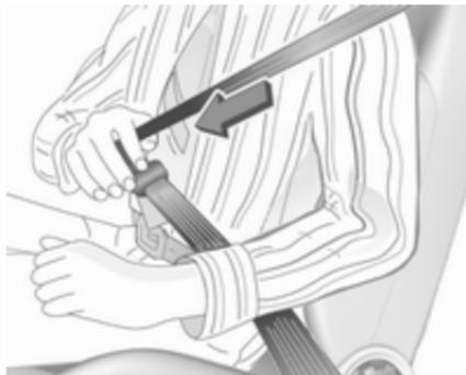
Enakomerno potegnite pas iz navijalca, ga nezvitega namestite čez telo in vstavite zaponko v zaklep, da
