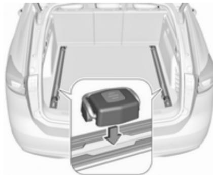
Nosilce vstavite v tračnici na dnu prtljažnika. Vstavite ga v vdrti del na tračnici in pritisnite gumb na nosilcu.
