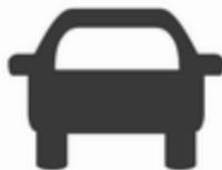
Prižge se zelena lučka "spredaj vožeče vozilo" 🚗, če sistem zazna vozilo v smeri vožnje pred vami. Domet senzorjev je med 25 in 150 metrov, odvisno od hitrosti vozila.
