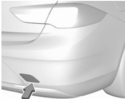
Okoli konice ploskega izvijača ovijte krpo, da preprečite poškodbo laka. Potisnite izvijač za rob pokrova. Previdno odstranite pokrov, pri čemer izvijač uporabite kot vzvod.
