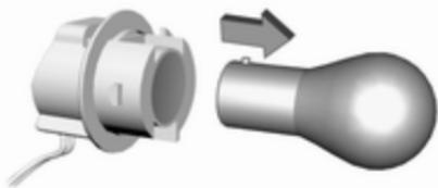
4. Žarnico smernika iztaknite iz nosilca in vstavite novo.
