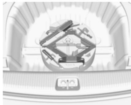
Dvigalka s ključem za kolesa, orodje, dolgi vijak za pritrditev poškodovanega kolesa in vlečno uho so spravljeni v škatli z orodjem pod rezervnim kolesom v prtljažniku.
