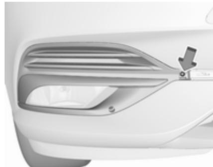
Vijak odvijte z izvijačem torx in odstranite čelno ploščo.
