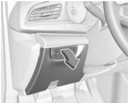
Pri modelih z volanom na lev: omarica z varovalkami je pod pokrovom na armaturni plošči.
