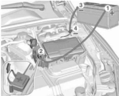
Odprite pokrova za zaščito pozitivnega pola na akumulatorjih obeh vozil.
