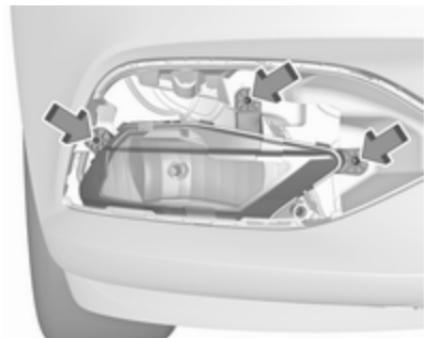
3. Tri vijke odvijte z izvijačem torx in sklop luči povlecite naprej.
