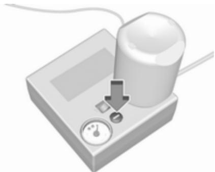
Presežek tlaka izpustite s pritiskom na gumb nad številčnico kompresorja.
