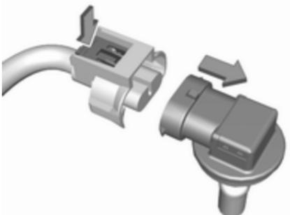
5. Pritisnite držalno ušesce in odpnite nasadni priključek.
