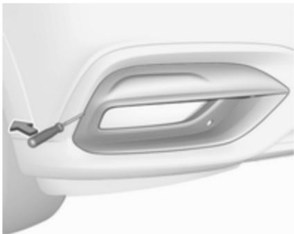
Okoli konice ploskega izvijača ovijte krpo, da preprečite poškodbo laka. Izvijač potisnite v režo in ga uporabite kot vzvod pri odstranjevanju.
