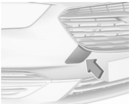
Okoli konice ploskega izvijača ovijte krpo, da preprečite poškodbo laka. Potisnite izvijač za rob pokrova. Previdno odstranite pokrov, pri čemer izvijač uporabite kot vzvod.
