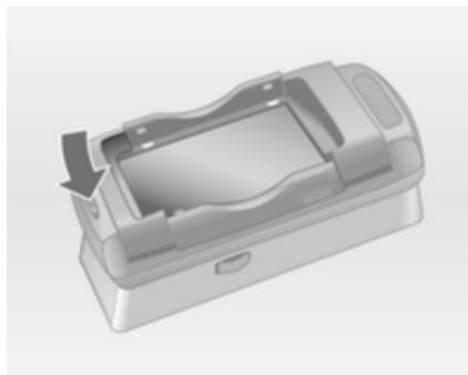
Če sta stranska nosilca na vmesniku v zaprtem položaju, pritisnite gumb poleg sprednjega roba vmesnika za odpiranje nosilcev.
