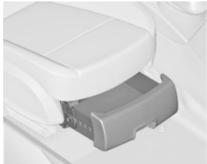
S prijemom izdolbljenega robu privzdignite predal in ga povlecite naprej. Maksimalna nosilnost: 3 kg. Zapiranje predala: potisnite ga pod sedež, da se zatakne.
