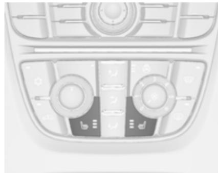
Nastavite želeno stopnjo ogrevanja s pritiskom ustreznega stikala
