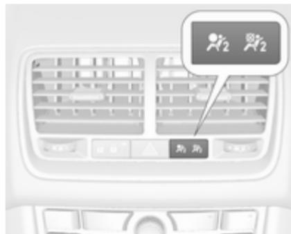
Dokler kontrolna lučka **☒** sveti, se sovoznikova varnostna blazina sproži v primeru trka.
