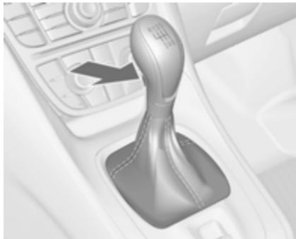
Vzvratna prestava: ko vozilo miruje, pritisnite pedal sklopke, pritisnite gumb na prestavni ročici in prestavite.
