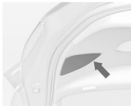
1. Odprite vrata prtlažnika in odstranite pokrov z izvijačem.
