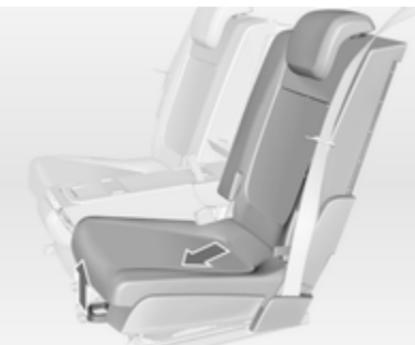
Potegnite ročico in potisnite sedež prečno naprej v položaj 2. Sedež se samodejno zapelje navzven. Sprostite ročico in pustite, da se sedež zaskoči v zavarovan položaj.
