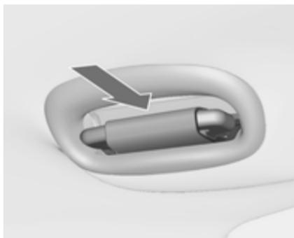
Pas z zaponkama, obrnjenima proti odprtini, vstavite v držalo v stropni prevleki.
