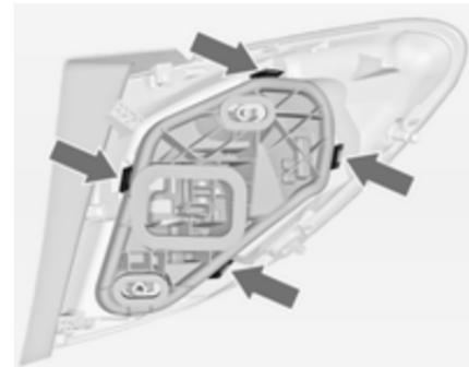
5. Odpnite štiri nosilne zaponke in odstranite nosilec žarnic.
