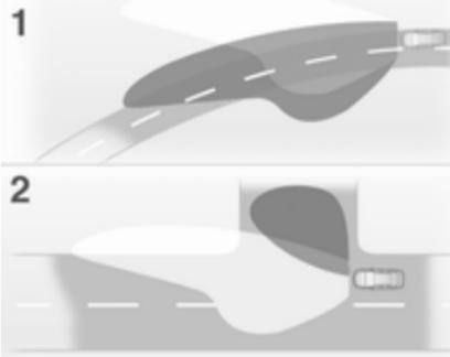
Zglobi žarometov se obračajo v odvisnosti od zavoja volana in hitrosti vozila.
