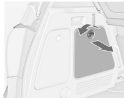
Obrnite zaklep v levo in preklopite pokrov navzdol.
