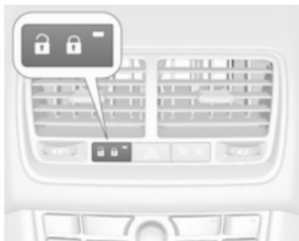
LED dioda za signaliziranje stanja je integrirana v stikalu za centralno zaklepanje.
