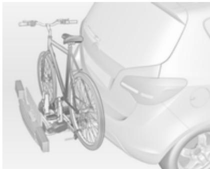
Zadnji nosilec (Flex-Fix sistem) omogoča nameščanje dveh koles na raztegljiv nosilec, ki je integriran v dnu vozila.
