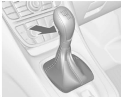
Vzvrtna prestava: ko vozilo miruje, pritisnite pedal sklopke, pritisnite gumb na prestavni ročici in prestavite.
