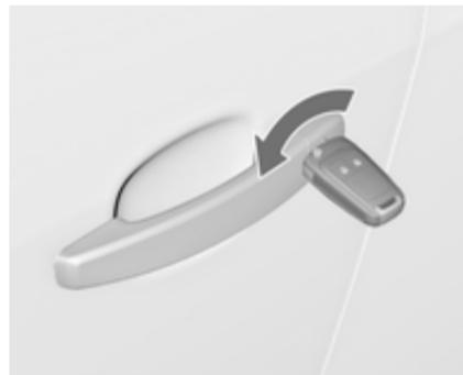
Odklenite voznikova vrata z obratom ključa v ključavnici. Vključite kontakt in pritisnite stikalo za odklepanje vseh vrat, prtljažnika in lopute rezervoarja goriva. Za deaktiviranje mehanskega varovanja (zapaha) vključite kontakt ↻ 27.
