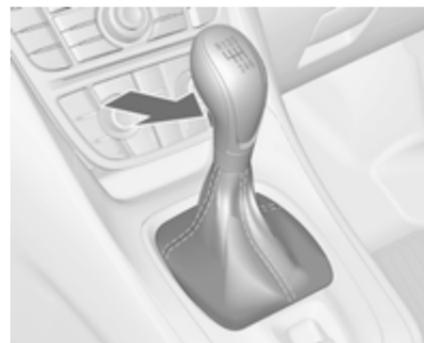
Vzvratno prestavo vklopite, ko vozilo miruje: pritisnite pedal sklopke, pritisnite gumb na prestavni ročici in prestavite.
