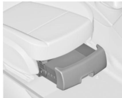
S prijemom izdobljenega robu privzdignite predal in ga povlecite naprej. Maksimalna nosilnost: 3 kg. Zapiranje predala: potisnite ga pod sedež, da se zatakne.
