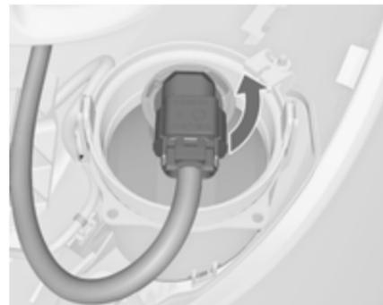
1. Nosilec žarnice odvijte v nasprotno smer urinega kazalca in ga odstranite iz žarometu.
