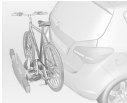
Zadnji nosilec (Flex-Fix sistem) omogoča nameščanje dveh koles na raztegljiv nosilec, ki je integriran v dno vozila. Prevoz drugih stvari ni priporočljiv.
