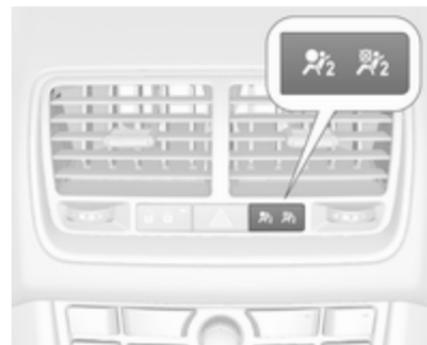
Dokler kontrolna lučka P2 sveti, se sovoznikova varnostna blazina sproži v primeru trka.
