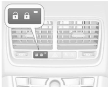
Pritisnite stikalo za centralno zaklepanje: vsa vrata se simultano zaklenejo ali odklenejo. Če so vrata zaklenjena, sveti LED indikator v stikalu.
