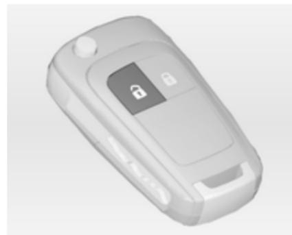
Pri izključenem kontaktu pritisnite tipko
