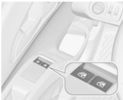
Za odpiranje zelenega okna pritisnite ustrezno stikalo in za zapiranje okna stikalo potegnite.
