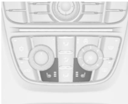
Nastavite želeno stopnjo ogrevanja s pritiskom ustreznega stikala
