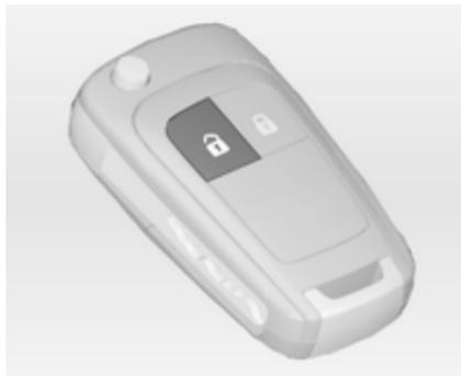
Za odklepanje vrat ter prtljažnika pritisnite tipko
