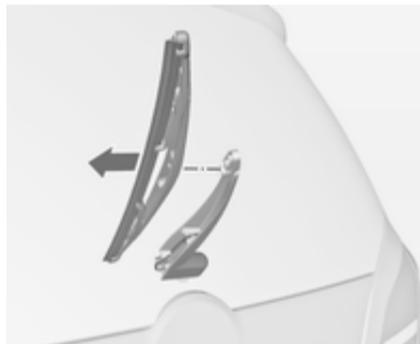
Dvignite brisalec. Iztaknite metlico brisalca, kot je prikazano na zgornji sliki, in jo odstranite.
