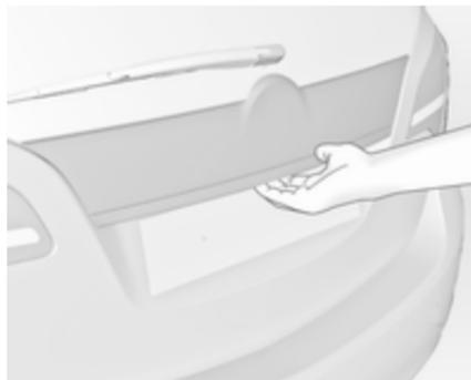
Za odpiranje vrat prtljažnika se dotaknite stikala pod prijemkom na vratih po odklepanju.
