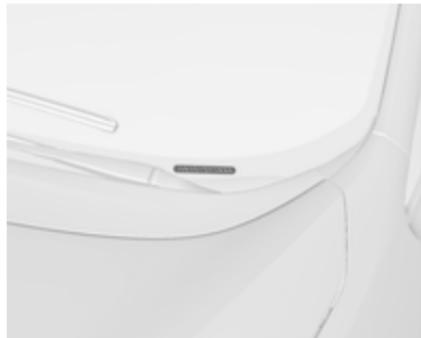
Pri drugačnih konstrukcijskih izvedbah najdete številko šasije tudi na armatuni plošči pod vetrobranskim steklom.
