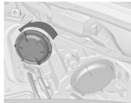
1. Pokrov 2 žarometa obrnite v obratno smer urinega kazalca in ga odstranite.
