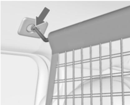
Na stropnem okviru sta dve namestitveni (vpenjalni) odprtini. Zataknite najprej en del prečke mreže na eni strani, potisnite naprej in pritrdite. Razvlecite prečko, zataknite na drugi strani, potisnite naprej in pritrdite.
