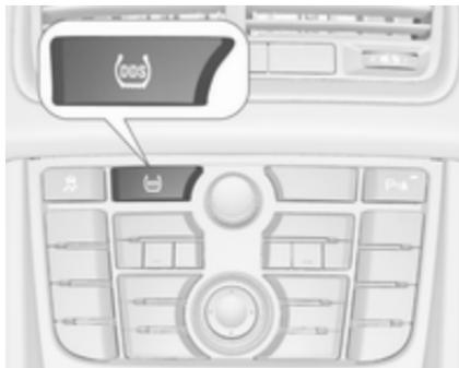
Po popravku tlaka v pnevmatikah ali po zamenjavi kolesa/pnevmatike morate sistem ponastaviti: pri vključenem kontaktu držite tipko **DDS** pritisnjeno približno 4 sekunde.
