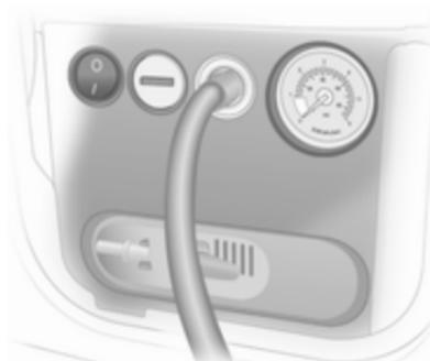
8. Vklopite kompresor s pritiskom na stikalo za vklop/izklop. Pnevmatika se napolni s tesnilnim sredstvom.
