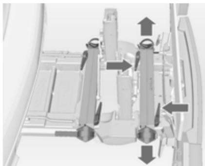
Pritisnite sprostilni vzvod in izvlecite pritrdilna vodila za zračnice.
