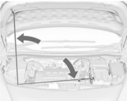
Zataknite podporno prečko.
