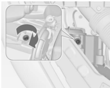
Nastavitevne vijke obrnite v smeri urinega kazalca z izvijačem za pol obrata.
