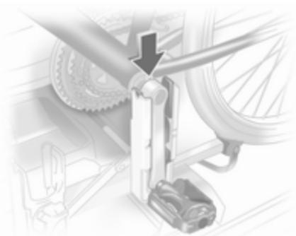
Postavite kolo na nosilec. Ojnicno pedalo vstavite v odprtino v držalu za pedalo, kot je prikazano na zgornji sliki.
