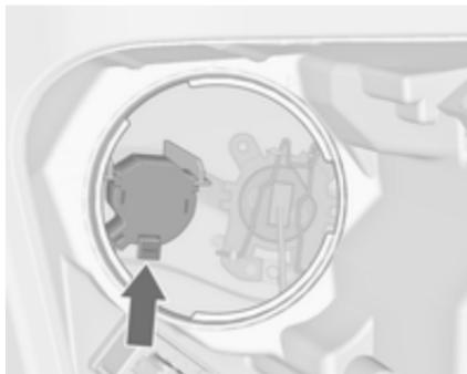
2. Pritisnite zaponko in izvlecite nosilec z žarnico iz žarometa.
