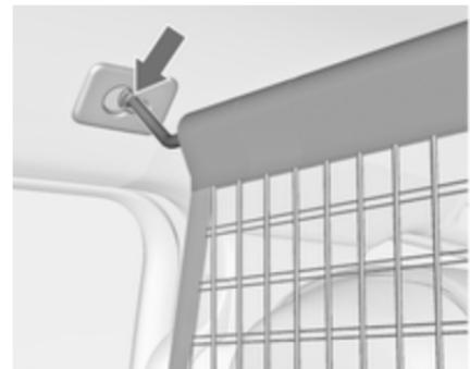
Na stropnem okviru sta dve namestitveni (vpenjalni) odprtini. Zataknite najprej en del prečke mreže na eni strani, potisnite naprej in pritrdite. Razvlecite prečko, zataknite na drugi strani, potisnite naprej in pritrdite.
