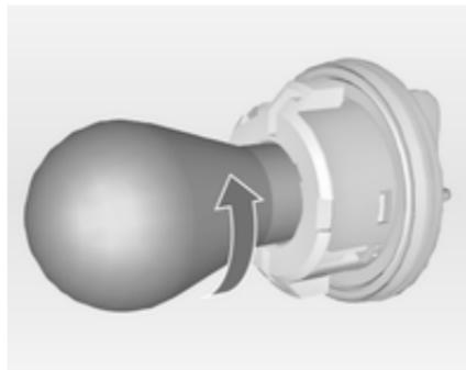
2. Žarnico obrnite v obratno smer urinega kazalca in izvlecite iz nosilca.
