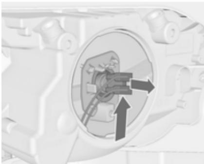
2. Potisnite nosilec žarnice navzgor in ga izvlecite iz žarometa.
