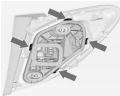
5. Odpnite štiri nosilne zaponke in odstranite nosilec žarnic.
