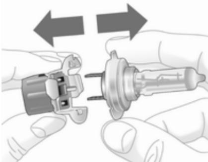
3. Žarnico iztaknите iz nosilca in vstavite novo.
