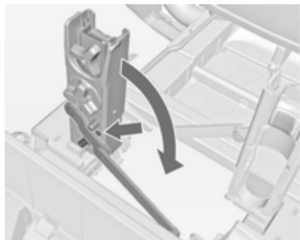
Sprostite zaklopec na diagonalni podporni prečki držala za pedalo in obe držali preklopite navzdol.
