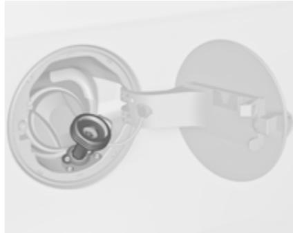
**Adapter ACME:** Privijte matico polnilne pištole na adapter. Pritisnite navzdol varovalno ročico na točilni pištoli.
