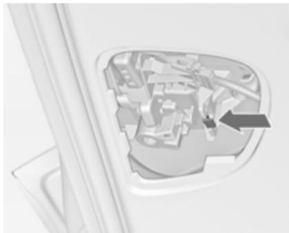
2. Odpnite nosilno zaponko in odstranite nosilec žarnic navzdol.
