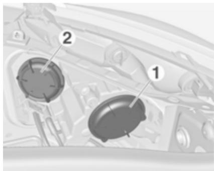
Sprednji žarometi z ločenimi kratkimi lučmi 1 (zunanja žarnica) in dodatnimi dolgimi lučmi 2 (notranja žarnica). Dodatna žarnica za osvetlitev križišč se nahaja pod pokrovom žarnice dodatnih dolgih luči.
