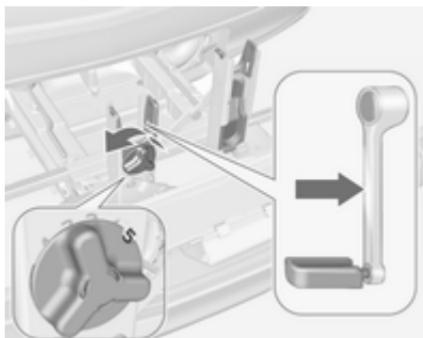
Z vrtljivo ročico na držalu pedala prilagodite nosilni vložek tipu (izstopanju) ojnice pedala primerno. V primeru koles z ravnnimi gonilkami obrnite vložek za pedal navzven (položaj 5).
