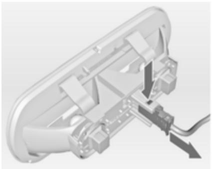
2. Pritisnite nosilno zaponko in izvlecite kabelski priključek.
