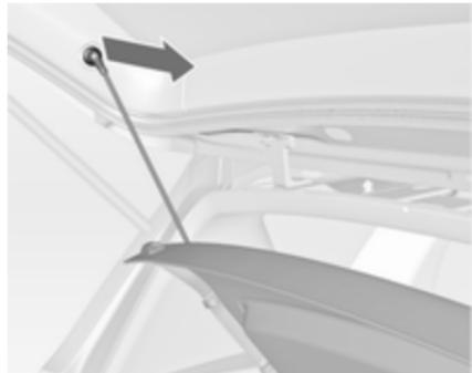
Iztaknite nosilni vrviči z vrat prtljažnika.
