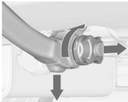
Odprite zaščitni pokrov, obrnite ključ v smeri urnega kazalca za odklepanje vlečne kljuke.
