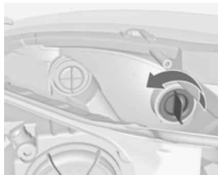
1. Nosilec žarnice odvijte v nasprotno smer urinega kazalca in ga odstranite.
