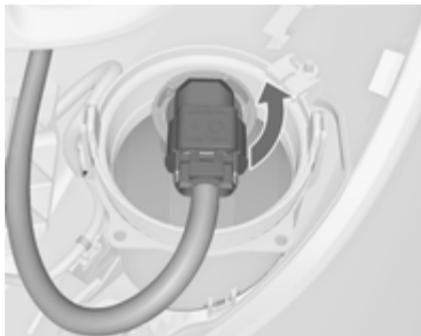
1. Nosilec žarnice odvijte v nasprotno smer urinega kazalca in ga odstranite iz žarometa.
