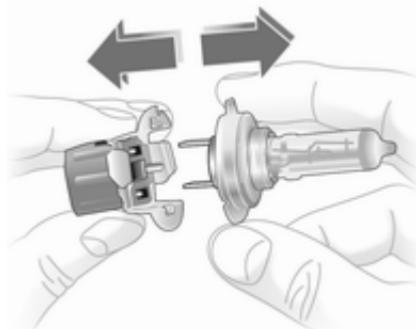
3. Žarnico iztaknite iz nosilca in vstavite novo.
