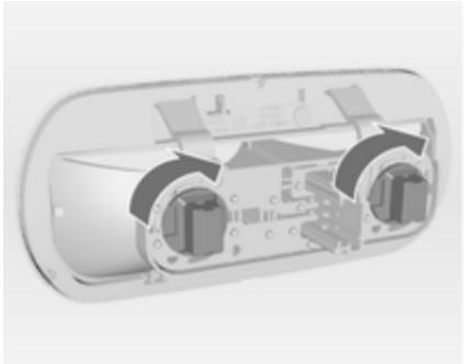
3. Obrnite nosilec žarnice v desno in izvlecite.
