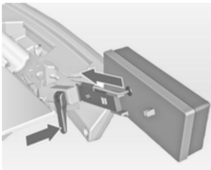
Pritisnite vpenjalno ročico navzdol in potisnite podporo luči v držalo, dokler se ne zaskoči.
