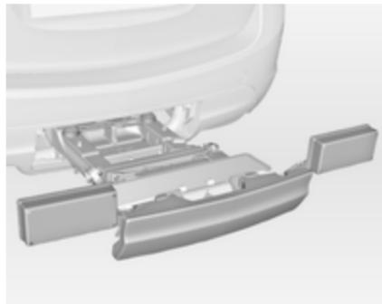
Preverite položaj ozičenja in luči, ali so pravilno nameščene in zavarovane.
