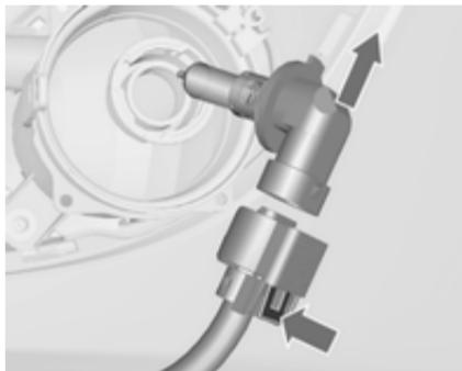
2. Nosilec z žarnico razvlecite s kabelskega priključka s pritiskom pritrdilne zaponke.
