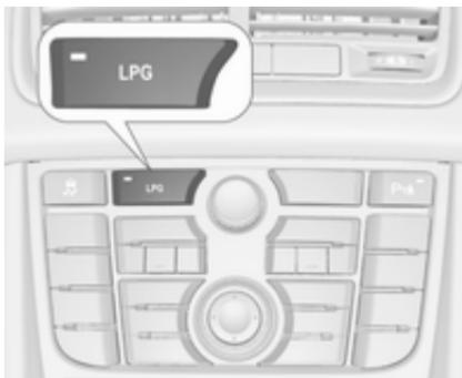
Po pritisku na tipko **LPG** se preklop med bencinskim in plinskim pogonom izvrši, takoj ko so izpolnjeni zahtevani pogoji (temperatura hladilne tekočine, temperatura plina in minimalno število vrtljajev motorja). Ti pogoji so običajno izpolnjeni po približno 60 sekundah (odvisno od zunanjega temperature) in prvem odločnejšem pritisku na pedal za plin. Stanje LED lučk opozarja na trenutni način delovanja.
