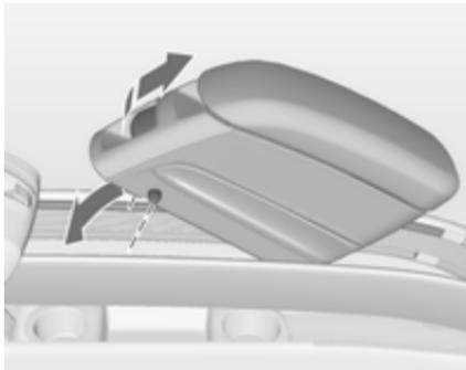
Spustite sprednji del naslona. Potegnite vzvod na sprednji strani in vstavite sprednja vodilna zatiča v zgornji vodili. Sprostite ročico. Pomaknite naslon, da se slišno zaskoči.
