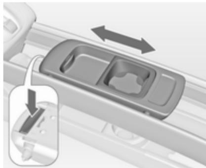
Rahlo pritisnite sprednji gumb in pomaknite držalo v želeni položaj. Sprostite gumb in pomaknite držalo za pijačo, da se slišno zaskoči.
