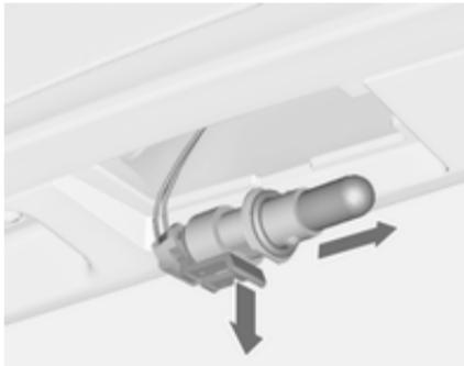
3. Iztaknите pritrdilno zaponko in razvlecite nosilec žarnice s kabelskega priključka.
