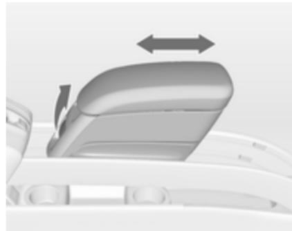
Rahlo potegnite sprednji vzvod in pomaknite naslon v želeni položaj. Sprostite ročico. Pomaknite naslon, da se slišno zaskoči.
