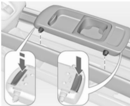
Pritisnite gumb na sprednjem in zadnjem delu ter vstavite vodilna zatiča v spodnji vodili. Sprednji gumb je potrebno pritisniti močneje. Sprostite gumb in pomaknite držalo za pijačo, da se slišno zaskoči.
