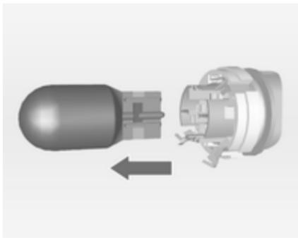
2. Žarnico iztaknите iz nosilca in vstavite novo.
