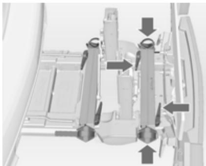
Pritisnite sprostitveni vzvod in potisnite pritrdilna vodila za zračnice do blokade.
