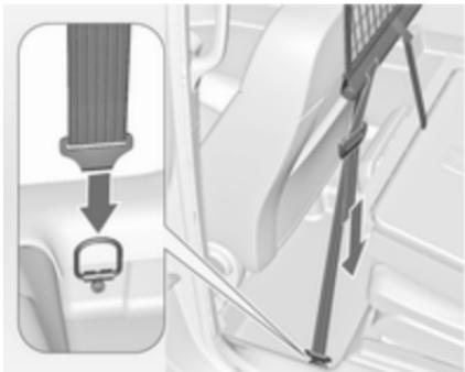
Zataknite kavla napenjalnih jermen v pritrdilni ušesci na tleh pod sprednjimi sedeži. Napnite mrežo s potegom ohlapnega dela jermenja.
