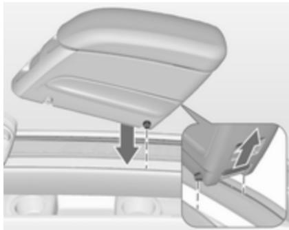
Pritisnite gumb na zadnji strani in vstavite zadnja vodilna zatiča v zgornji vodili. Sprostite gumb.
