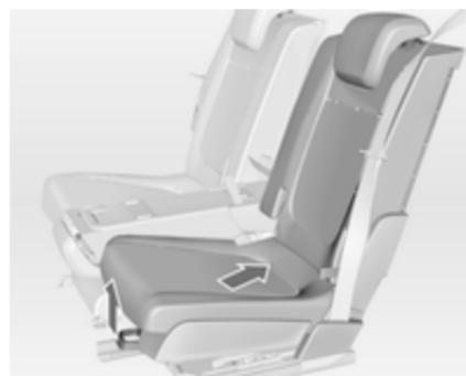
Potegnite ročico in potisnite sedež prečno nazaj v položaj 1. Sedež se samodejno zapelje navznoter. Sprostite ročico in pustite, da se sedež zaskoči v zavarovan položaj.
