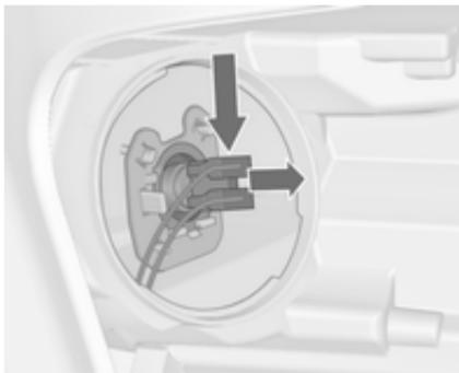
2. Potisnite nosilec žarnice navzdol in ga izvlecite iz žarometa.
