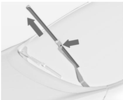
Privzdignite brisalec, pritisnite gumb za iztkanje in odstranite metlico brisalca.
