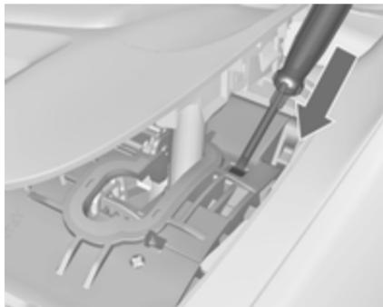
5. V odprtino vstavite izvijač do konca in premaknite izbirno ročico iz P ali N. Če pretaknete znova iz P ali N, se ročica ponovno blokira. Vzrok prekinite napajanja dajte nemudoma odpraviti strokovnjakom v servisni delavnici.
