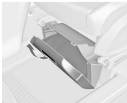
Odvisno od izvedenke se pod voznikovim sedežem lahko nahaja škatla. Potegnite ročico in preklopite pokrov navzdol. Maksimalna nosilnost: 1,5 kg.
