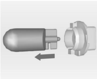
4. Žarnico iztaknite iz nosilca in vstavite novo.
