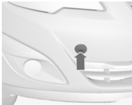
Iztaknite spodnji del pokrova in ga odstranite navzdol.
