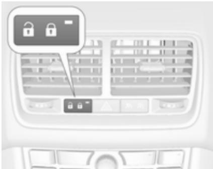
Pritisnite stikalo za centralno zaklepanje: vsa vrata se simultano zaklenejo ali odklenejo. Če so vrata zaklenjena, sveti LED indikator v stikalu.
