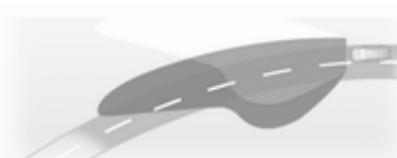
Zglobi žarometov se obračajo v odvisnosti od zavoja volana in hitrosti vozila za boljšo osvetlitev zavojev.
