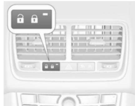
Pritisnite stikalo za centralno zaklepanje: vsa vrata se simultano zaklenejo ali odklenejo. Če so vrata zaklenjena, sveti LED indikator v stikalnu.
