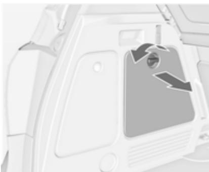
Obrnite zaklep v levo in preklopite pokrov navzdol.
