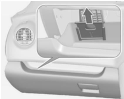
Pri vozilih z volanom na desni strani se škatla z varovalkami nahaja za pokrovom v sovoznikovem predalu. Odprite sovoznikov predal, potegnite pokrov navzgor in ga odstranite.
