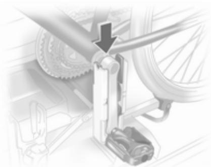
Postavite kolo na nosilec. Ojnico pedala vstavite v odprtino v držalu za pedalo, kot je prikazano na zgornji sliki.
