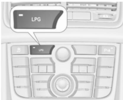
Po pritisku na tipko **LPG** se preklop med bencinskim in plinskim pogonom izvrši, takoj ko so izpolnjeni zahtevani pogoji (temperatura hladilne tekočine, temperatura plina in minimalno število vrtljavjev motorja). Ti pogoji so običajno izpolnjeni po približno 60 sekundah (odvisno od zunanjega temperature) in prvem odločnejšem pritisku na pedal za plin. Stanje LED lučk opozarja na trenutni način delovanja.
