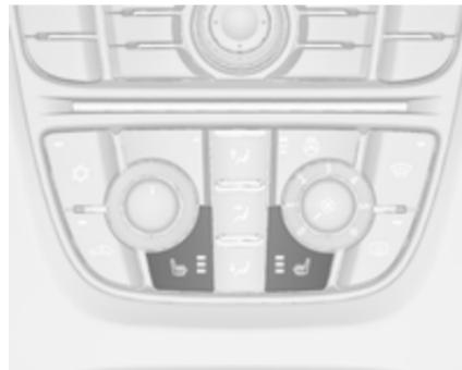
Nastavite želeno stopnjo ogrevanja s pritiskom ustreznega stikala ☰ enkrat ali večkrat. Indikator v stikaluh označuje nastavitev.
