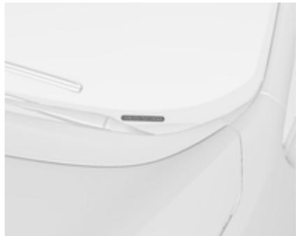
Pri drugačnih konstrukcijskih izvedbah najdete številko šasije tudi na armatuni plošči pod vetrobranskim steklom.
