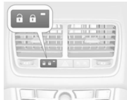
LED dioda za signaliziranje stanja je integrirana v stikalu za centralno zaklepanje.
