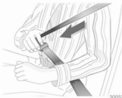
Enakomerno potegnite pas iz navijalca, ga nezvitrega namestite čez telo in vstavite zaponko v zaklep, da se slišno zaskoči. Med vožnjo si pas na diagonalnem delu večkrat zategnjite.
