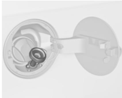
**Adapter ACME:** Privijte matico polnilne pištole na adapter. Pritisnite navzdol varovalno ročico na točilni pištoli.
