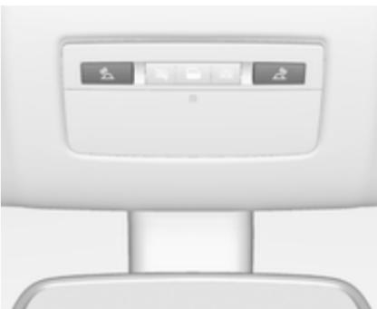
Vklapljanje s stikali in v sprednjih in zadnjih stropnih lučeh.
