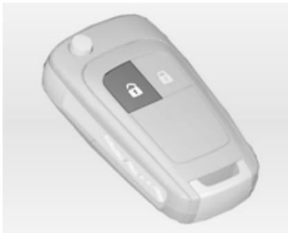
Pri izključenem kontaktu pritisnite tipko
