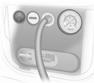
8. Vklopite kompresor s pritiskom na stikalo za vklop/izklop. Pnevmatika se napolni s tesnilnim sredstvom.
