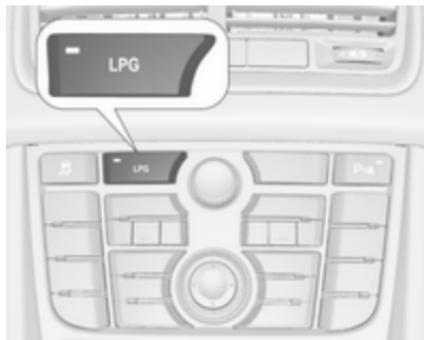
S pritiskom gumba **LPG** preklapljate med pogonom na bencin in pogonom na utekočinjen naftni plin. Stanje LED-lučk ─ opozarja na trenutni način delovanja.
