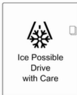
Če se zunanjna temperatura zniža na 3 °C, se na voznikovem informacijskem zaslonu višje-stopenjske konfiguracije prikaže opozorilo.
