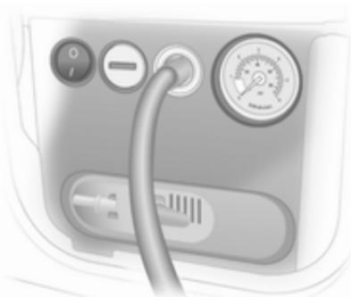
8. Vklopite kompresor s pritiskom na stikalo za vklop/izklop. Pnevmatika se napolni s tesnilnim sredstvom.
