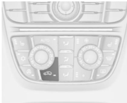
Za vklop kroženja zraka pritisnite gumb ☁. Vklop signalizira LED indikator v stikalnu.
