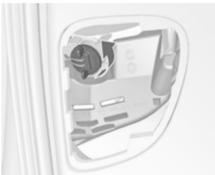
2. Nosilec žarnice obrnite v obratno smer urinega kazalca. Odstranite nosilec žarnice.
