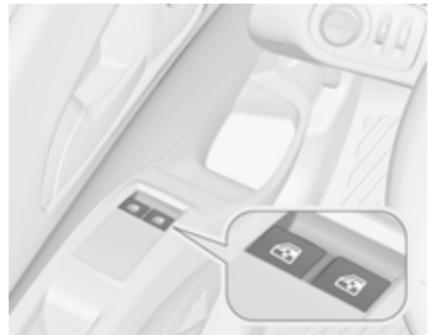
Za odpiranje želenega okna pritisnite ustrezen stikalo in za zapiranje okna stikalo potegnite.
