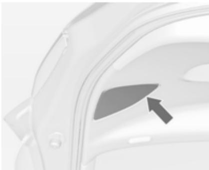
1. Odprite vrata prtljažnika in odstranite pokrov z izvijačem.
