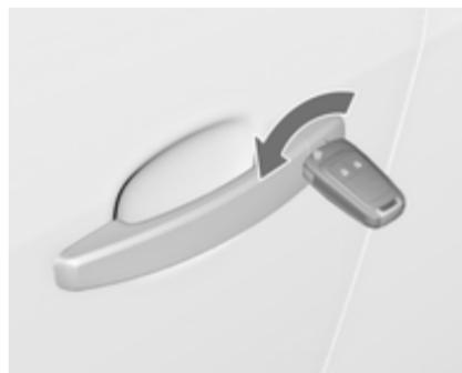
Odklenite voznikova vrata z obratom ključa v ključavnici. Vključite kontakt in pritisnite stikalo za odklepanje vseh vrat, prtljažnika in lopute rezervoarja goriva.
