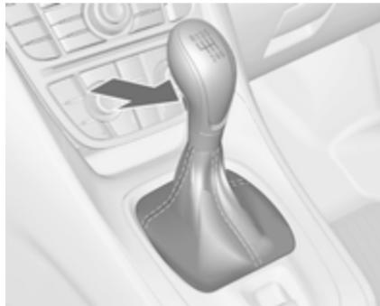
Vzvratna prestava: ko vozilo miruje, pritisnite pedal sklopke, tako počakajte 3 sekunde, pritisnite gumb na prestavni ročici in prestavite.
