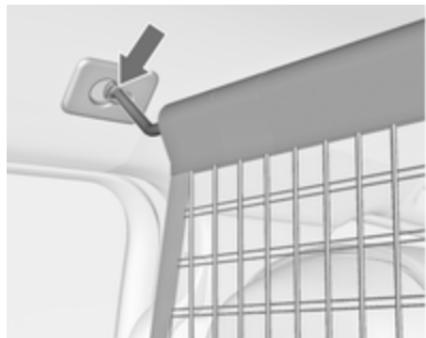
Na stropnem okviru sta dve namestitveni (vpenjalni) odprtini. Zataknite najprej en del prečke mreže na eni strani, potisnite naprej in pritrdite. Razylecete prečko, zataknite na drugi strani, potisnite naprej in pritrdite.
