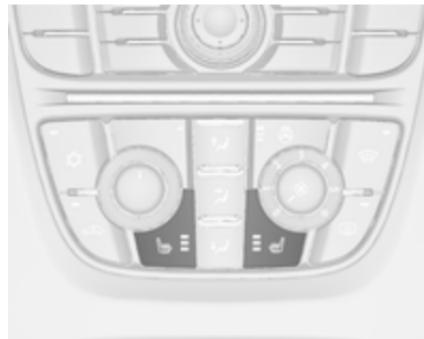
Nastavite želeno stopnjo ogrevanja s pritiskom ustreznega stikala enkrat ali večkrat. Indikator v stikalu označuje nastavitev.
