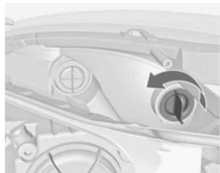
1. Nosilec žarnice odvijte v nasprotno smer urinega kazalca in ga odstranite.
