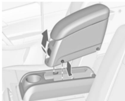
Pritisnite gumb na sprednji strani in vstavite sprednja vodilna zatiča v zgornji vodili. Pomaknite naslon, da se slišno zaskoči. Sprostite gumb.
