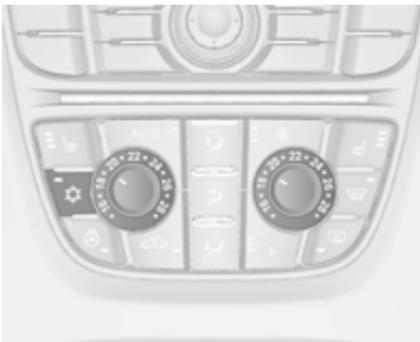
Za vklop hlajenja pritisnite tipko ☀. Vklop signalizira LED indikator v stikalnu. Hlajenje deluje samo, kadar teče motor in je vključen ventilator sistema za ogrevanje, prezračevanje, hlajenje.
