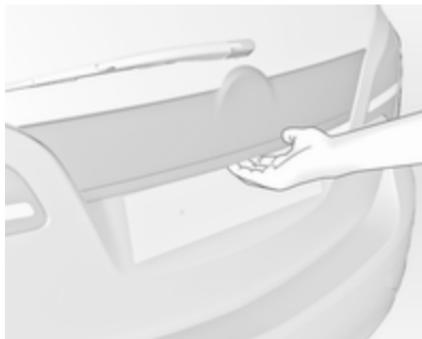
Za odpiranje vrat prtljažnika se dotaknite stikala pod vdolbino na vratih prtljažnika po odklepanju.
