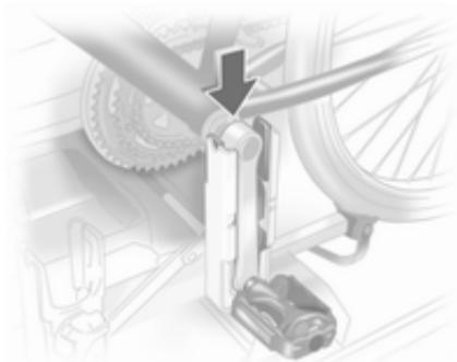
Postavite kolo na nosilec. Ojnicu pedala vstavite v odprtino v držalo za pedal, kot je prikazano na zgornji sliki.
