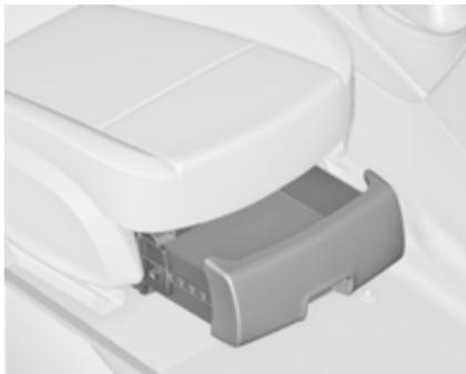
S prijemom izdolbljenega robu privzdignite predal in ga povlecite naprej. Maksimalna nosilnost: 3 kg. Zapiranje predala: potisnite ga pod sedež, da se zatakne.
