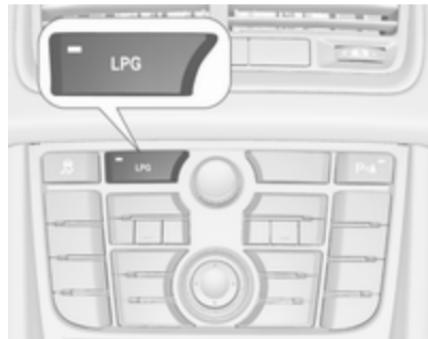
S pritiskom **LPG** preklapljate med pogonom na bencin in pogonom na utekočinjen naftni plin. Stanje LED-lučk **—** opozarja na trenutni način delovanja.
