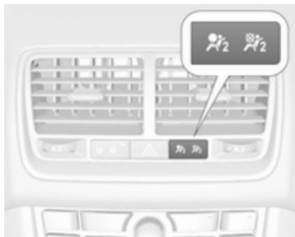
Če kontrolna lučka po vključitvi kontakta vžiga sveti pribl. 60 sekund, je sistem varnostnih blazin na sovoznikovi strani aktivен in se bo v primeru trka sprožil.
