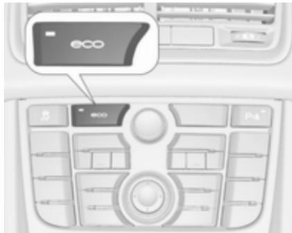
Start-stop sistem lahko ročno izklopite s pritiskom **eco**. Po izključitvi ugasne LED indikator v stiku.
