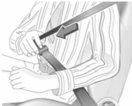
Enakomerno potegnite pas iz navijalca, ga nezvitega namestite čez telo in vstavite zaponko v zaklep, da se slišno zaskoči. Med vožnjo si pas na diagonalnem delu večkrat zategnjite.
