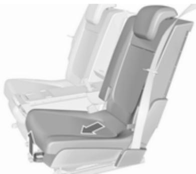
Potegnite ročico in potisnite sedež prečno naprej v položaj 2. Sedež se samodejno zapelje navzven. Sprostite ročico in pustite, da se sedež zaskoči v zavarovan položaj.
