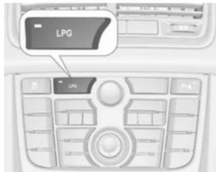
Po pritisku LPG se preklop med bencinskim in plinskim pogonom izvrši, takoj ko so izpolnjeni zahtevani pogoji (temperatura hladilne tekočine, temperatura plina in minimalno število vrtljajev motorja). Ti pogoji so običajno izpolnjeni po približno 60 sekundah (odvisno od zunanje temperature) in prvem odločnejšem pritisku na pedal za plin. Stanje LED lučk opozarja na trenutni način delovanja.
