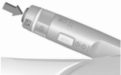
Za ponastavitev števca dnevno dnevno prevoženih kilometrov pritisnite tipko **SET/CLR** na stikalu smernikov za nekaj sekund ali, pri vozilih z gumbom za ponastavitev, pritisnite gumb zraven meritnika hitrosti, ločeno za izbrano stran 1 ali 2.
