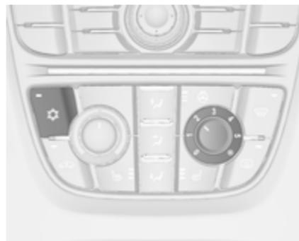
Za vklop hlajenja pritisnite
