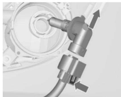
2. Nosilec z žarnico razvlecite s kabelskega priključka s pritiskom pritrilne zaponke.
