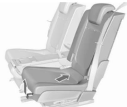
Potegnite ročico in potisnite sedež prečno nazaj v položaj 1. Sedež se samodejno zapelje navznoter. Sprostite ročico in pustite, da se sedež zaskoči v zavarovan položaj.
