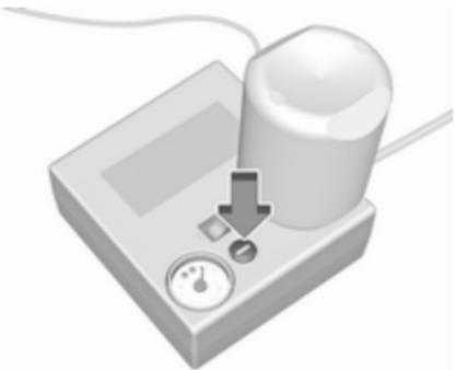
Če predpisani tlak ni dosežen v roku 10-ih minut, odstranite komplet za popravilo pnevmatik. Premaknite vozilo za en obrat kolesa. Ponovno priklopite komplet za popravilo pnevmatik in nadaljujte s postopkom polnjenja pnevmatike še dodatnih 10 minut.
