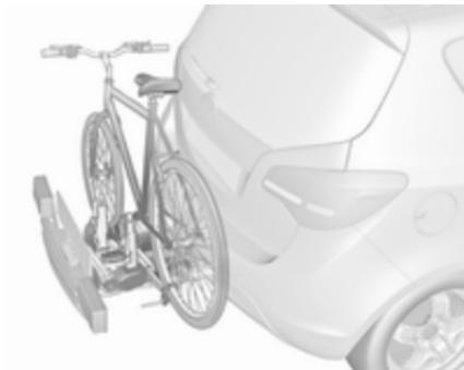
Zadnji nosilec (Flex-Fix sistem) omogoča nameščanje dveh koles na raztegljiv nosilec, ki je integriran v dnu vozila. Prevoz drugih stvari ni priporočljiv.
