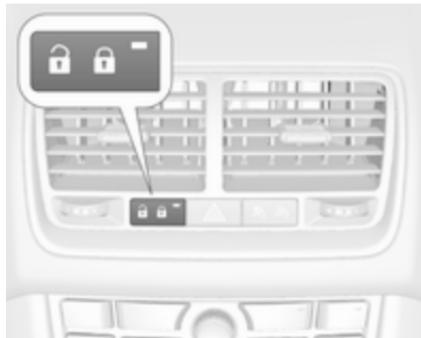
Pritisnite stikalo za centralno zaklepanje: vsa vrata se simultano zaklenejo ali odklenejo. Če so vrata zaklenjena, sveti LED indikator v stiku.
