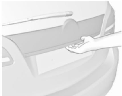
Za odpiranje vrat prtljažnika se dotaknite stikala pod vdolbino na vratih prtljažnika po odklepanju.
