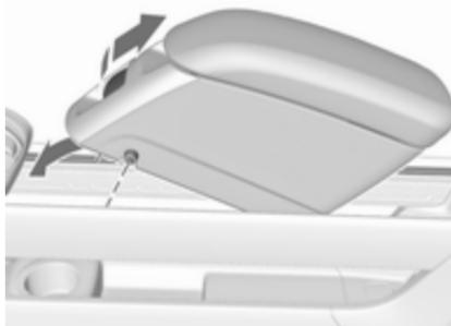
Spustite sprednji del naslona. Potegnite vzvod na sprednji strani in vstavite sprednja vodilna zatiča v zgornji vodili. Sprostite ročico. Pomaknite naslon, da se slišno zaskoči.
