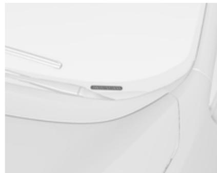
Identifikacijska številka vozila je lahko vtisnjena na instrumentni plošči; vidna je skozi vetrobransko steklo ali v motornem prostoru, na desni steni karoserije.
