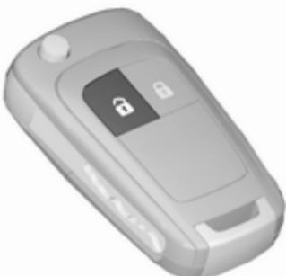
Za odklepanje vrat ter prtljažnika pritisnite . Odprite vrata s potegom kljuke na vratih. Za odpiranje vrat prtljažnika se dotaknite stikala pod prijemkom na vratih.
