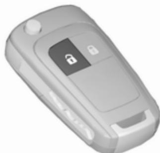
Pri izključenem kontaktu pritisnite za odklepanje vseh vrat. Vrata prtljažnika se odklenejo in jih lahko odprete z dotikom tipke pod prijemkom na vratih.
