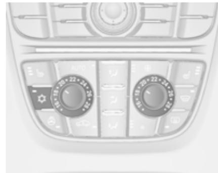
Za vklop hlajenja pritisnite ☀. Vklop signalizira LED indikator v stikalnu. Hlajenje deluje samo, kadar teče motor in je vključen ventilator sistema za ogrevanje, prezračevanje, hlajenje.
