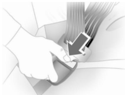
Pas odpnete s pritiskom na rdeč gumb na zaklepnu.
