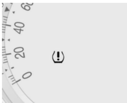
Če je zaznano stanje nizkega tlaka v pnevmatikah, zasveti . Vozilo čim prej ustavite in napolnite pnevmatike s priporočenim tlakom  $\diamond$  171.
