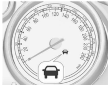
V merilniku hitrosti se prižge zeleni simbol za spredaj vočevo vozilo , če je sistem zaznal vozilo v smeri vožnje pred vami. Prvi pogoj za to je, da je v meniju za osebne nastavitev vozila vključeno opozorilo za trk spredaj 95 ali da funkcija ni bila izključena s tipko (odvisno od sistema, glejte informacije v nadaljevanju).
