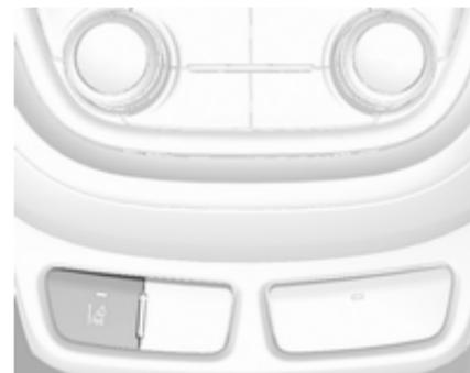
Sistem za opozorilo o nenamerni menjavi vozneg pasu se aktivira s pritiskom gumba . LED v stikalju označuje, da je sistem vključen. Kadar kontrolna lučka na instrumentni tabli sveti zeleno, je sistem pripravljen na delovanje.
