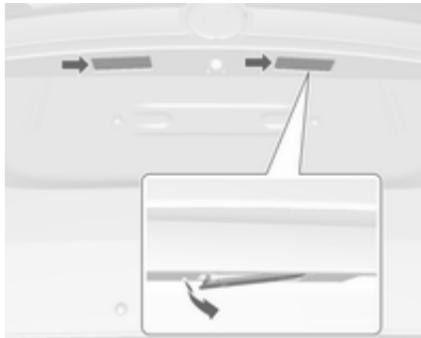
1. Luč iztaknite z izvijačem.
