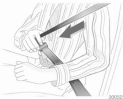
Enakomerno potegnite pas iz navjalca, ga nezvitega namestite čez telo in vstavite zaponko v zaklep, da se slišno zaskoči.
