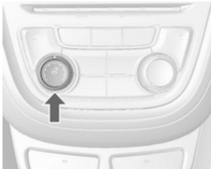
Vklopite s pritiskom tipke . Vklop signalizira LED indikator v stiku
