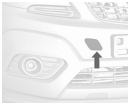
Sprostite pokrovček z izvijačem in ga odstranite.
