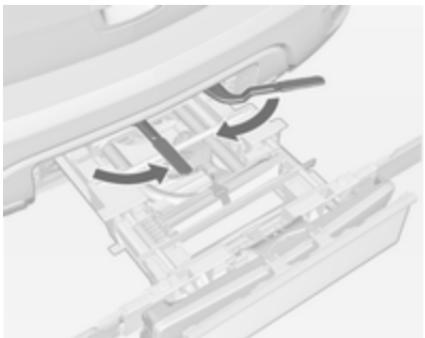
Obrnite obe vpenjalni ročici navznoter, kolikor je mogoče. Pritrdite trak.
