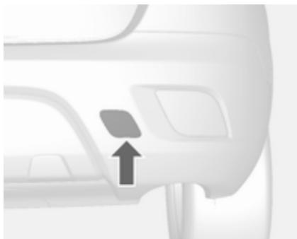
Sprostite pokrov z izvijačem in ga odstranite.
