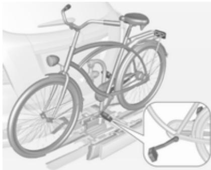
1. Obrnите pedala v položaj, ki je prikazan na sliki, in postavite kolo v podporo za kolo.
