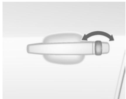
Odklenite voznikova vrata z obratom ključa v ključavnici. Vključite kontakt in pritisnite stikalo
