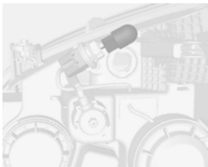
2. Žarnico rahlo pritisnite v nosilec, jo obrnite na levo in izvlecite ter vstavite novo žarnico.
