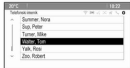
Če je na seznamu na voljo več elementov menija, kot jih lahko prikaže zaslon, se prikaže drsni trak. Večfunkcijski gumb obrnite v desno, da se premaknete navzdol, in levo, da se premaknete navzgor.
