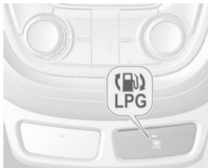
Po pritisku na tipko **LPG** se preklop med bencinskim in plinskim pogonom izvrši, takoj ko so izpolnjeni zahtevani pogoji (temperatura hladilne tekočine, temperatura plina in minimalno število vrtljavjev motorja). Ti pogoji so običajno izpolnjeni po približno 60 sekundah (odvisno od zunanje temperature) in prvem odločnejšem pritisku na pedal za plin. Stanje LED lučk opozarja na trenutni način delovanja.
