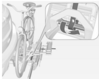
4. Napeljite trak, ki je pritrjen na adapterju, pod ročico, kadar preklapljate nosilec na zadku vozila. Pritrdite trak.
