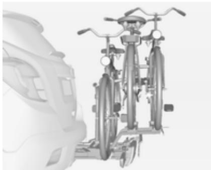
Zadnji nosilec (Flex-Fix sistem) omogoča nameščanje enega kolesa na raztegljiv nosilec, ki je integriran v dnu vozila. Adapter omogoča pritrdiritev dveh dodatnih koles. Prevoz drugih stvari ni priporočljiv.
