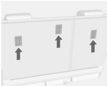
Za varovala za otroke, ki niso ISOFIX, vpnite pas Top-tether v vpenjalne točke Top-tether. Pas mora potekati pod vzglavnikom med njegovima prečkama.
