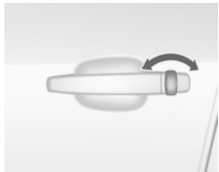
Odklenite voznikova vrata z obratom ključa v ključavnici. Vključite kontakt in pritisnite stikalo
