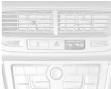
Če kontrolna lučka ne sveti, se sovoznička varnostna blazina sproži v primeru trka.
