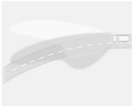
Zglobi žarometov se obračajo v odvisnosti od zavoja volana in hitrosti vozila za boljšo osvetlitev zavojev.
