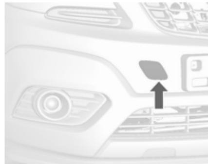
Sprostite pokrovček z izvijačem in ga odstranite.
