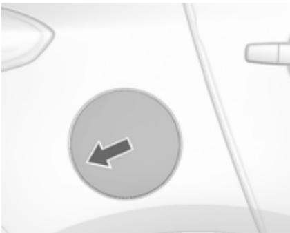
Pokrov rezervoarja goriva odpirajte le, ko vozilo miruje. Potisnite pokrov in ga odprite.
