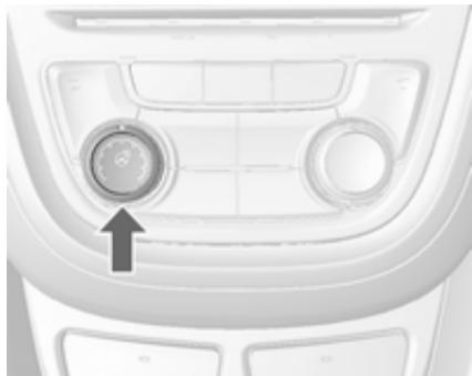
Vklopite s pritiskom tipke . Vklop signalizira LED indikator v stikuju. Ogrevanje deluje le med delovanjem motorja.
