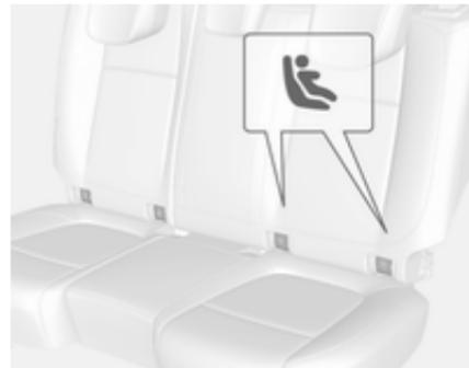
Vozilo je lahko opremljeno z vodili pred pritrdilnimi oporami, ki omogočajo lažjo namestitve otroškega varnostnega sedeža.
