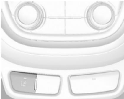
Sistem za opozorilo o nenamerni menjavi voznega pasu se aktivira s pritiskom gumba . LED v stikalju označuje, da je sistem vključen. Kadar kontrolna lučka na instrumentni tabli sveti zeleno, je sistem pripravljen na delovanje. Sistem deluje le pri hitrosti nad 56 km/h in če so na cestišču oznake voznega pasu.
