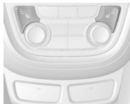
Nastavite želeno stopnjo ogrevanja s pritiskom ustreznega stikala enkrat ali večkrat. Indikator v stikalu označuje nastavitev.
