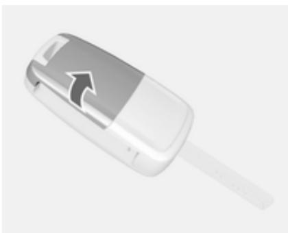
Pritisnite gumb, da izskoči ključeva brada in odprite ključ. Zamenjajte baterijo (tip baterije CR 2032). Pazite na pravilno vstavitev nove baterije. Zaprite daljinski upravljalnik in ga sinhronizirajte.
