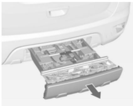
Potegnite zadnji nosilec do konca navzven, da se zaskoči.
