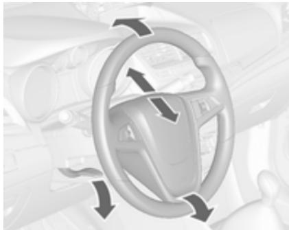
Sprostite ročico, nastavite volan, zataknite ročico v zavarovan položaj.
