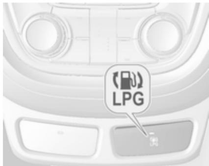
S pritiskom na gumb **LPG** preklapljate med pogonom na bencin in pogonom na utekočinjen naftni plin. Trenutni način delovanja označuje LED dioda v tipki.
