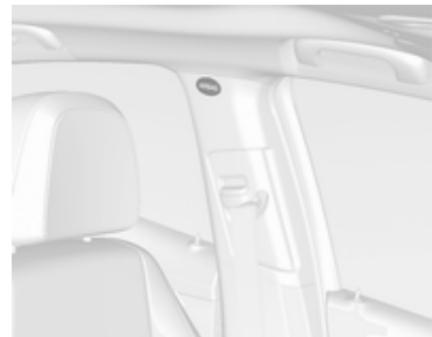
Varnostni zavesi se sprožita v primeru bočnega trka z določeno silo. Kontakt mora biti za to vključen.
