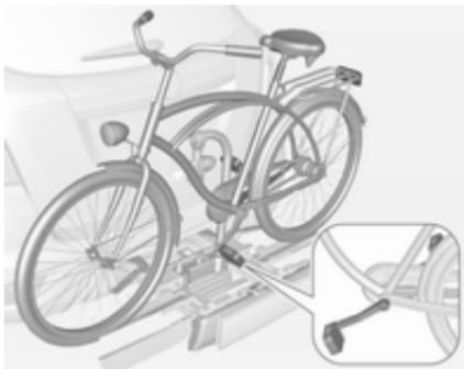
1. Obrnite pedala v položaj, ki je prikazan na sliki, in postavite kolo v podporo za kolo.
