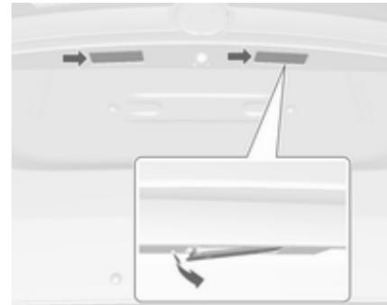
1. Luč iztaknite z izvijačem.
