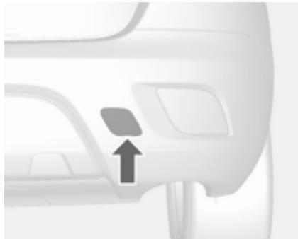
Sprostite pokrov z izvijačem in ga odstranite.
