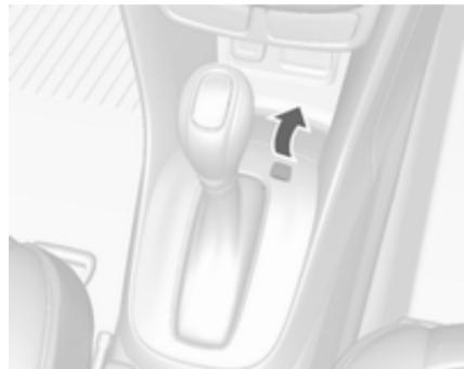
3. Odstranite pokrovček na konzoli s tankim predmetom, npr. z izvijačem.
