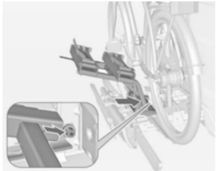
1. Namestite adapter na nosilec na zadku vozila, kot kaže slika.
