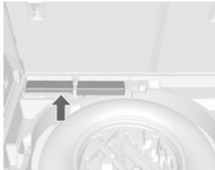
Spravite opozorilni trikotnik pod talno pokrivalo v prtljažniku. Zavarujte s trakom.
