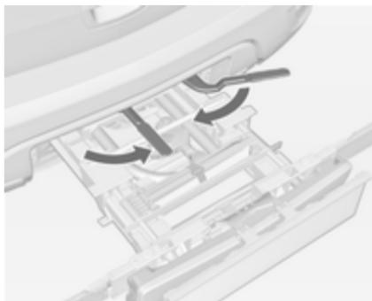
Obrnite obe vpenjalni ročici navznoter, kolikor je mogoče. Pritrdite trak.
