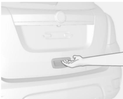
Za odpiranje vrat prtljažnika se dotaknite stikala po odklepanju.
