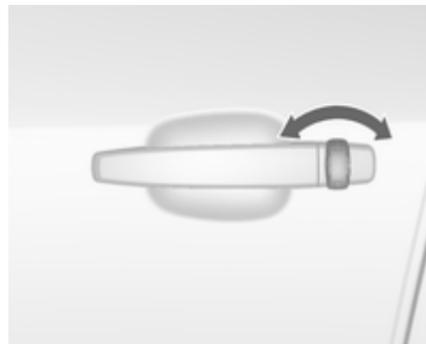
Odklenite voznikova vrata z obratom ključa v ključavnici. Vključite kontakt in pritisnite
