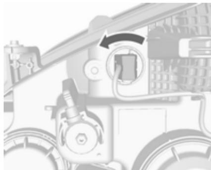
1. Nosilec žarnice zasukajte v levo in ga iztaknite.
