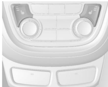
Nastavite želeno stopnjo ogrevanja s pritiskom tipke
