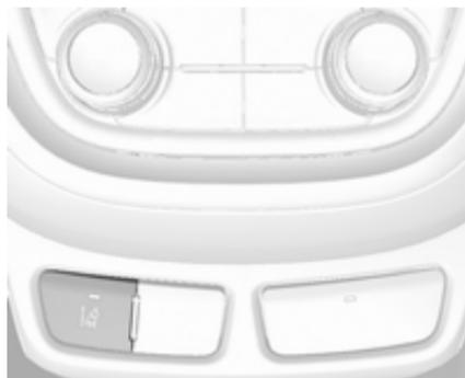
Sistem za opozorilo o nenamerni menjavi voznega pasu se aktivira s pritiskom na LED. LED v stikalu označuje, da je sistem vključen. Kadar kontrolna lučka na instrumentni tabli sveti zeleno, je sistem pripravljen na delovanje.
