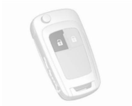
Za odklepanje vrat ter prtljažnika pritisnite
