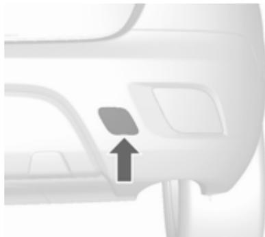
Sprostite pokrov z izvijačem in ga odstranite.
