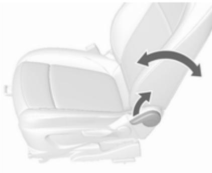
Potegnite vzvod, nastavite naklon in sprostite vzvod. Sedežno naslonjalo naj se primerno zaskoči.
