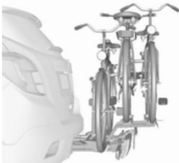
Zadnji nosilec (Flex-Fix sistem) omogoča nameščanje enega kolesa na raztegljiv nosilec, ki je integriran v dno vozila. Adapter omogoča pritrditev dveh dodatnih koles. Prevoz drugih stvari ni priporočljiv.
