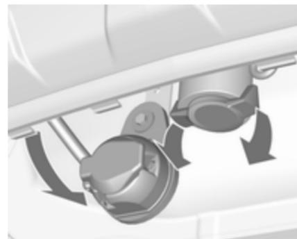
Iztaknite električni priključek za prikolico in ga preklopite navzdol. Iz odprtine za vlečno kljuko izvlecite tesnilni čep in ga pospravite v prtljažnik.
