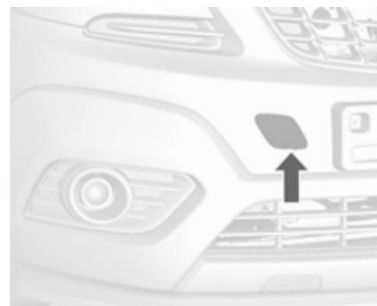
Sprostite pokrovček z izvijačem in ga odstranite.
