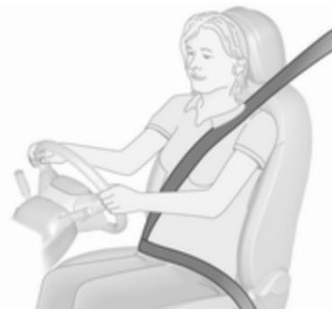
Izvalcite varnostni pas in ga zataknite v zaklep. Bočni del pasu ne sme biti zviti na nobenem delu in se mora tesno prilegati k telesu. Naslonjalo naj ne bo nagnjeno preveč nazaj (priporočen kot nagiba: največ 25°).
