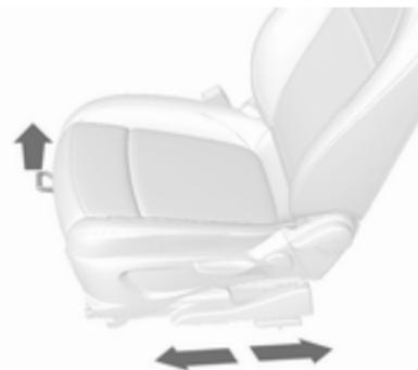
Potegnite ročico, pomaknite sedež, sprostite ročico. Poskusite premakniti sedež nazaj in naprej in se tako prepričajte, da je sedež zavarovan v izbranem položaju.
