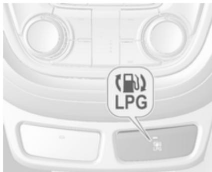
S pritiskom **LPG** preklapljate med pogonom na bencin in pogonom na utekočinjen naftni plin. Trenutni način delovanja označuje LED dioda v tipki.
