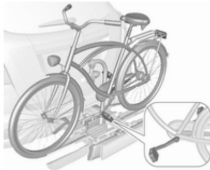
1. Obrnite pedala v položaj, ki je prikazan na sliki, in postavite kolo v podporo za kolo.
