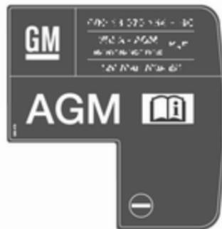
AGM akumulator lahko prepoznate po identifikacijski nalepki. Priporočamo uporabo originalnega Oplovega akumulatorja vozila.
