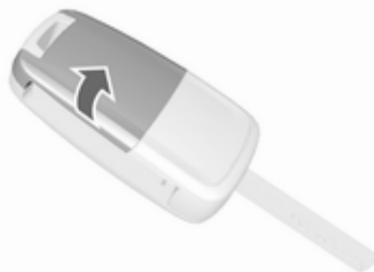
Pritisnite gumb, da izskoči ključeva brada in odprite ključ. Zamenjajte baterijo (tip baterije CR 2032). Pazite na pravilno vstavitve nove baterije. Zaprite daljinski upravljalnik in ga sinhronizirajte.
