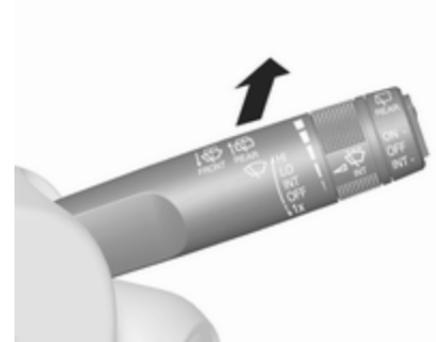
Potisnite ročično stikalo naprej. Šoba poškropi zadnje steklo, obenem brisalec nekajkrat obriše steklo.
