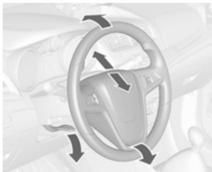
Sprostite ročico, nastavite volan, zatakните ročico v zavarovan položaj.
