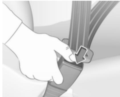
Pas odprite s pritiskom na rdeč gumb na zaklepu.
