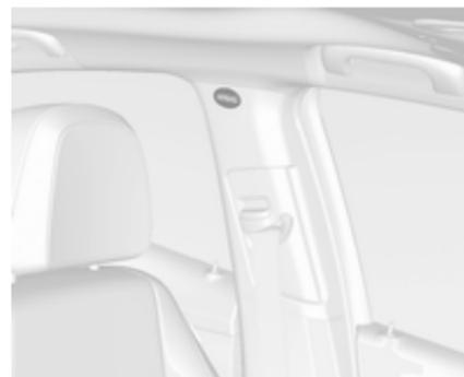
Varnostni zavesi se sprožita v primeru bočnega trka z določeno silo. Kontakt mora biti za to vključen.
