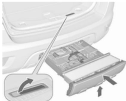
Povlecite zaklepni vzvzgor. Sistem rahlo dvignite in ga potisnite v odbijač, da se zaskoči.
