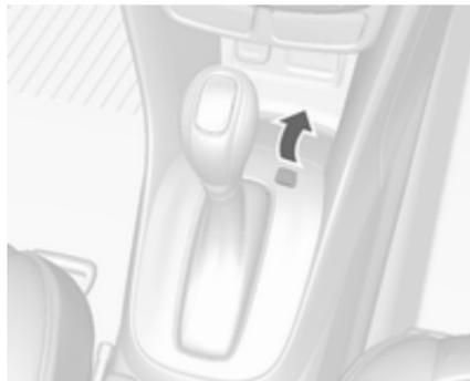
3. Odstranite pokrovček na konzoli s tankim predmetom, npr. z izvijačem.
