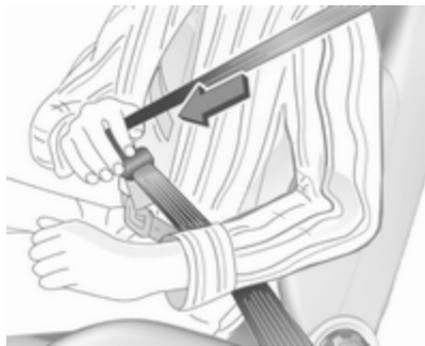
Enakomerno potegnite pas iz navijalca, ga nezvitega namestite čez telo in vstavite zaponko v zaklep, da se slišno zaskoči.
