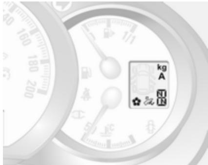
Režim ali izbrana prestava robotiziranega menjalnika je prikazan(a) na prikazovalniku menjalnika.
