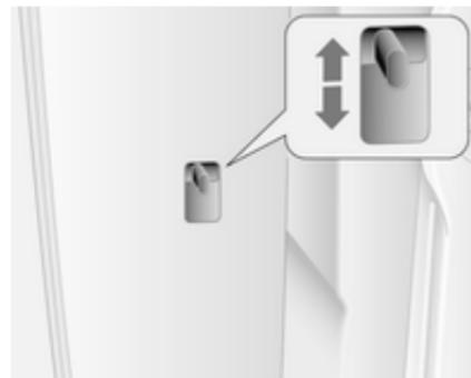
Pritisnite otroško varovalo navzdol: vrat od znotraj ni mogoče odpreti. Za odklepanje potisnite varovalo navzgor.
