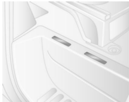
Identifikacijska številka vozila (številka šasije) je vtisnjena tudi na desnem pragu vozila pod talno oblogo (pod plastičnim pokrovom) med sovoznikovimi vrati in sedežem. Za dostop odpnite pokrov s ploščatim izvijačem.
