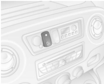
Za samodejno odpiranje pritisnite stikalo na armaturni plošči pri vklopljeni ročni zavori. Prižge se opozorilna lučka na armaturni plošči. Pritisnite stikalo še enkrat: opozorilna lučka ugasne in med zapiranjem električno pomicnih drsnih vrat se oglesi zvočni signal.
