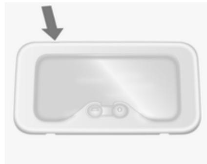
1. Luč iztaknite s ploskim izvijačem.
