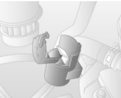
Če se akumulator Vašega vozila izprazne, uporabite kleme za zagon motorja v motornem prostoru, ki so dostopne na preprost način.
