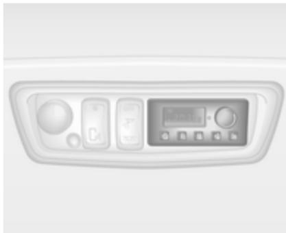
Če je motor ugasnjena, je zadnji del potniške kabine mogoče ogrevati z dodatnim ogrevanjem skozi spodnje prezračevalne odprtine. S programiranjem vrednosti na upravni plošči je mogoče nastaviti čas, datum in temperaturo.
