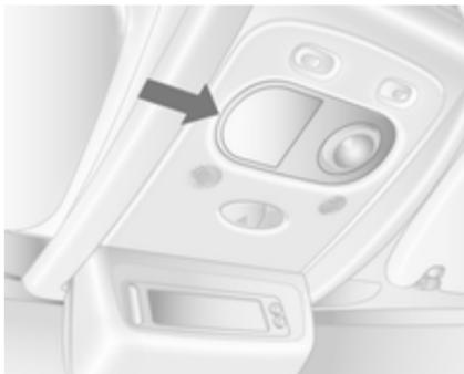
1. Zaslonko odstranite s ploskim izvijačem.
