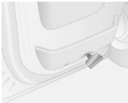
1. Luč iztaknite s ploskim izvijačem.
