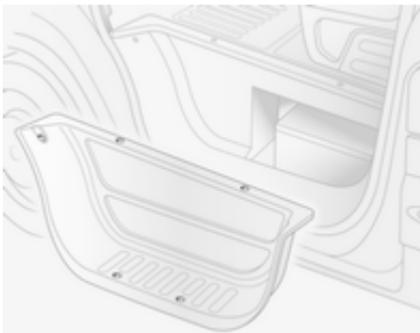
Akumulator se nahaja pod vozilom za pokrivenim panelom stopnice sprednjih levih vrat. Za dostop do akumulatorja odstranite pokriveni panel.
