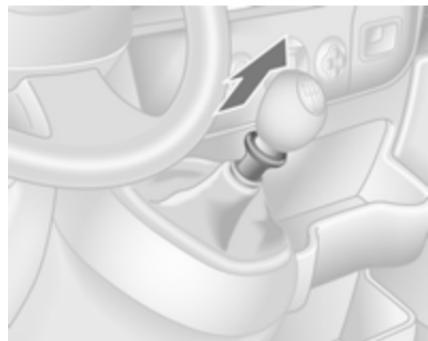
Vzvratno prestavo vklopite, ko vozilo miruje: pritisnite pedal sklopke, potegnjite navzgor vzvod na ročici in prestavite.
