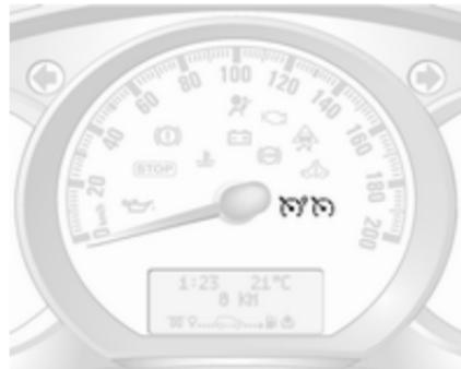
Kontrolna lučka na instrumentni plošči sveti zeleno skupaj z in na večfunkcijskem zaslonu se izpiše ustrezno sporočilo.
