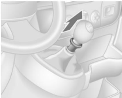
Vzvratna prestava: ko vozilo miruje, pritisnite pedal sklopke, potegnite obroč navzgor in prestavite. Če ni možno prestaviti v vzvratno prestavo, ponovno pomaknite ročico v prosti tek, sprostite in še enkrat pritisnite pedal sklopke ter nato ponovno prestavite v vzvratno prestavo.
