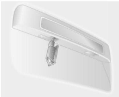
1. Zaslонko iztaknite s ploskim izvijačem.
