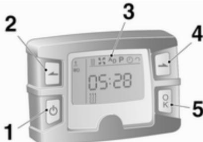
**1 Ⓛ Tipka za vklop** = Vključitev/izključitev upravljalnika in spremjanje prikazanih informacij
