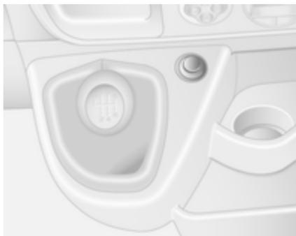
Vžigalnik pritisnite navznoter. Vžigalnik se samodejno izklopi in izskoči iz ležišča, ko je spirala razžarjena. Vžigalnik izvlecite.
