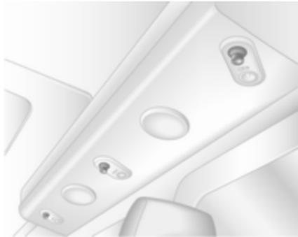
Za dodatno dovajanje klimatiziranega zraka v zadnji del potniške kabine so nameščene prezračevalne šobe nad glavo.
