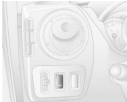
Pri vključenem kontaktu in vklopljeni vzvratni prestavi lahko sistem trajno izklopite s pridržanjem pritisnjene tipke **P/▲** na armaturni plošči 3 sekunde. V tipki sveti kontrolna lučka.
