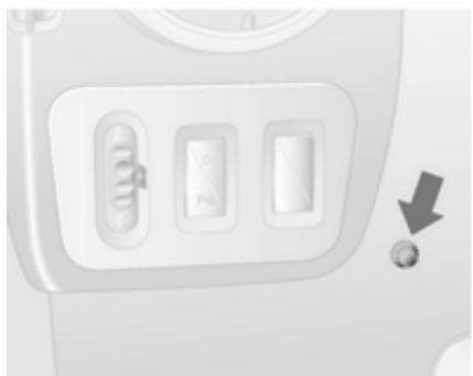
Namesto daljinskega upravljalnika lahko za vključitev in izključitev ogrevanja uporabljate tudi tipko na armaturni plošči. S pritiskom na to tipko se ogrevanje vključi za 30 minut.
