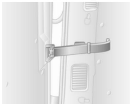
Za odpiranje vrat do 180° iztaknite omejevalnike iz zatikalnikov na vratnem okviru.
