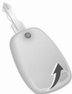
Odvijte vijak in odprite prostor za baterijo: v odprtino vstavite izvijač in ga zasukajte.
