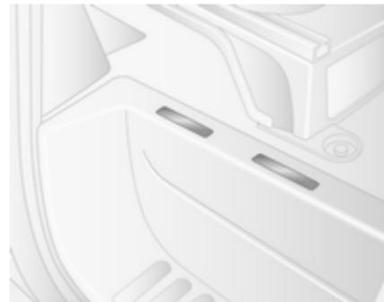
Identifikacijska številka vozila (številka šasije) je vtisnjena tudi na sprednjem desnem pragu vozila pod talno oblogo (pod plastičnim pokrovom) med sovoznikovimi vrati in sedežem. Za dostop odpnite pokrov s ploščatim izvijačem.
