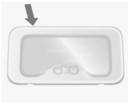
1. Luč iztaknite s ploskim izvijačem.
