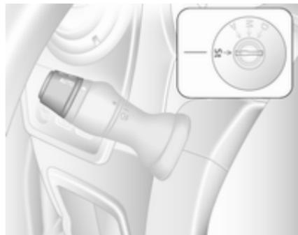
Pri vključeni funkciji samodejnega vklopa luči med obratovanjem motorja sistem preklopi med dnevnimi lučmi (če so nameščene) in žarometi v odvisnosti od svetlobnih razmer.
