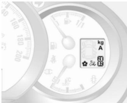
Režim ali izbrana prestava robotiziranega menjalnika je prikazan(a) na prikazovalniku menjalnika.
