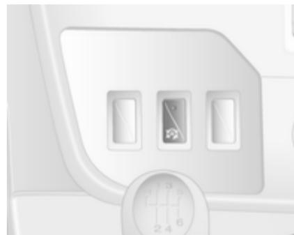
Sistem Stop-start lahko ročno izklopite s pritiskom na gumb stop-start . Ko je funkcija izključena, LED lučka v tipki zasveti.
