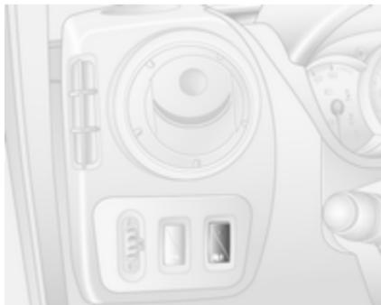
Po potrebi lahko v primeru, da so cestne površine mehke, pokrite z blatom ali snegom, izklopite sistem proti zdrusu pogonskih koles (TC), da povečate oprjem:
