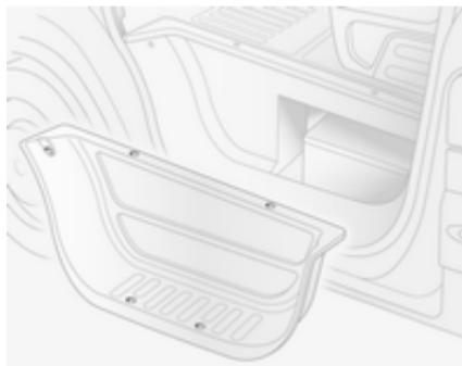
Akumulator se nahaja za pokravnim panelom stopnice sprednjih levih vrat. Za dostop do akumulatorja odstranite pokrveni panel.
