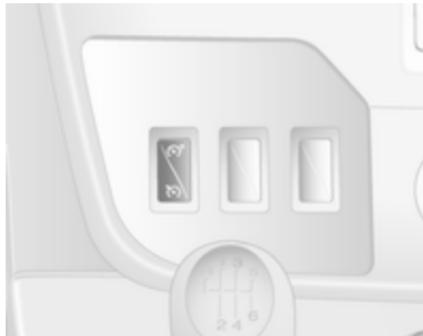
Pritisnite stikalo ⚪; na instrumentni plošči sveti indikator ⚡.
