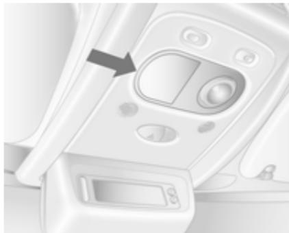
1. Zaslonko odstranite s ploskim izvijačem.
