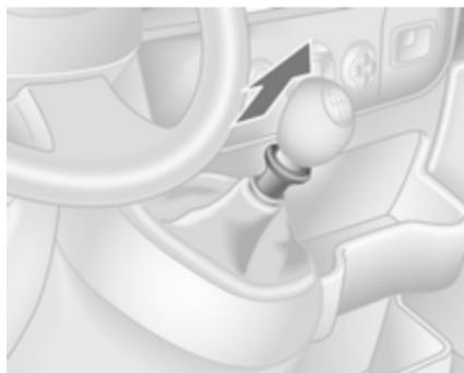
Vzvratno prestavo vklopite, ko vozilo miruje: pritisnite pedal sklopke, potegnjite navzgor vzvod na ročici in prestavite.
