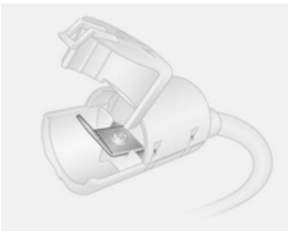
Če se akumulator vozila izprazni, uporabite kleme za zagon motorja v motornem prostoru, ki so dostopne na preprost način.
