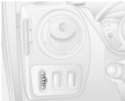
Pri vključenih kratkih lučeh nastavite višino žarometov glede na obtežbo vozila, da ne slepite nasproti vozečih.
