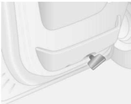
1. Luč iztaknite s ploskim izvijačem.
