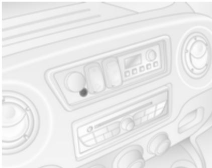
Med premikanjem električno pomicne stranske stopnice sveti kontrolna lučka. Če sveti tudi po tem, ko so vrata zaprta, se stopnica ni pomaknila navznoter. V tem primeru stransko stopnico pomaknite navznoter ročno, tako da povlečete sprostilni mehanizem, ki je vgrajen za stopnico. Poiščite strokovno pomoč v servisni delavnici.
