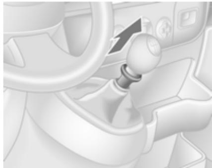
Vzvratna prestava: ko vozilo miruje, pritisnite pedal sklopke, potegnjte obroč navzgor in prestavite.
