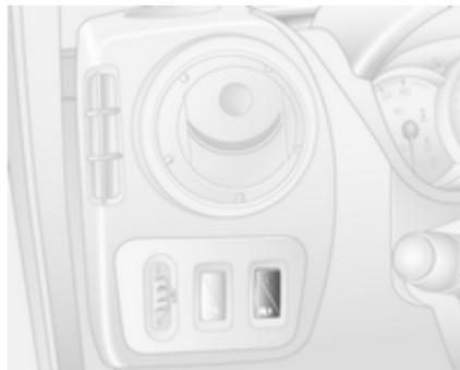
Po potrebi lahko v primeru, da so cestne površine mehke, pokrite z blatom ali snegom, izklopite ESP®<sup>Plus</sup>, da povečate oprijem: Pritisnite gumb
