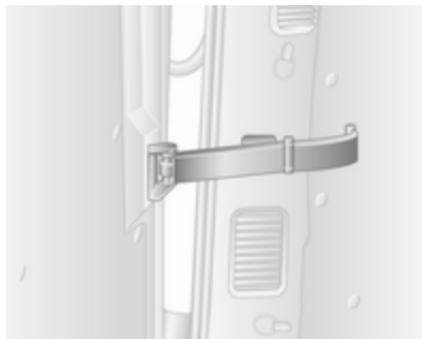
Če želite vrata odpreti do kota 180° ali dlje, sprostite omejevalnika in zaponke na ogrodju vrat in jih odprite do želenega položaja.
