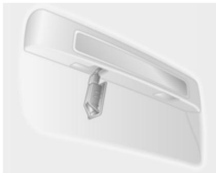
1. Zaslонko iztaknite s ploskim izvijačem.
