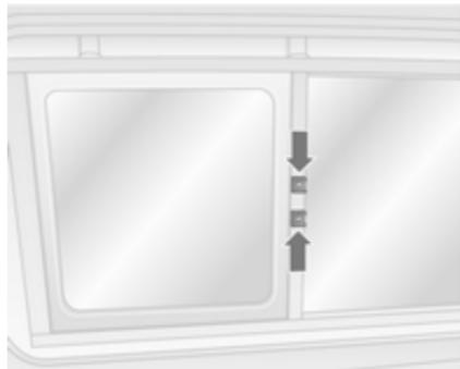
Za odpiranje pritisnite zatikalnik in potisnite okno Pri zapiranju se mora zatikalnik zaskočiti.
