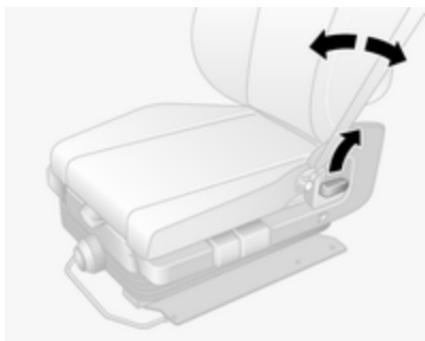
Potegnite vzvod, nastavite naklon in sprostite vzvod. Sedež naj se primerno zaskoči.
