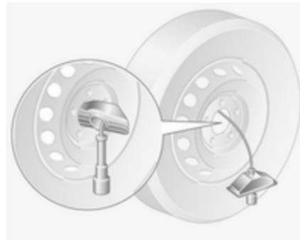
Postavite kolo pokonci, odstranite zatič iz nosilca in iztaknite kolo s kabla.
